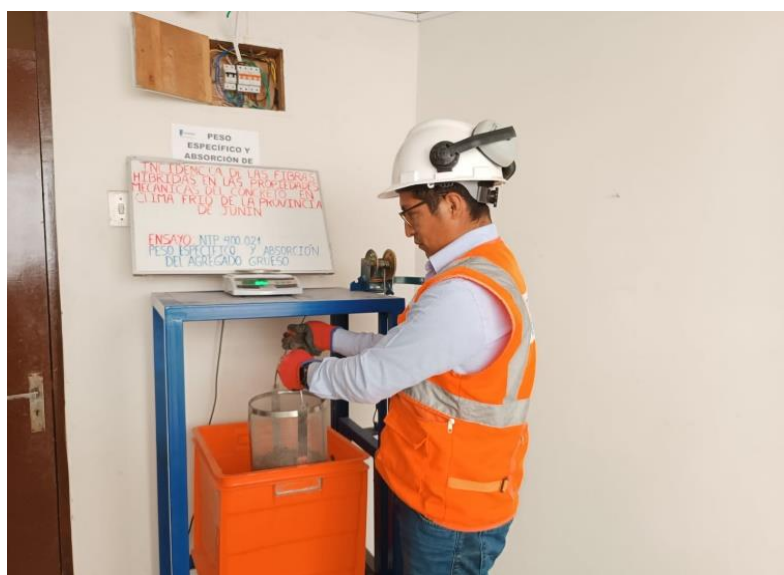
Figura 3.27. Peso de la muestra de agregado grueso sumergido según la norma NTP 400.021.
