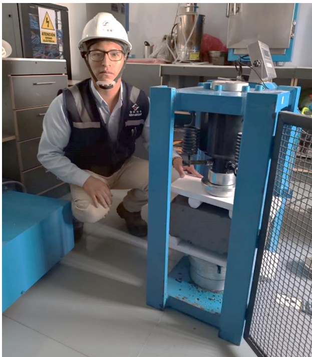
Figura 3.48. Ensayo de resistencia a flexión del espécimen reforzado con la fibra híbrida a edad de 28 días según la ASTM C78.
