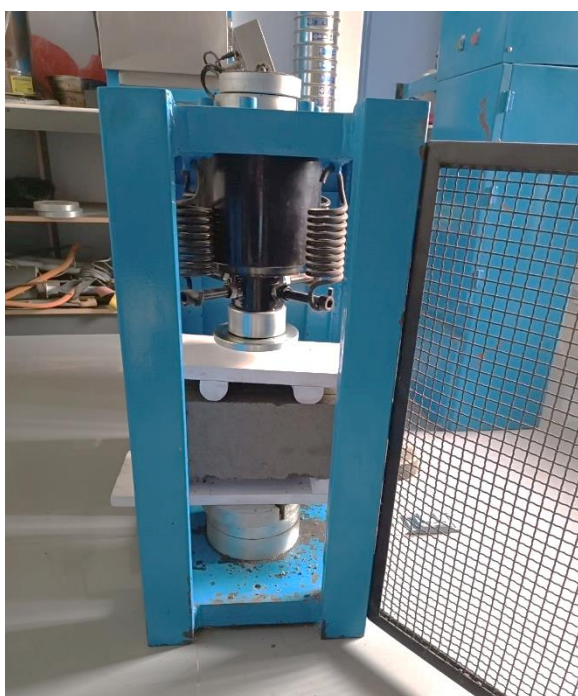
Figura 4.75. Ensayo a Resistencia a la flexión de la viga con carga en los tercios.
