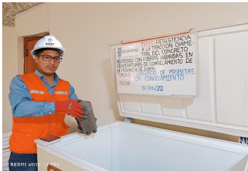
Figura 3.42. Colocación en la congeladora de las muestras de concreto reforzados con la adición de las fibras híbridas.
