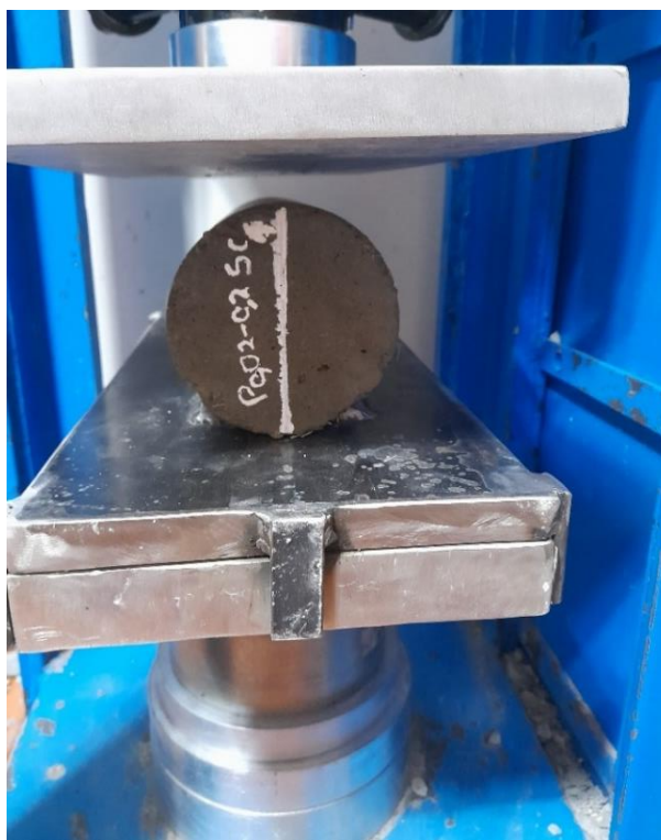
Figura 3.49. Ensayo a tracción diametral del espécimen reforzado según la NTP 339.084.
