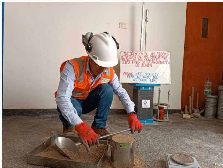
Figura 3.25. Enrasado de agregado fino según norma NTP 400.017.
