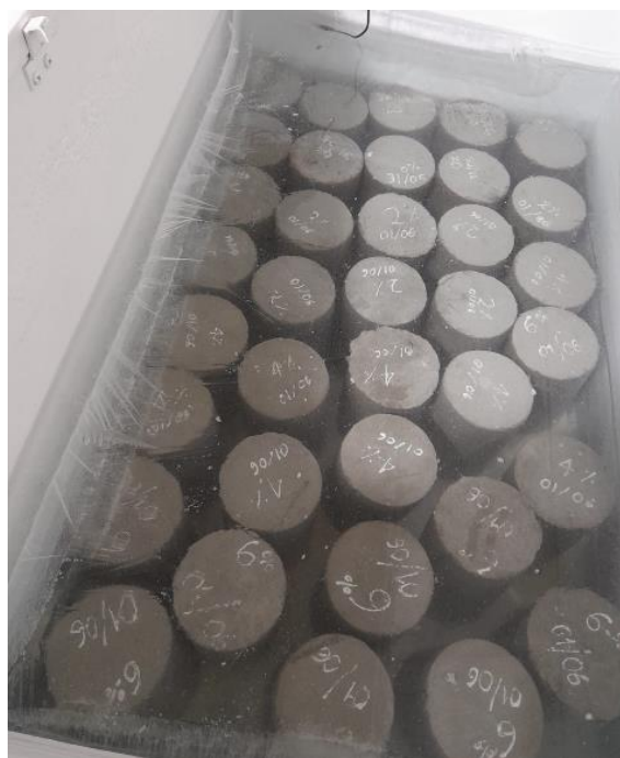
Figura 3.44. Especímenes cilíndricos reforzados con la fibra híbrida en curado en congelamiento a -5^{\circ}\text{C} .
