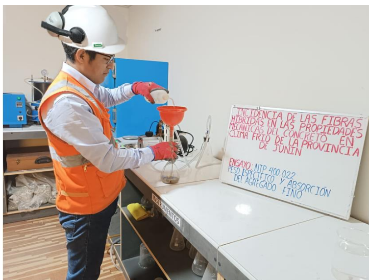
Figura 3.29. Ensayo de peso específico del agregado fino según la norma NTP 400.022.
