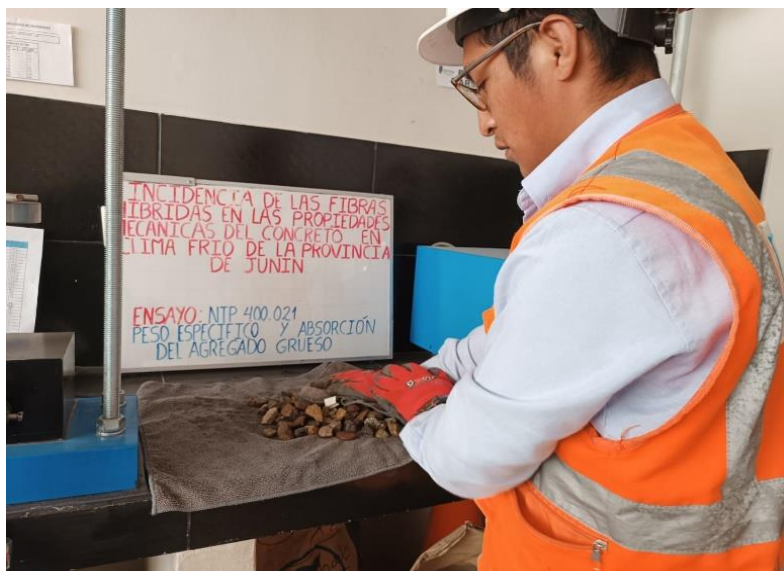
Figura 3.26. Secado del agregado grueso para el ensayo de absorción de agregados según la norma NTP 400.021.
