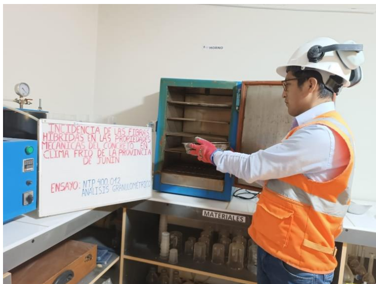
Figura 1.22. Secado del agregado grueso y fino según el procedimiento de la norma NTP 400.012.
