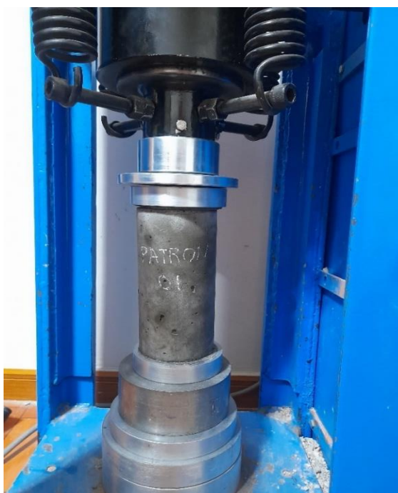
Figura 3.46. Ensayo a compresión de las muestras cilíndricas de concreto patrón a edad de 28 días según la NTP 339.034.
