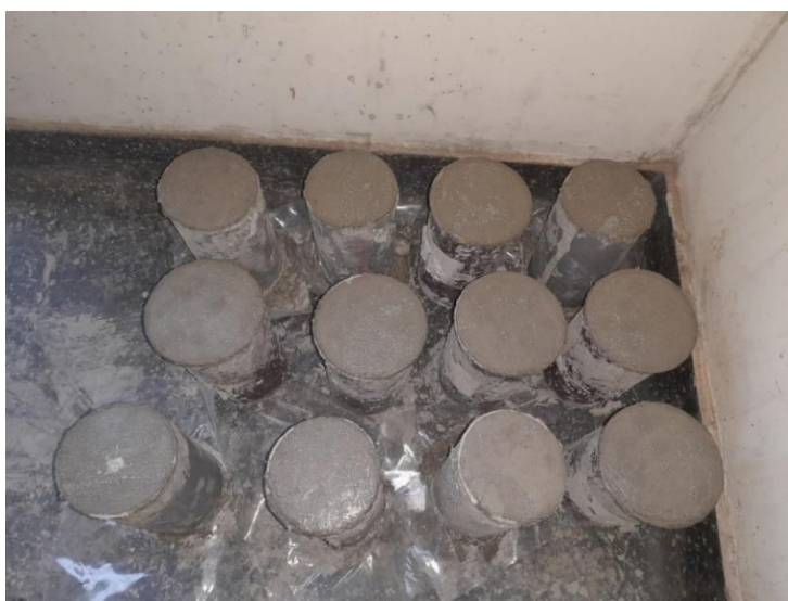
Figura 3.38. Elaboración de los especímenes de cilíndricos de concreto patrón según la norma NTP 339.023.
