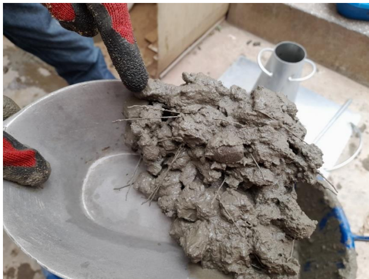
Figura 3.35. Presencia de las fibras híbridas en el concreto.
