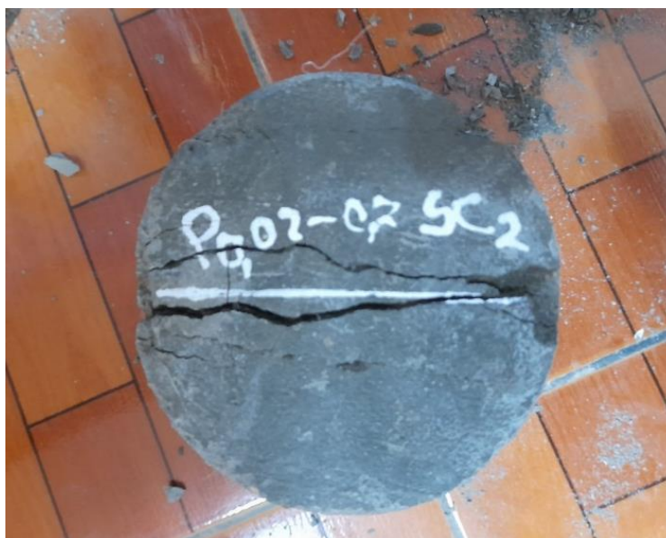
Figura 3.50. Falla después del ensayo a tracción diametral del espécimen reforzado con las fibras híbridas.
