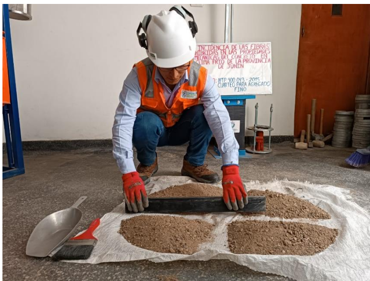
Figura 3.20. Cuarteo del Agregado Fino según la NTP 400.043.
