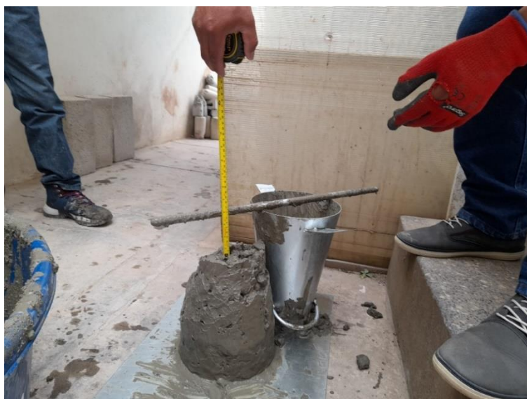
Figura 3.36. Asentamiento de la mezcla en fresco de acuerdo a procedimiento de la NTP 339.035.
