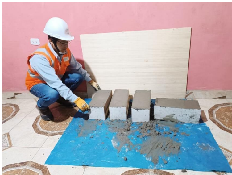
Figura 3.39. Elaboración de especímenes prismáticos de concreto con adición de las fibras híbridas.
