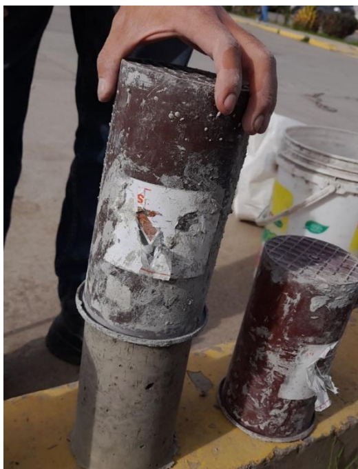
Figura 3.41. Desmoldado de especímenes de concreto patrón según la NTP 339.023.
