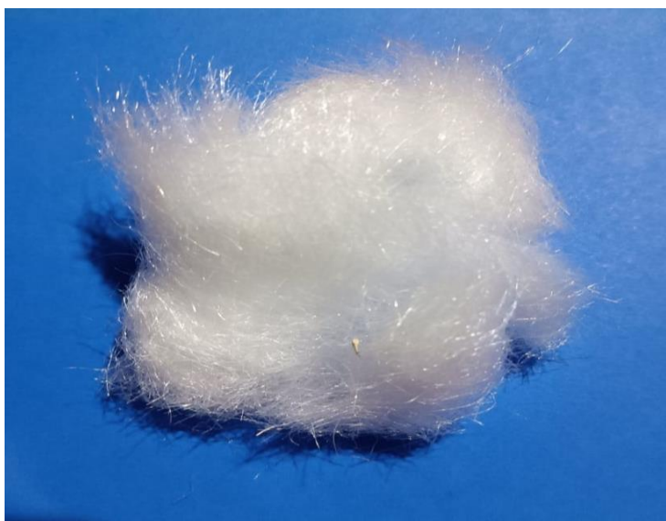
Figura 3.30. Presentación de la Fibra Z de polipropileno.
