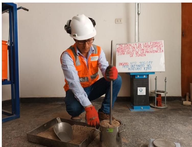
Figura 3.24. Apisonado de agregado fino según norma NTP 400.017.
