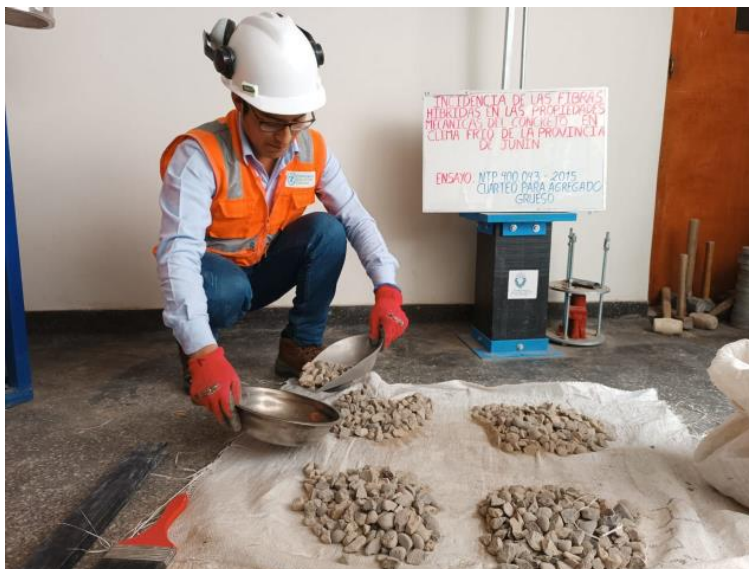
Figura 3.21. Cuarteo del Agregado Grueso según la NTP 400.043.
