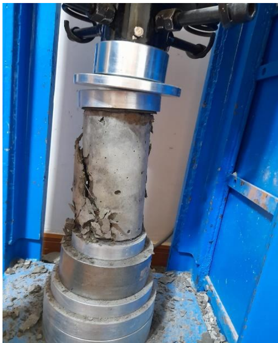
Figura 3.47. Rotura de las muestras de concreto con la adición de la fibra híbrida según el procedimiento de la NTP 339.034.
