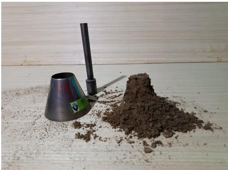
Figura 3.28. Arena en condición saturada superficialmente seca realizada según norma NTP 400.022.
