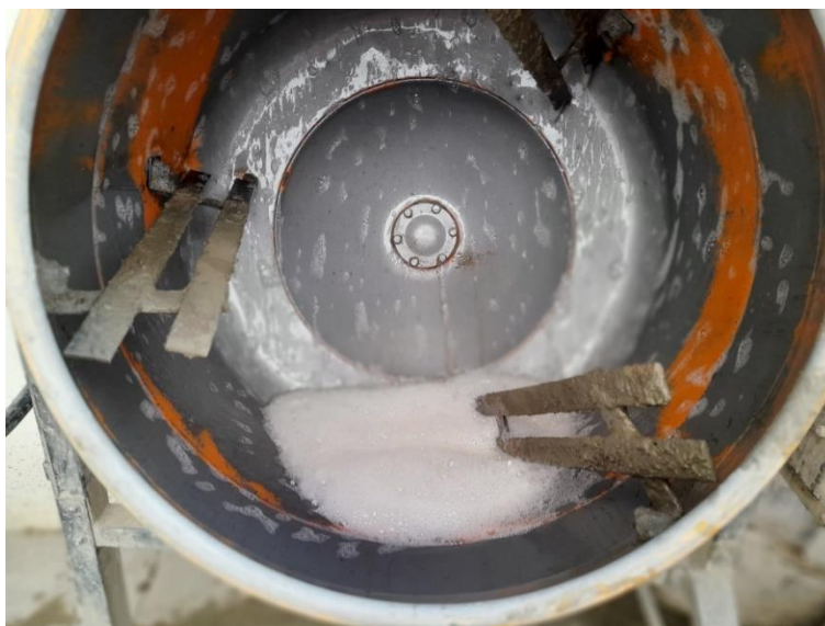
Figura 3.33. Adición de la fibra híbrida en dosificación de 0.2% de fibra de acero + 0.02% de fibra de polipropileno.
