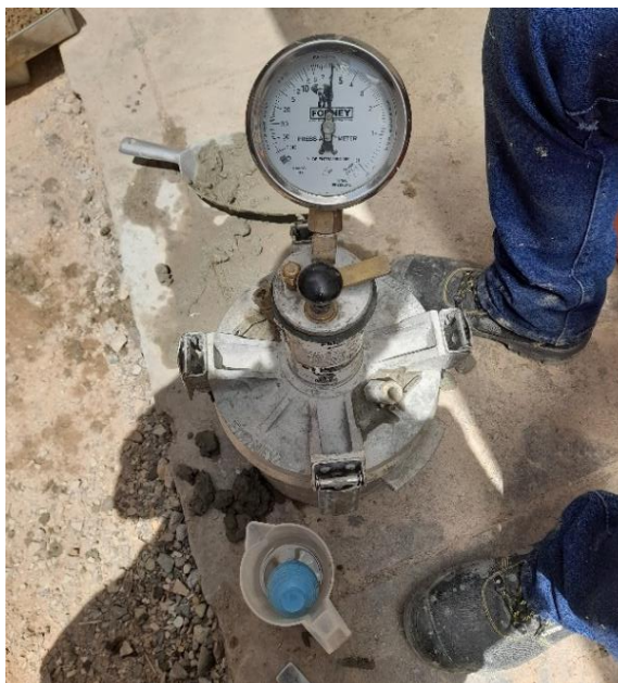
Figura 3.37. Obtención del contenido de aire según la 339.080.
