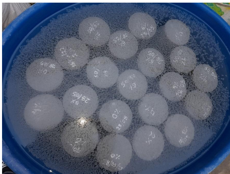
Figura 3.45. Especímenes cilíndricos reforzados con la adición de la fibra híbrida en curado en convencional.
