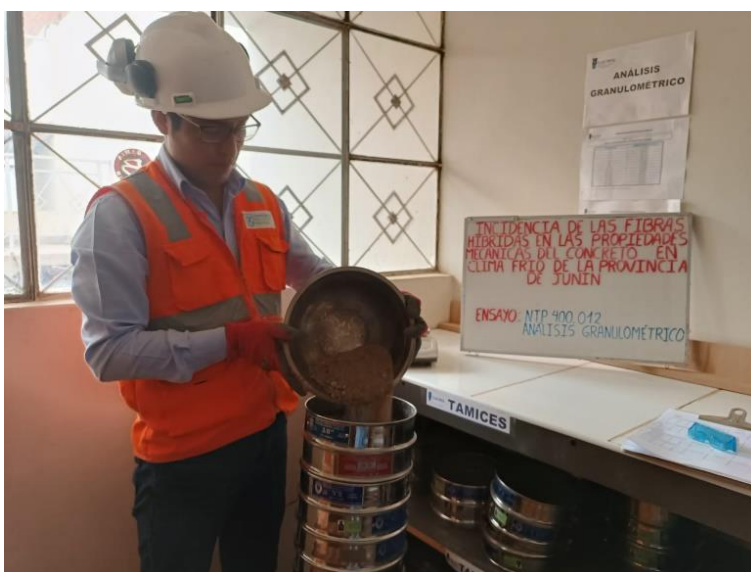
Figura 1.23. Tamizado del agregado fino según la norma NTP 400.012.
