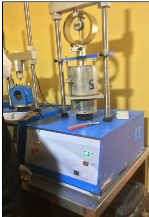
Fotografía N° 20: Ensayo para la determinación de un índice de resistencia del suelo, Lectura de penetración en el dial, 0.025" a 0.500" de material convencional y material con adiciones, MTC E 132.
