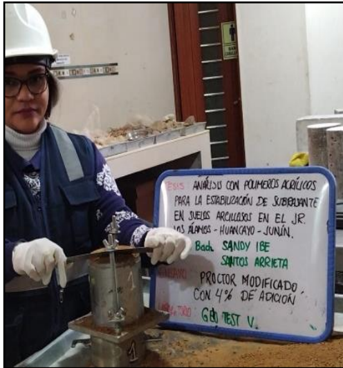
Fotografía N° 13: Enrasado del material compactado con adición de 4% de polímero acrílico dentro del molde en 5 capas, con 56 golpes, norma MTC E 115. Fuente: Elaboración por (Santos Arrieta).
