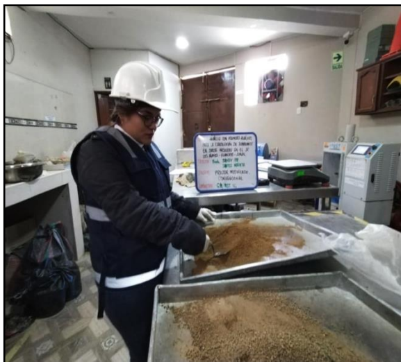
Fotografía N° 16: Preparación de los materiales para el ensayo dentro del molde en 5 capas, en un molde con 56 golpes, en el segundo molde por 25 golpes y en el tercer molde 12 golpes, según referencia de la norma MTC E 132.
