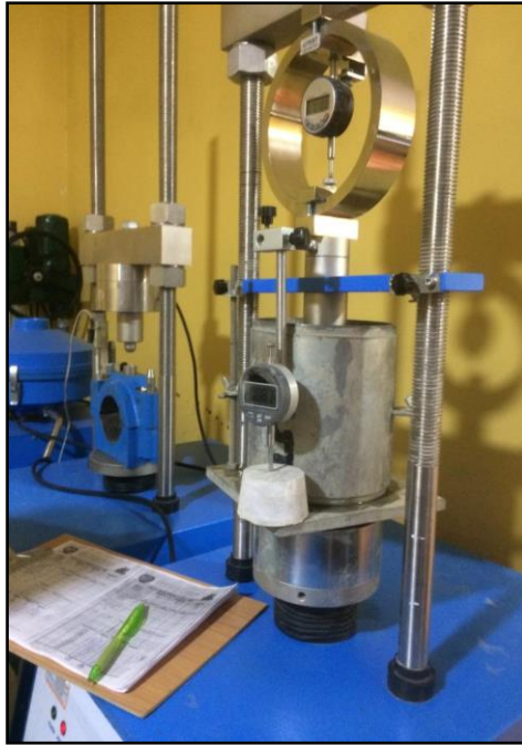
Fotografía N° 19: Ensayo para la determinación de un índice de resistencia del suelo, Lectura de penetración en el dial, 0.025" a 0.500" de material convencional y material con adiciones, MTC E 132.
