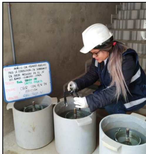
Fotografía N°17: Saturación de moldes compactados para la futura expansión del material; según indica la norma MTC E 132.
