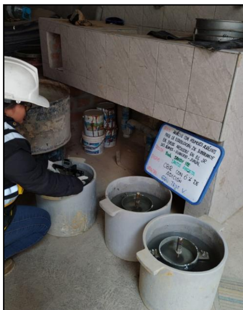
Fotografía N° 18: Sumergido de moldes por 96 horas midiendo la expansión cada 24 hs, norma MTC E.132.
