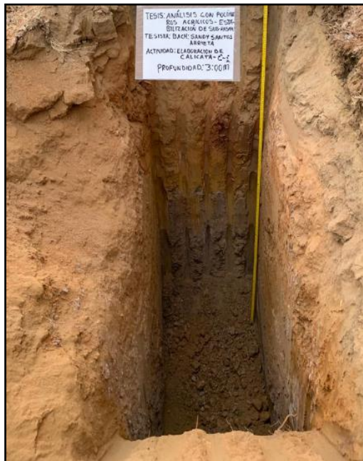
Fotografía N° 1: Exploración de calicata C-1 Fuente: Elaboración por (Santos Arrieta).
