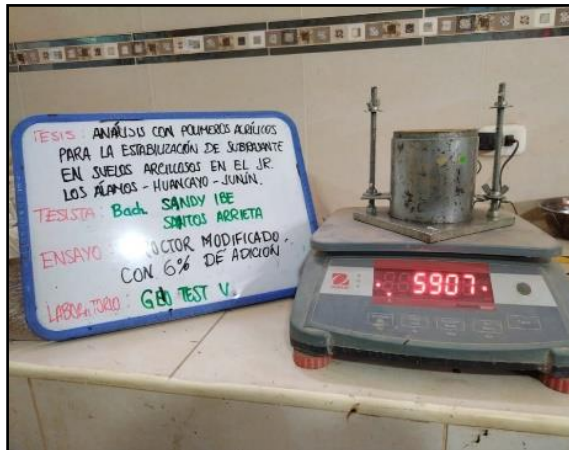
Fotografía N° 15: Medida del 6% del polímero acrílico; para ensayo de Proctor modificado según referencia de la norma MTC E 115. Fuente: Elaboración por (Santos Arrieta).
