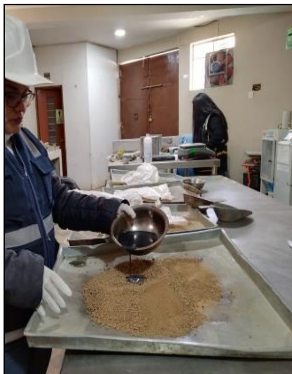
Fotografía N° 12: Preparación de la mezcla en un 4% a base de polímero acrílico, Norma MTC E.115. Fuente: Elaboración por (Santos Arrieta).
