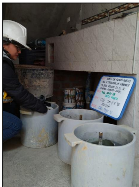
Fotografía N° 19: Lectura de la expansión del material hasta su máxima dilatación con los días por cada 24 hs, norma MTC E.132.
