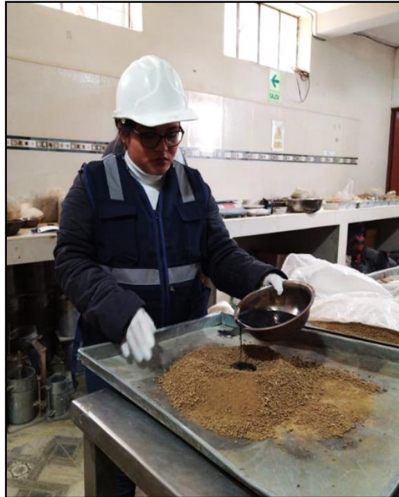
Fotografía N° 11: Combinación del material con la mezcla del 2% de polímero acrílico para realizar ensayo de Proctor modificado; referencia norma MTC E 115. Fuente: Elaboración por (Santos Arrieta).
