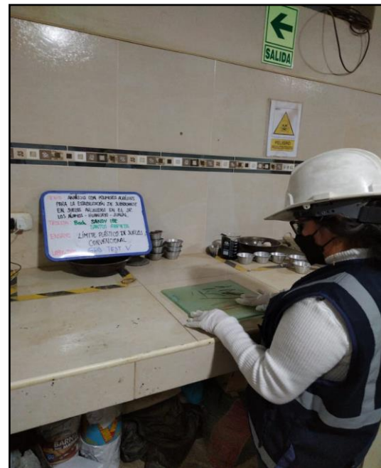
Fotografía N° 8: Ensayo de LP, MTC E 111.
