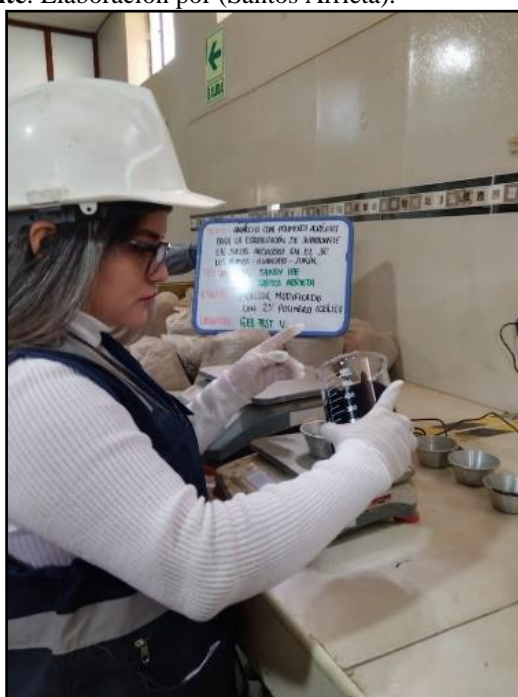
Fotografía N° 10: Medida de la preparación en una cantidad referente a la masa del material para adición de distintos 2%, 4% y 6% del polímero de acrílico; referencia norma MTC E. 115.
