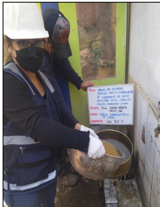
Fotografía N° 5: Ensayo del material pasante el tamiz N° 200, según MTC E. 202.
