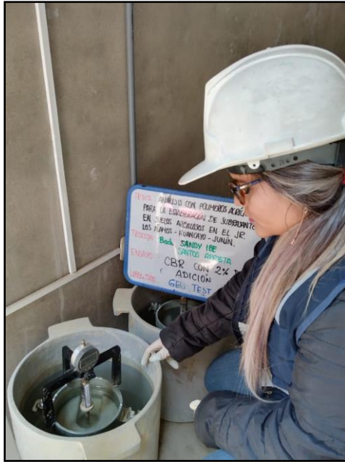
Fotografía N° 20: Sumergido de los moldes por 96 hs midiendo la expansión cada 24 hs con adición del 2% y 6% de polímero acrílico, norma MTC E 132. Fuente: Elaboración por (Santos Arrieta).
