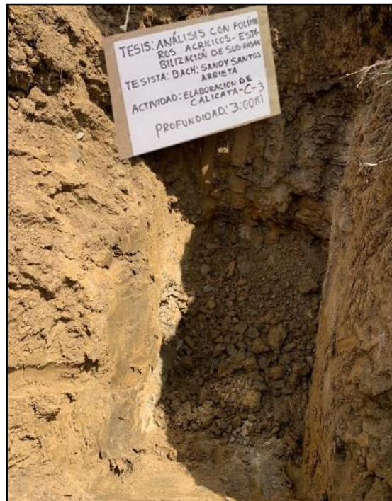
Fotografía N° 3: Exploración de calicata C-3. Fuente: Elaboración por (Santos Arrieta).
