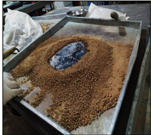
Fotografía N° 14: Preparación de la mezcla en un 6% a base de polímero acrílico para la investigación correspondiente, según referencia de la norma MTC E 115.
