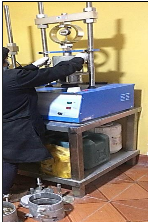
Fotografía N° 20: Ensayo para la determinación de un índice de resistencia del suelo, Lectura de penetración en el dial, 0.025" a 0.500" convencional, MTC E .132. Fuente: Elaboración por (Santos Arrieta).
