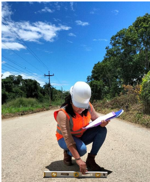
Figura 4.7 Identificación y registro de fallas en las fichas control
