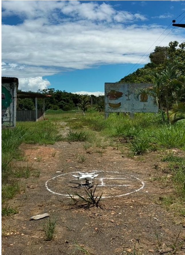
Fotografía N°06: Colocación de dron, para inicio de levantamiento.
