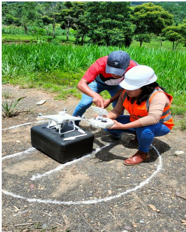
Fotografía N°07: Verificación de señal y conexión entre el control remoto del dron y la antena RTK.
