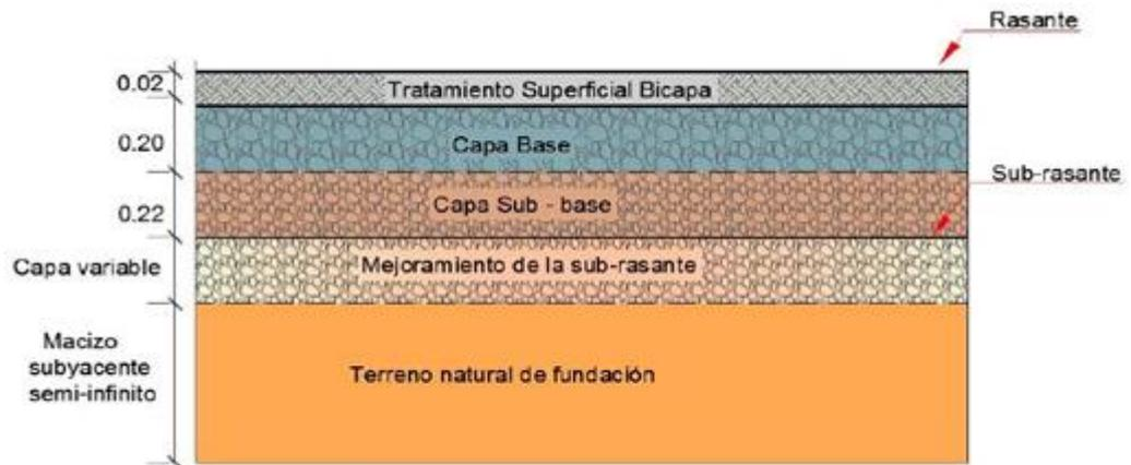
Figura 4. Sección transversal de un pavimento flexible.
