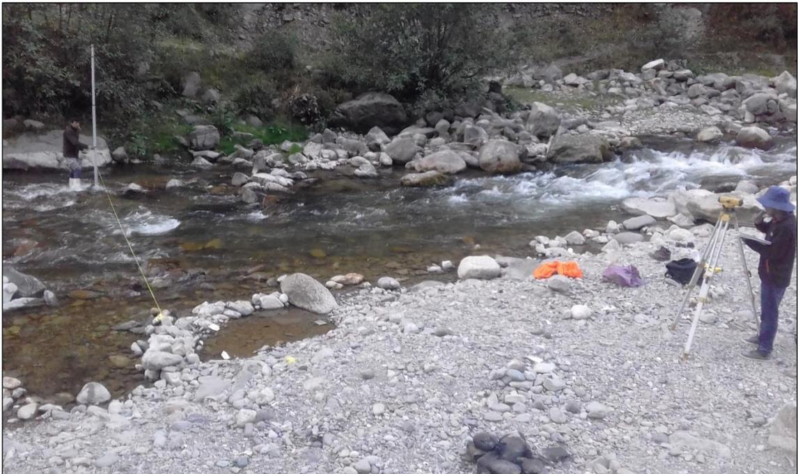
Fotografía 4. Nivelación y seccionamiento de río, en el punto de aforo.
