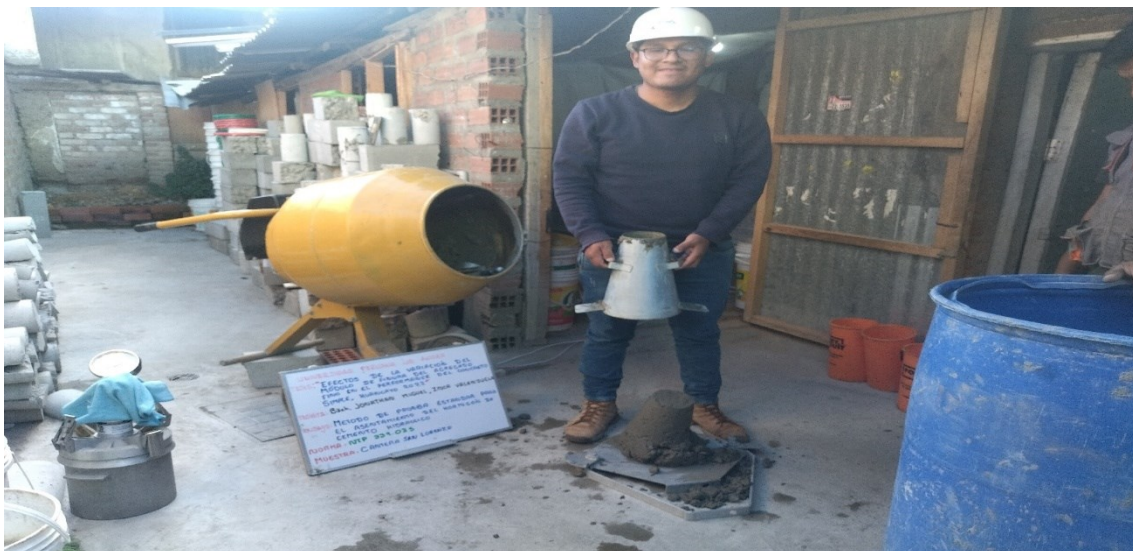
Fotografía 8. Ensayo de asentamiento de concreto con agregado fino de cantera San Lorenzo.
