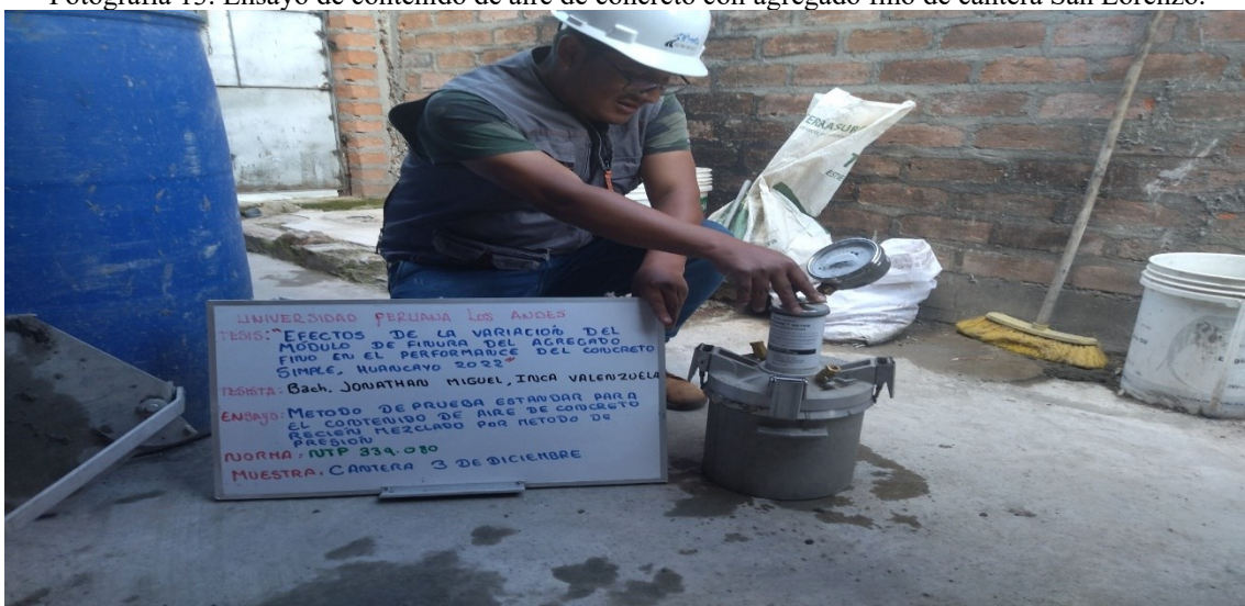
Fotografía 14. Ensayo de contenido de aire de concreto con agregado fino de cantera 3 de Diciembre.
