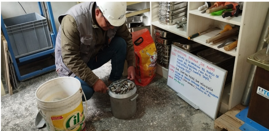
Fotografía 6. Ensayo de peso unitario del agregado grueso.
