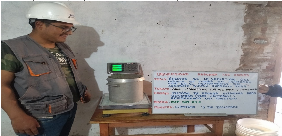
Fotografía 10. Ensayo de peso unitario de concreto con agregado fino de cantera 3 de Diciembre.
