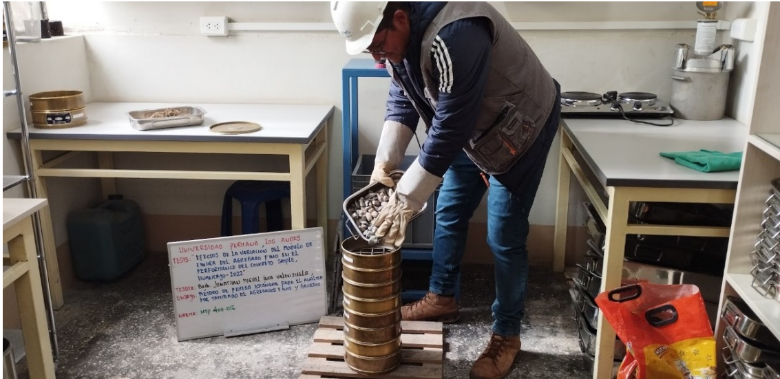
Fotografía 5. Ensayo de granulometría del agregado grueso.
