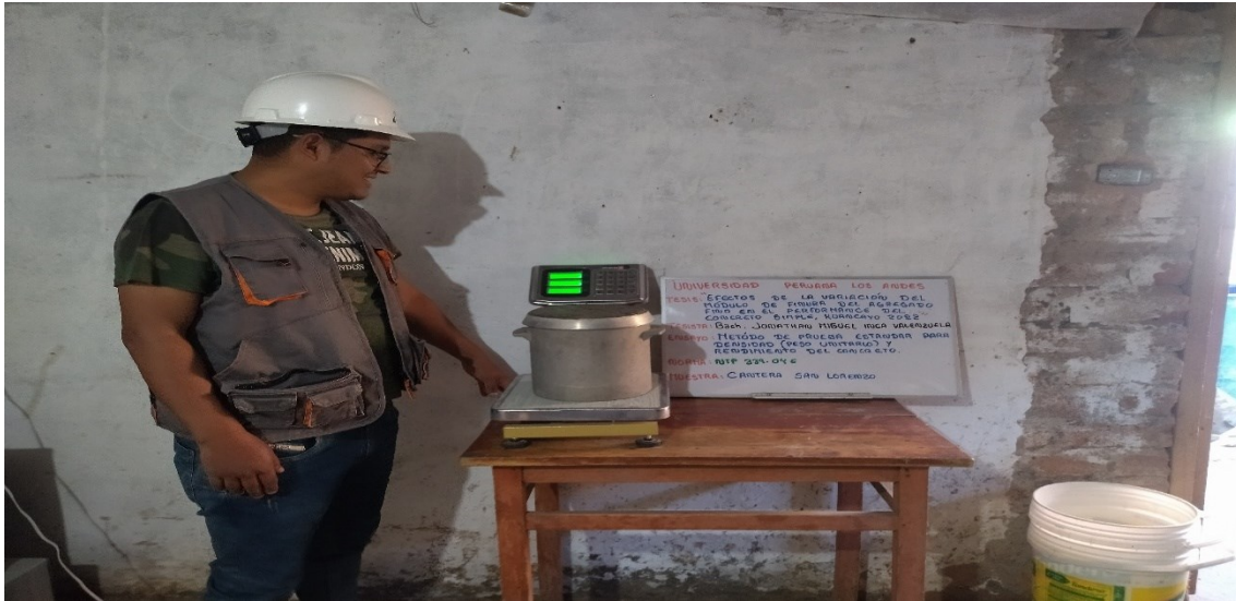
Fotografía 9. Ensayo de peso unitario de concreto con agregado fino de cantera San Lorenzo.
