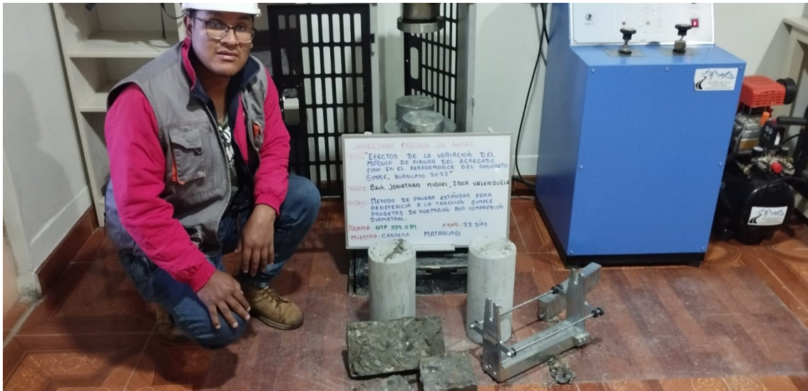
Fotografía 22. Ensayo de resistencia a tracción a 28 días del concreto con agregado fino de la cantera Matahuasi.
