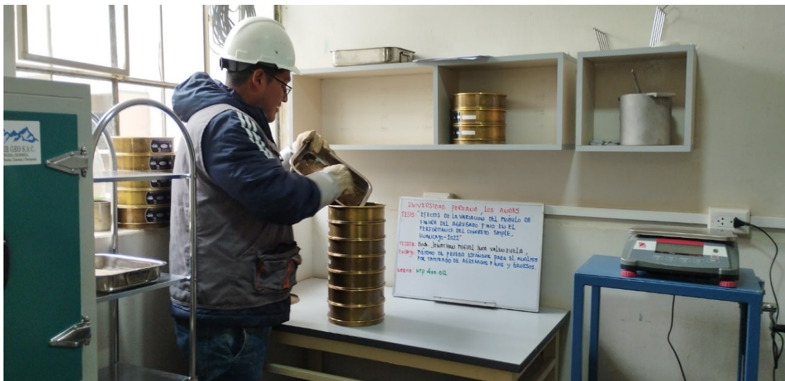
Fotografía 2. Ensayo de granulometría del agregado fino.
