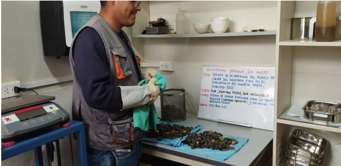
Fotografía 7. Ensayo de gravedad específica del agregado grueso.
