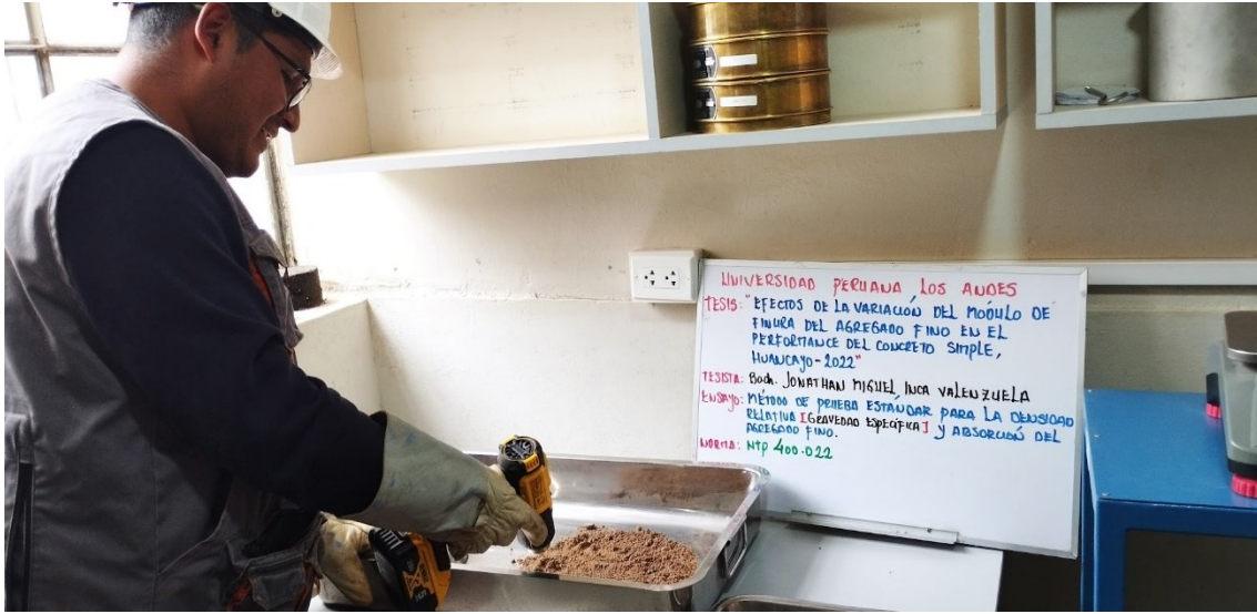
Fotografía 3. Ensayo de gravedad específica del agregado fino.
