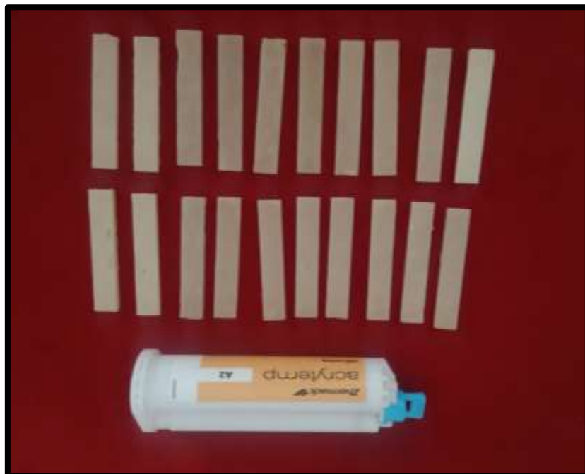
Especímenes de Resinas bis acrílicas Protemp 4™ (PT4, 3M ESPE) y Acrytem® (Zhermack)
