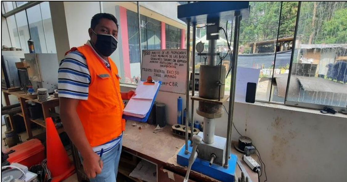
Fotografía 6. Prueba en prensa CBR.
