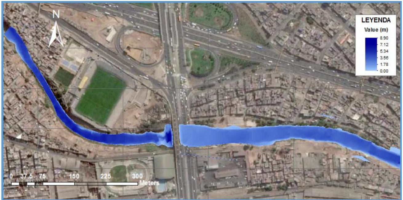
Figura 30 Simulación de inundación para periodo de retorno de 50 años - Flujo no permanente
