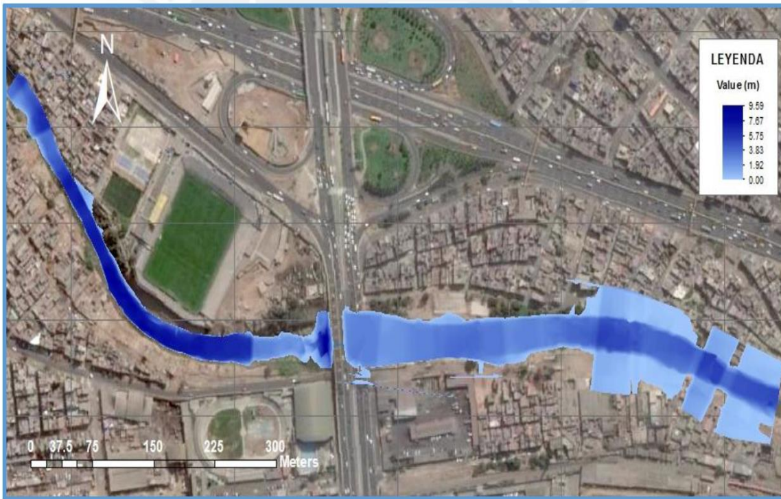
Figura 20 Simulación de inundación para periodo de retorno de 500 años - Flujo permanente
