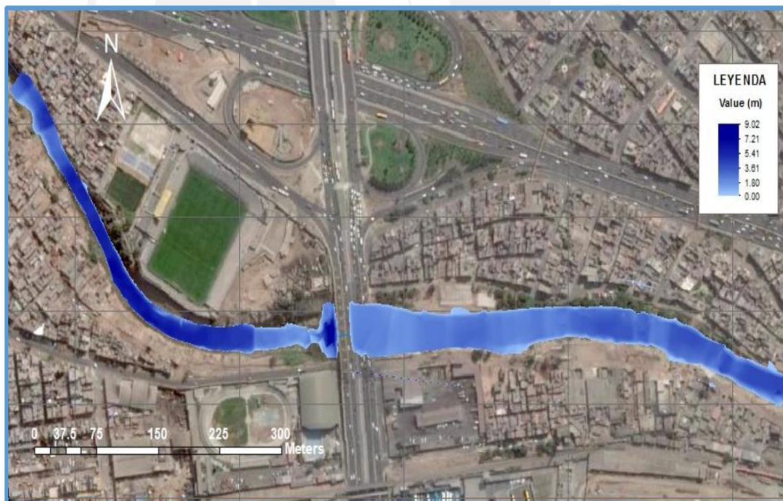
Figura 18 Simulación de inundación para periodo de retorno de 50 años - Flujo permanente
