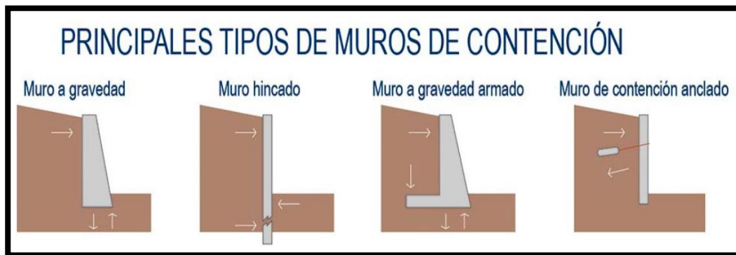
Figura 1 Tipos de muros de contención
