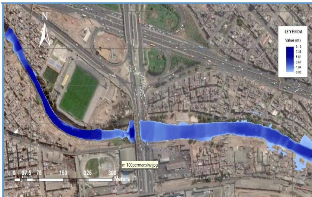
Figura 19 Simulación de inundación para periodo de retorno de 100 años - Flujo permanente
