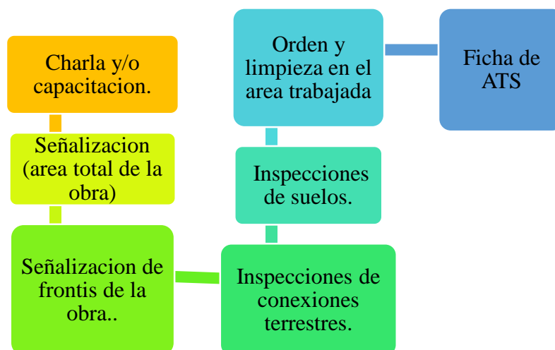
Figura 60. Secuencia de seguridad previa al trazo y replanteo.
