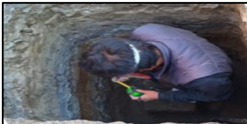
Fotografía 8: Perfil de suelo cohesivo analizado
