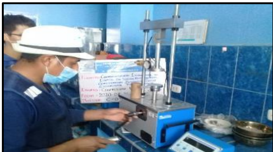
Fotografía 11: Ensayo de compresión no confinada - suelos cohesivos
