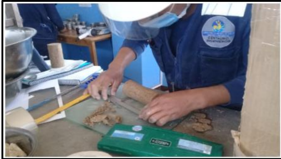
Fotografía 5: Ensayo de Compresión No Confinada - Extracción espécimen
