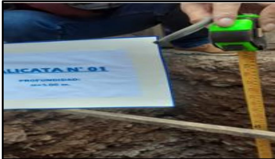
Fotografía 9: Profundidad excavada P=Df+1.5B = 3.00 \text{ m}
