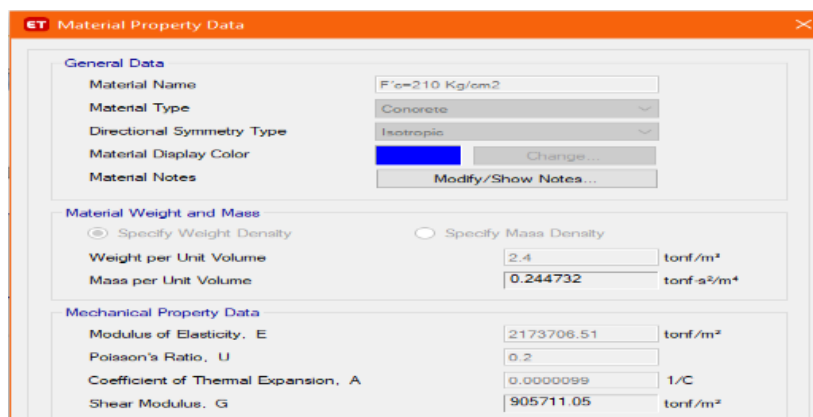
Figura 61: Definición del componente cimentación
