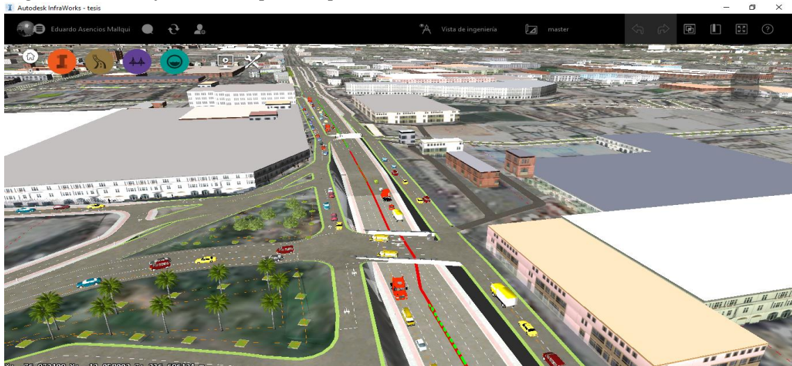
Figura 69. Vista frontal con paso deprimido
