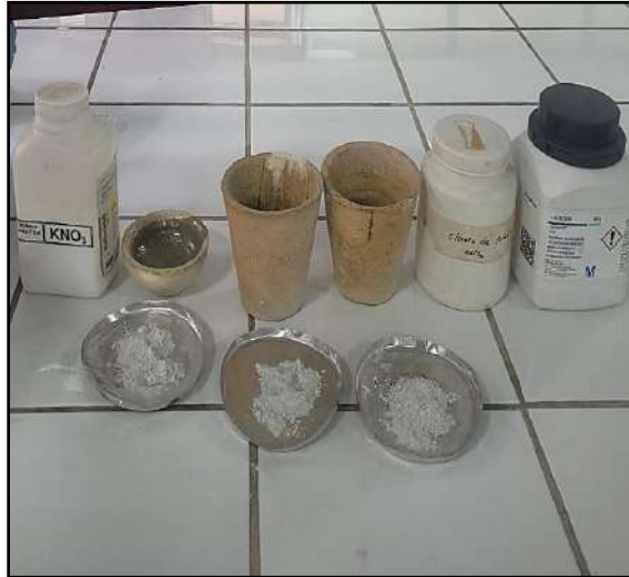
Figura 4.13 Preparación de la ceniza con los reactivos para el ataque químico
