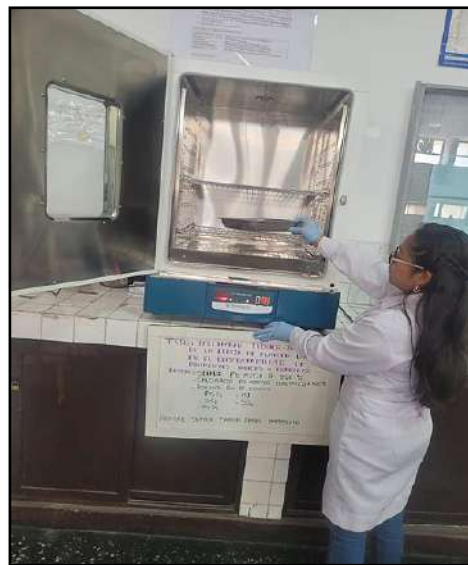
Figura 4.12 Proceso de calcinación en el horno mufla
