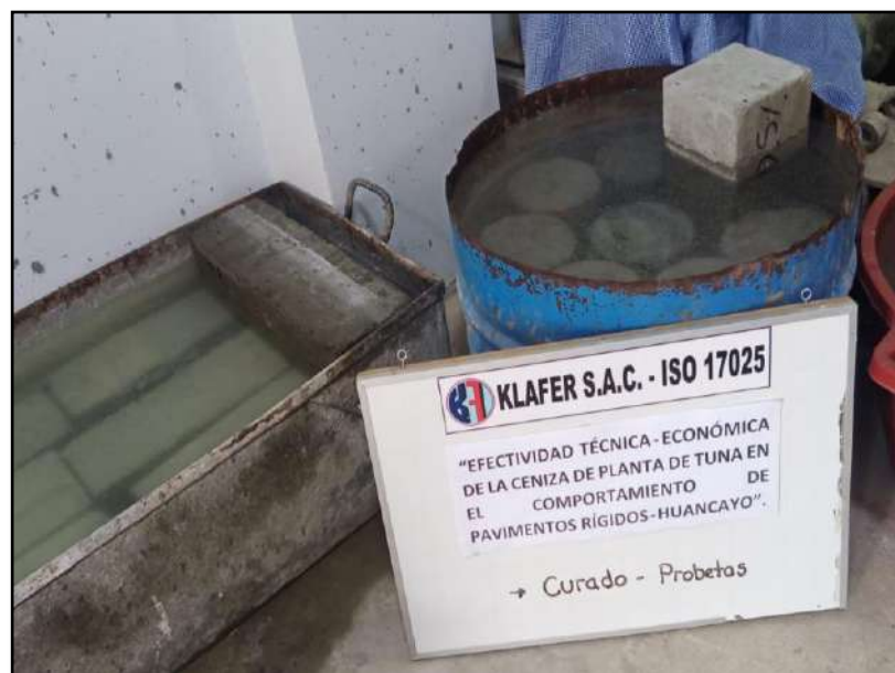
Fotografía 8: Poza de curado de probetas y vigas.
