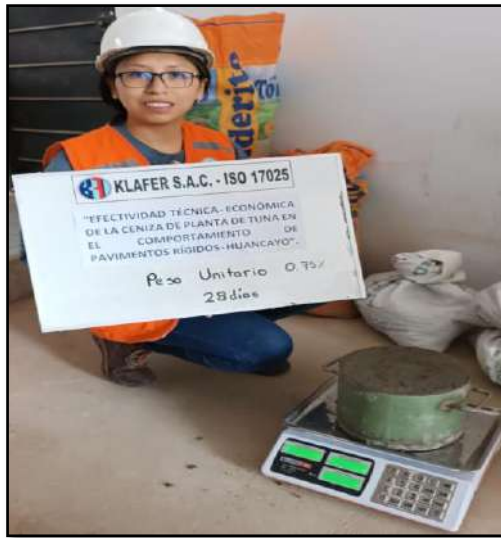
Figura 4.19 Ensayo de peso unitario del concreto fresco
