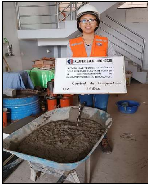
Figura 4.17 Ensayo de control de temperatura de la mezcla
