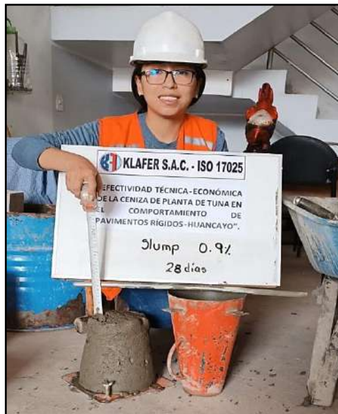
Figura 4.18 Ensayo de asentamiento del concreto fresco
