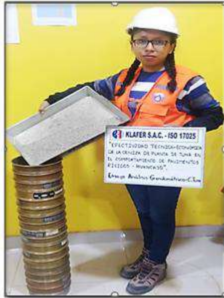
Figura 5.22 Análisis granulométrico de la ceniza de planta de tuna
