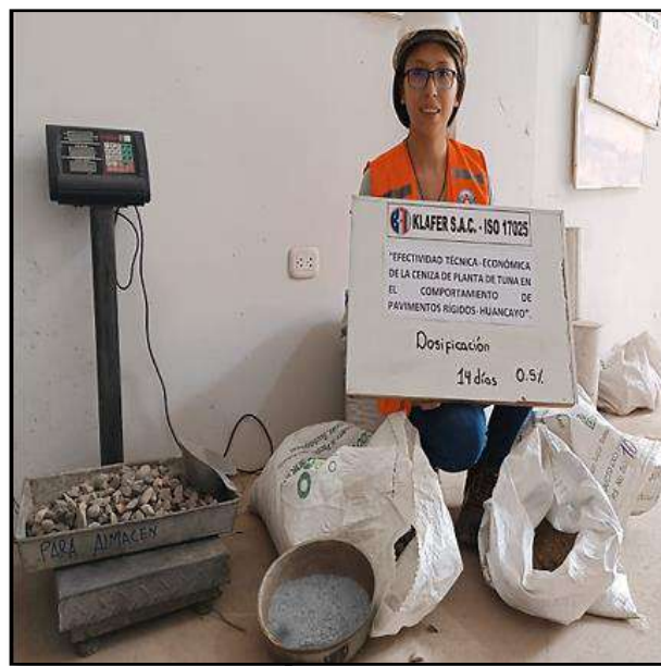
Figura 4.16 Dosificación de agregados, cemento y ceniza de planta de tuna.
