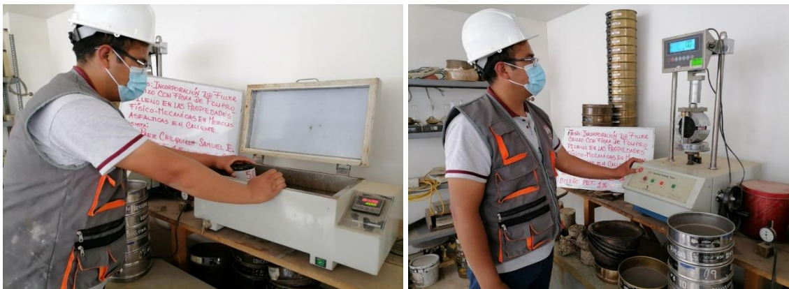
Fotografía 3: El ensayo de los especímenes en el baño maría es usado para el calentamiento de una temperatura constante de 60 °C, según la referencia de la norma ASTM D 6927. Prueba de estabilidad y flujo Marshall cubre las mediciones de la resistencia de la mezcla.
