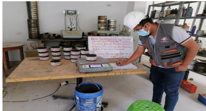
Fotografía 2: Masa al aire de espécimen, para determinación de peso específico Bulk, según la referencia de la norma ASTM D 1188-07.
