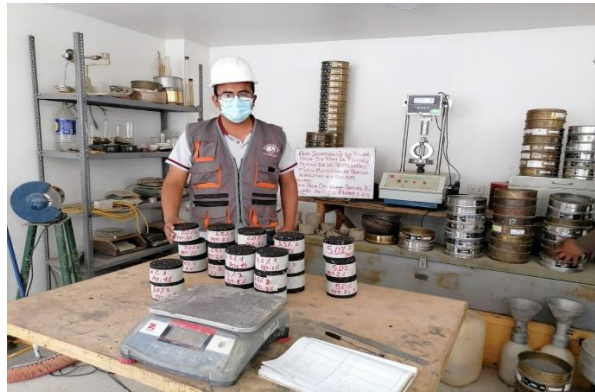
Fotografía 1: Elaboración de especímenes, a temperatura a 110°C de mezcla para producir una viscosidad de 280° +/- 30° en la emulsión asfáltica a usarse.
