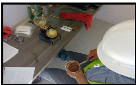
Imagen 4: Ensayo para determinar el límite líquido. Compactación de suelos en laboratorio utilizando una energía modificada MTC EM 115 (Proctor modificado)
