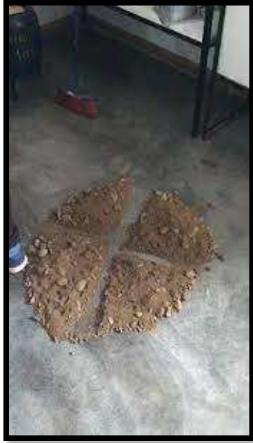
Imagen 7: CBR con poliestireno extruido. Fuente: Propio de la investigación en desarrollo.
