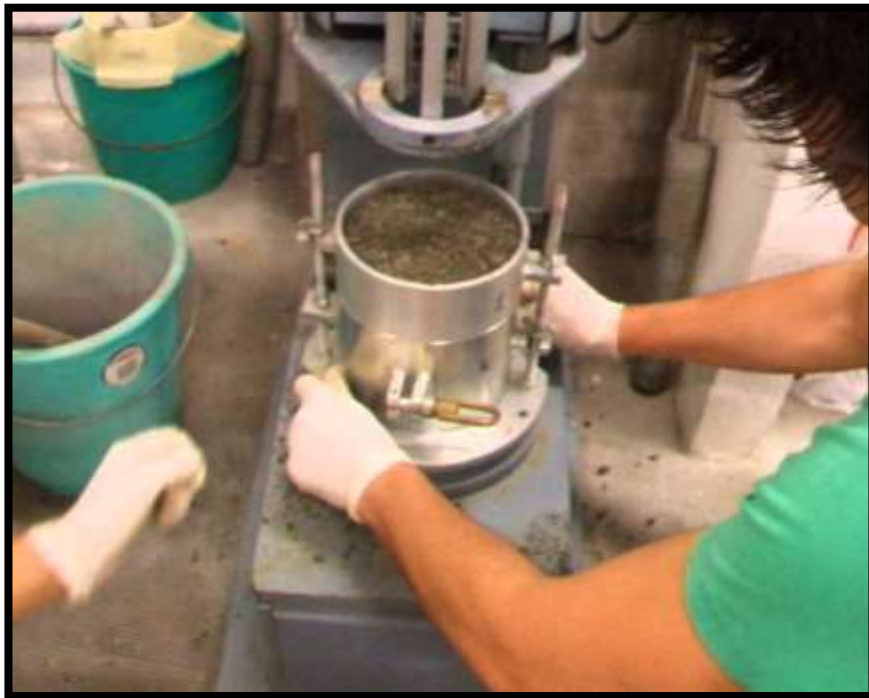
Imagen 8: Penetración de la muestra. Fuente: Propia de la investigación en desarrollo
