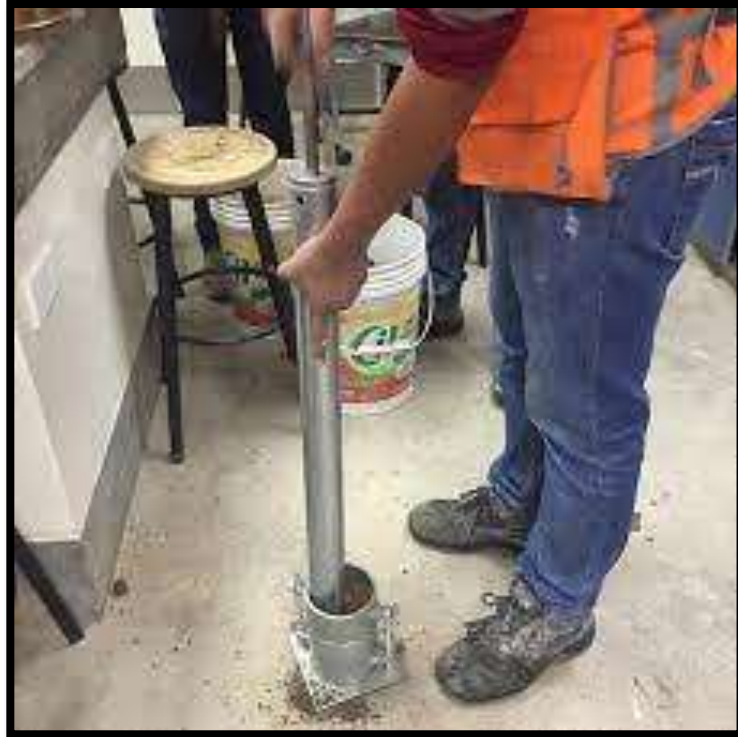
Imagen 5: Compactación de material de calicata
