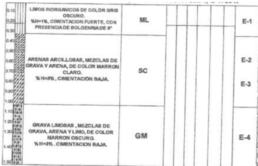
Figura 2: Registro de excavación de la calicata C-2
