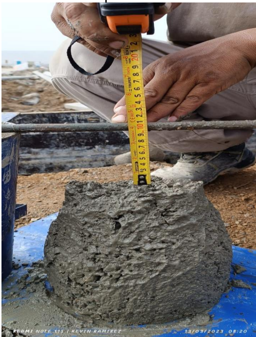
Prueba de asentamiento con cono de Abrams.
