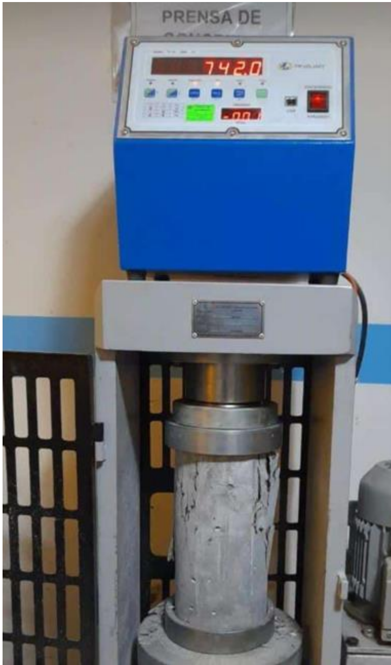
Ensayos de resistencia a compresión del concreto
