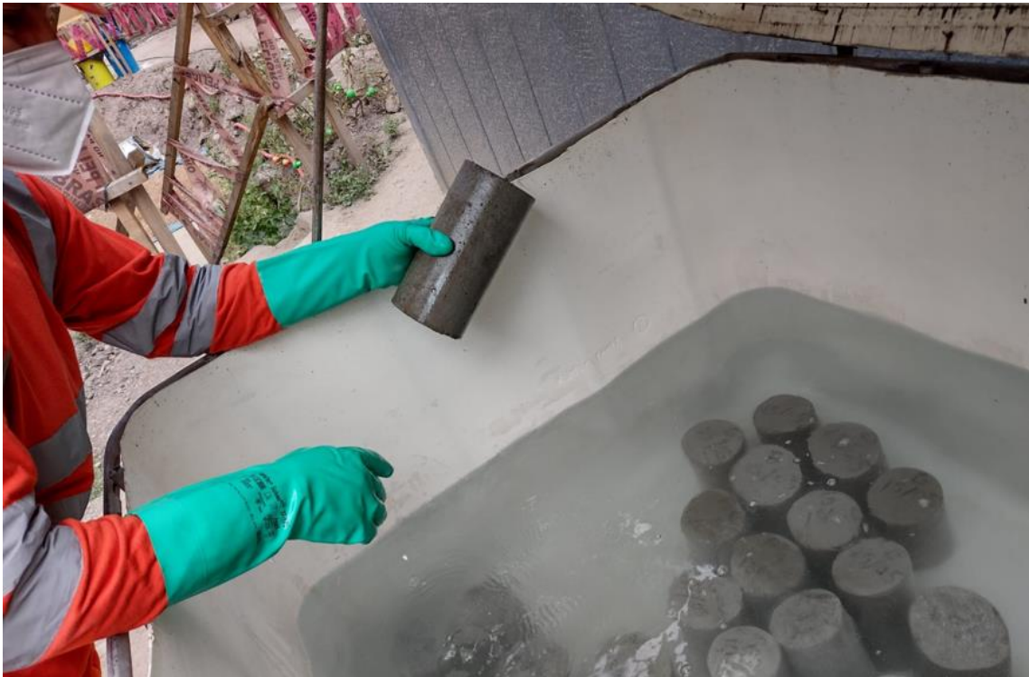
Curado de las probetas cilíndricas de concreto
