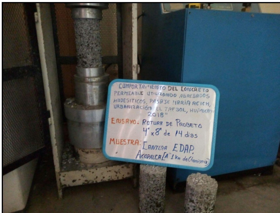
Imagen N° 16 Ensayo de rotura de probeta a los 14 y 28 días, para analizar la resistencia al a compresión. ASTM C-39/C39M-12.
