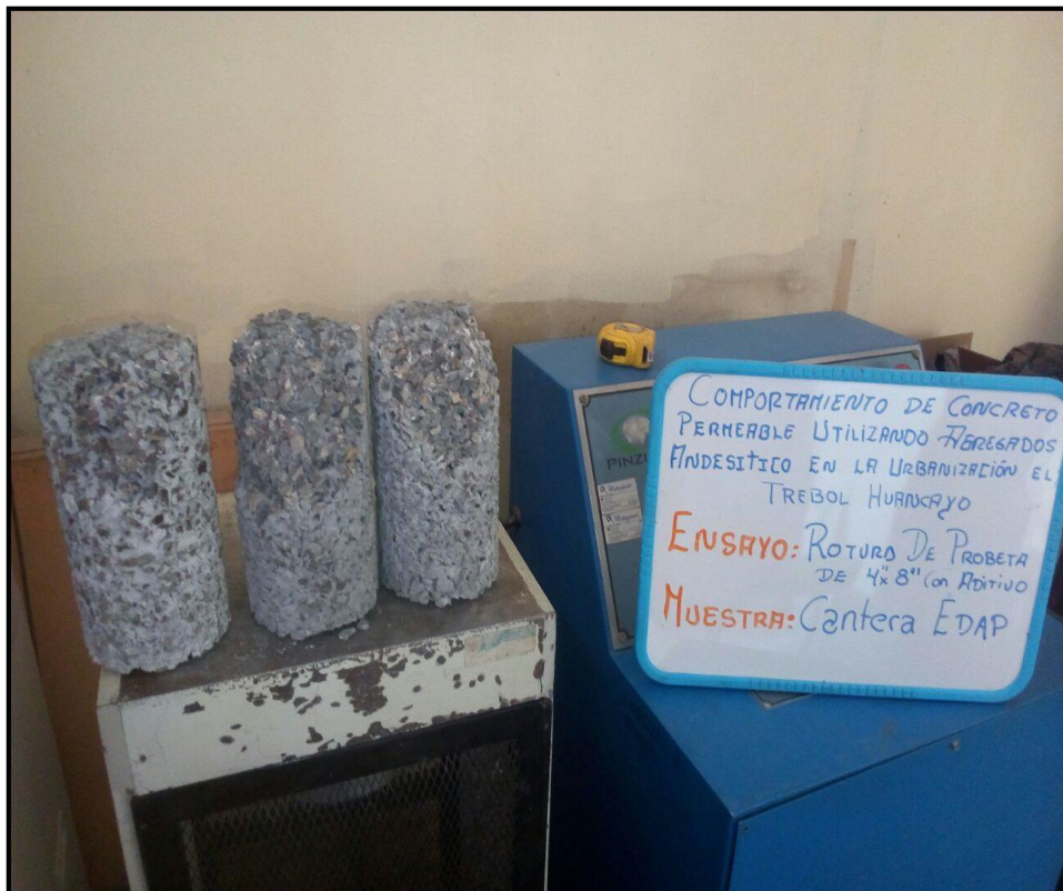
Imagen N° 14 Probetas de concreto permeable de 4X8" con aditivo de la cantera EDAP (agregado andesítico).
