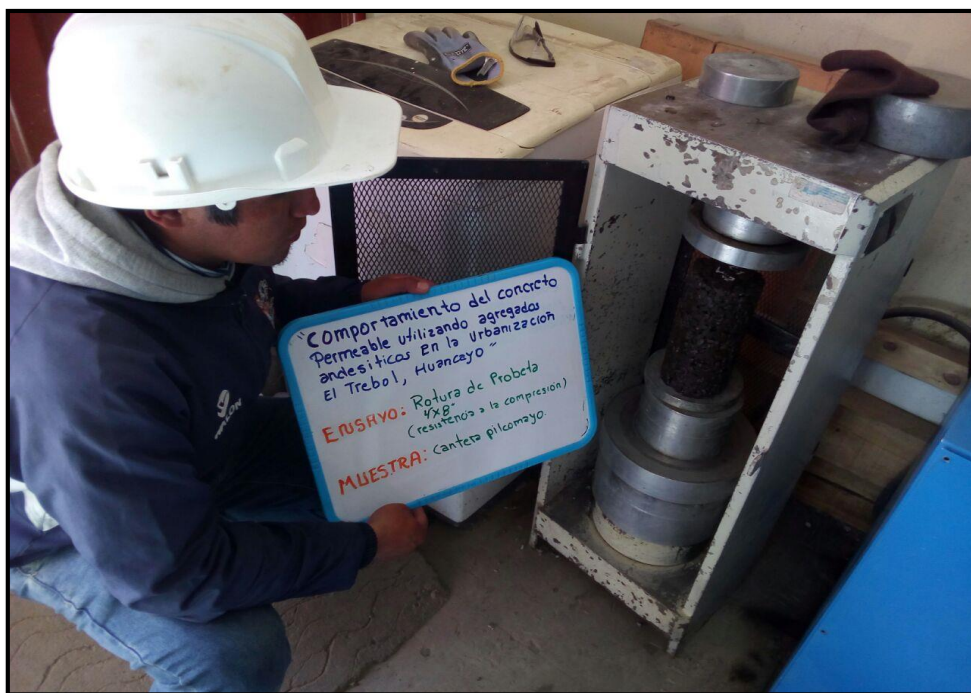
Imagen N° 11 Resistencia a la compresión ASTM C-39/C39M-12
