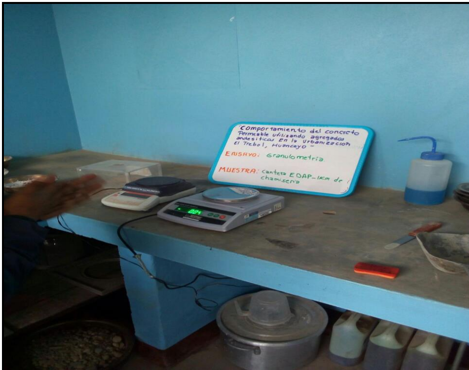
Imagen N° 4 Ensayo de granulometría del agregado de la cantera EDAP NTP 400.037.
