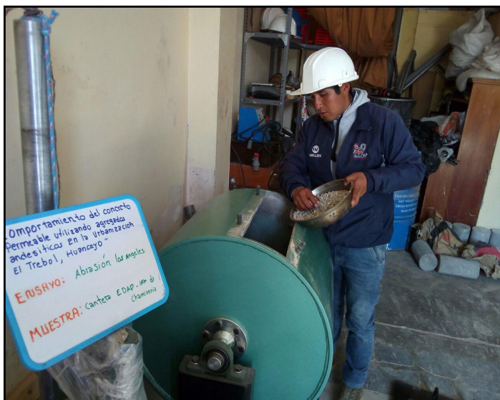
Imagen N° 6 Abrasión de los ángeles MTC E-207-2016, ASTM C-31
