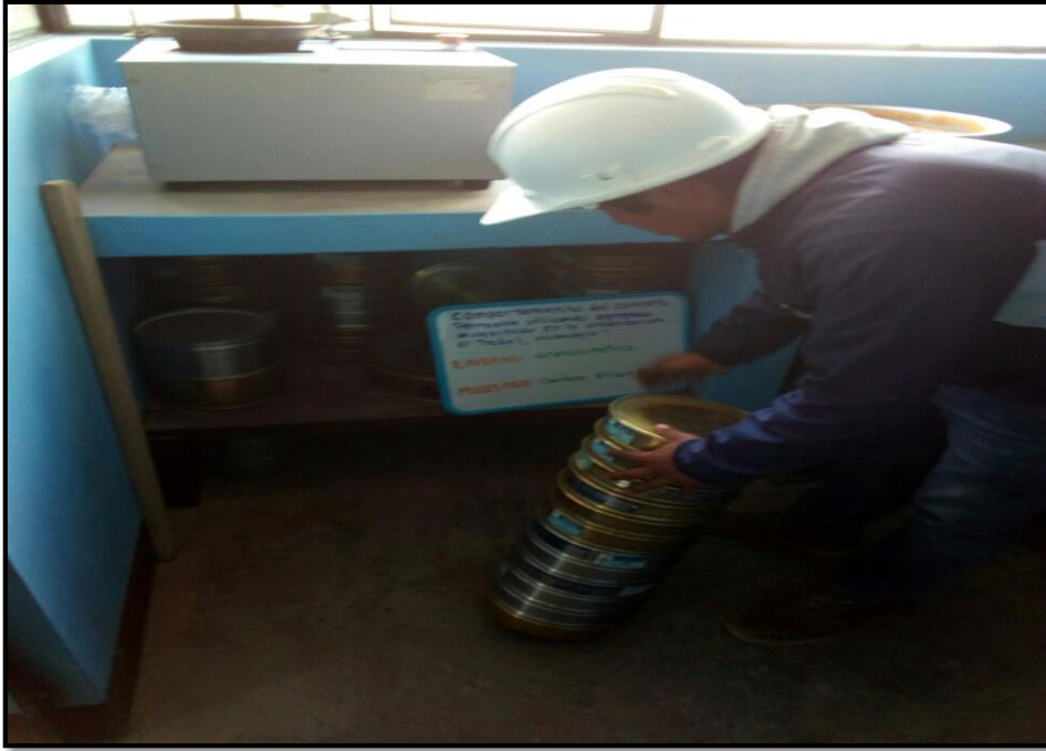
Imagen N° 3 Tamizado del agregado en el laboratorio (CENTAUROS INGENIEROS SAC)
