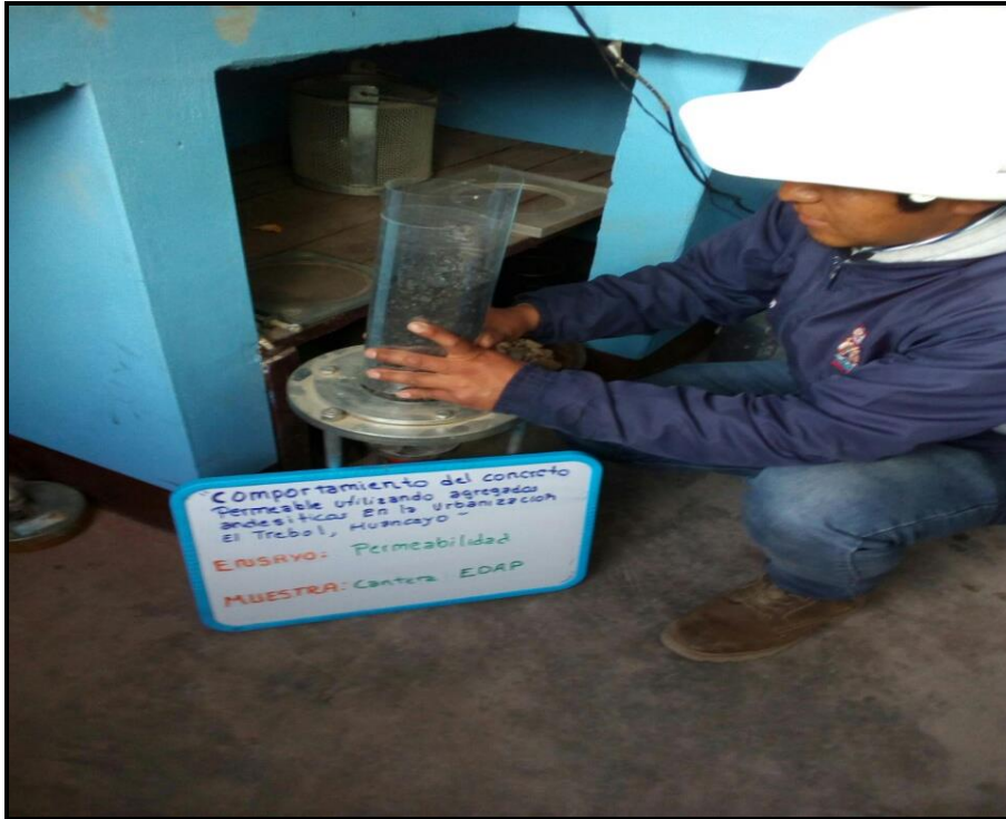
Imagen N° 17 preparado de materiales para el ensayo de permeabilidad del concreto permeable.
