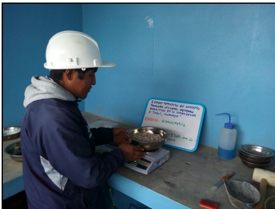
Imagen N° 5 Ensayo de peso unitario suelto y compactado ASTM C29/29M, Absorción NTP 400.022 y Contenido de Humedad (NORMA ASTM C-566).
