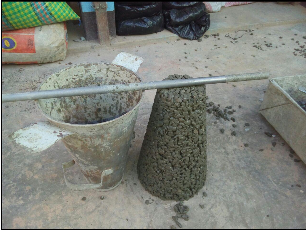
Imagen N° 9 Ensayo de asentamiento 0 “en el diseño practico del concreto permeable.
