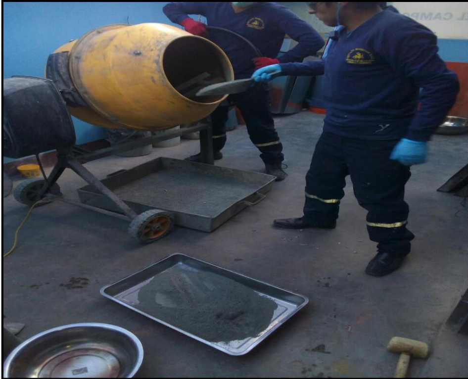
Imagen N° 7 Diseño de mezcla de concreto permeable y su preparación de acuerdo a la dosificación.
