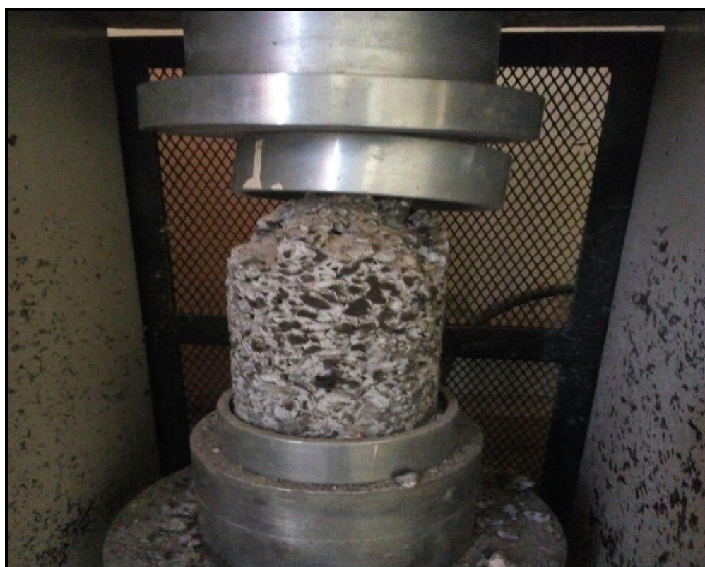
Imagen N° 12 Ensayo de resistencia a la compresión de tipo 6.
