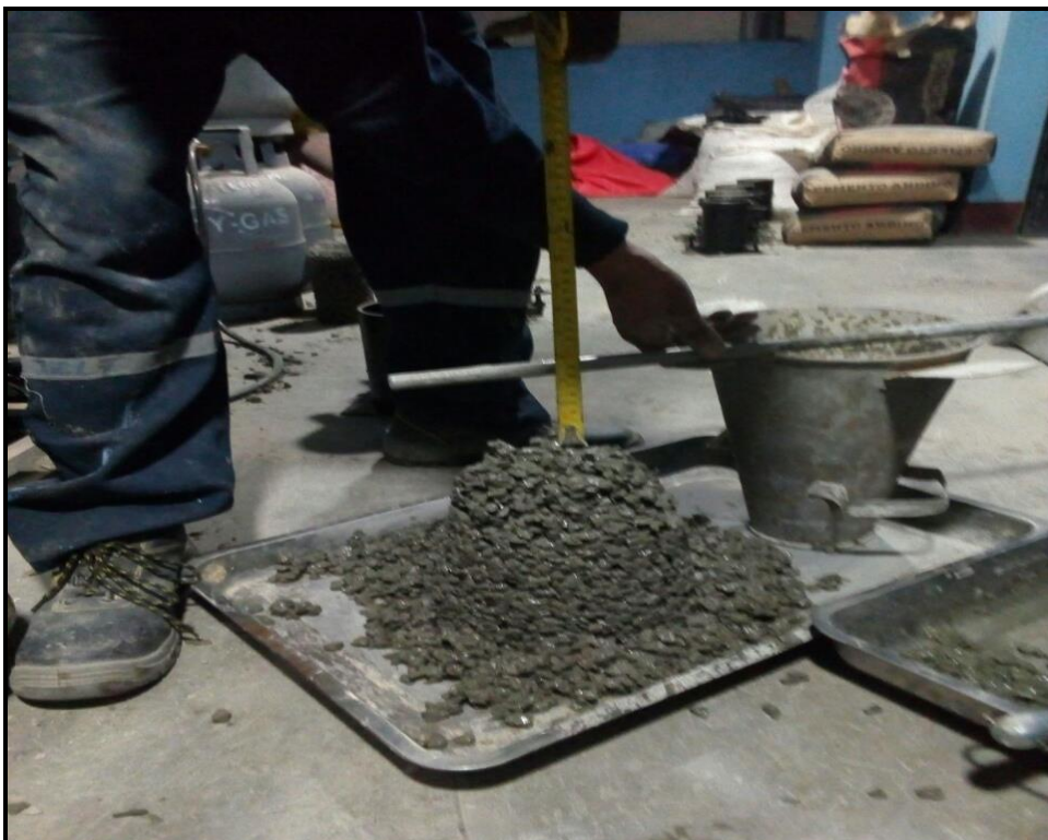
Imagen N° 10 Ensayo de asentamiento 2 “en el diseño practico del concreto permeable.
