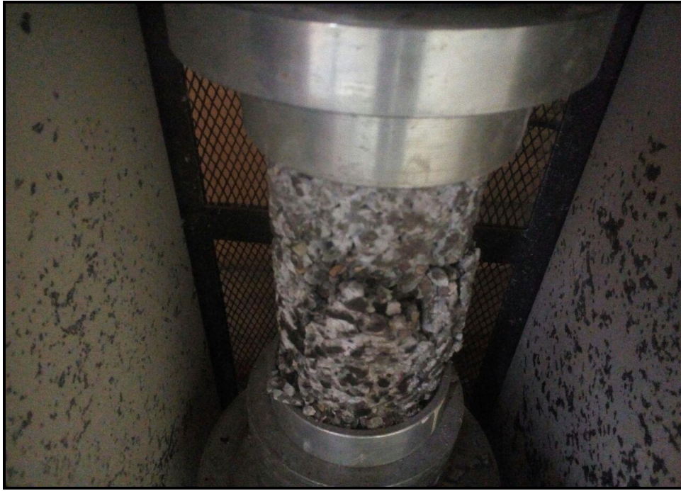
Imagen N° 13 Ensayo de resistencia a la compresión de tipo 1.
