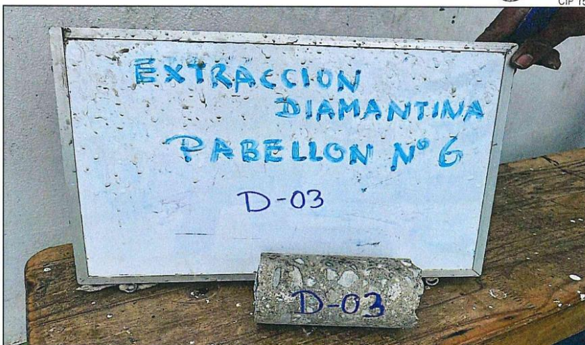
TESTIGO DE CONCRETO (Diamantina N.º 03) extraído en PLACA de Pabellón 06
