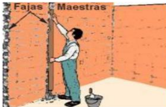
Figura 0.4 Colocación de Fija maestra
