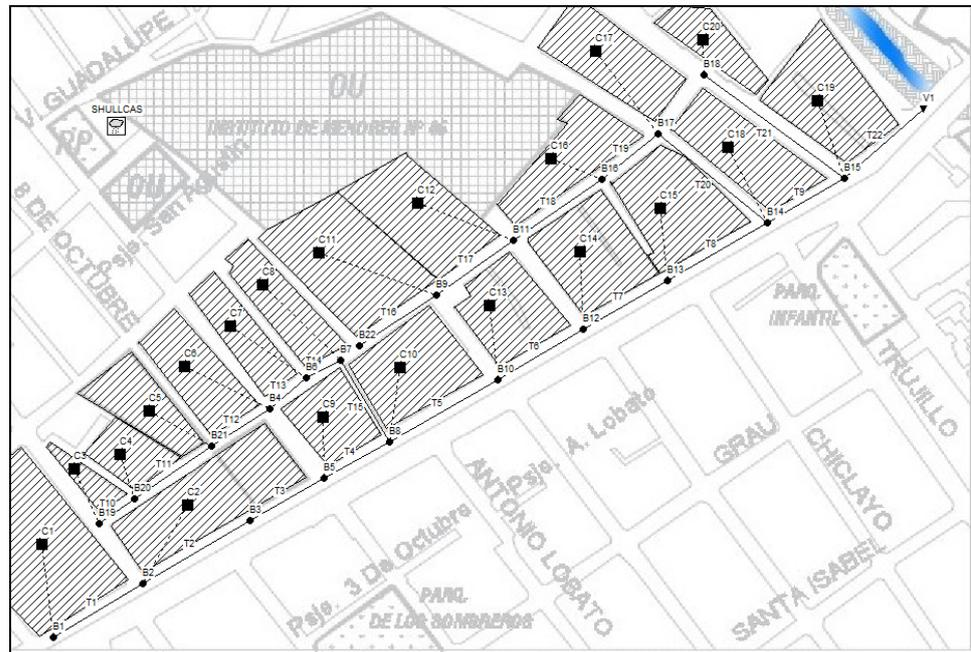
Figura 15. Modelo de simulación en el programa SWMM.
