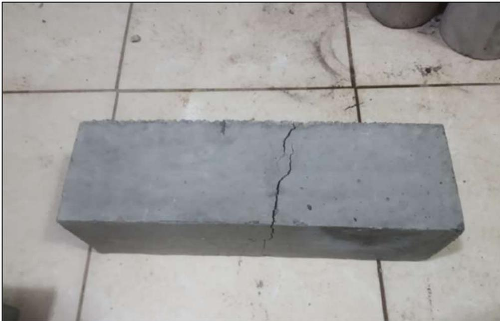
ANEXO 04. Probeta ensayada para determinación de resistencia residual
