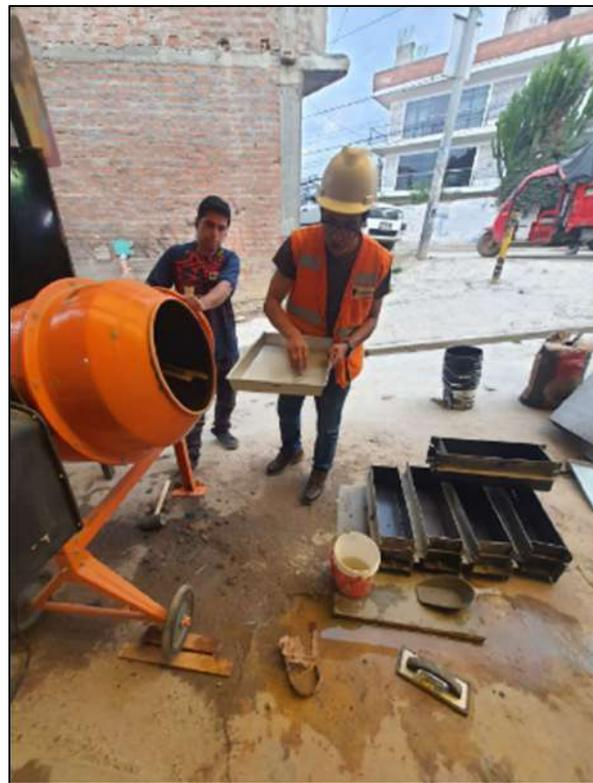
ANEXO 08. Elaboración de muestras para ensayos de resistencia residual
