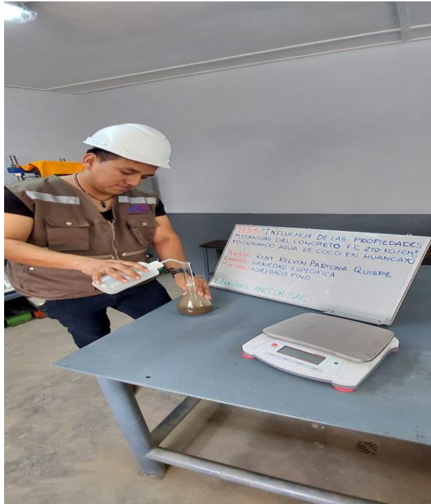
ENSAYO DE GRAVEDAD ESPECIFICA DE A.F
