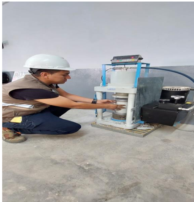
COLOCACION DE PROBETA A MAQUINA ROMPE PRECION 28 DIAS M.P
