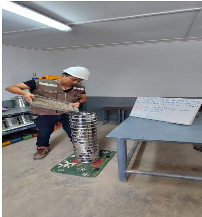
ENSAYO DE GRANUOMETRIA
