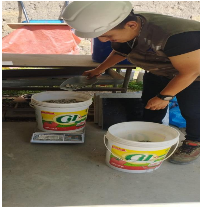
PESO UNITARIO SUELTO Y COMPACTADO DE A.G
