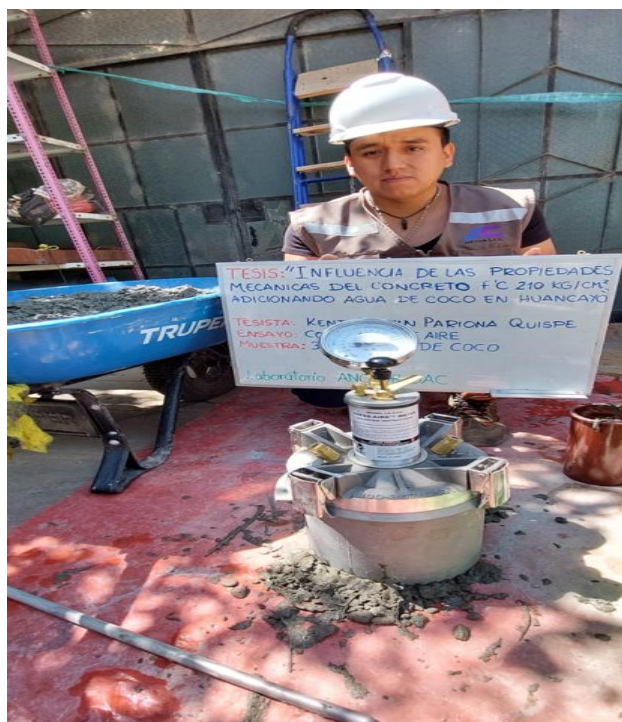
ENSAYO DE COMPRESION DE AIRE CON LA ADICION DEL 3.0% DE AGUA DE COCO
