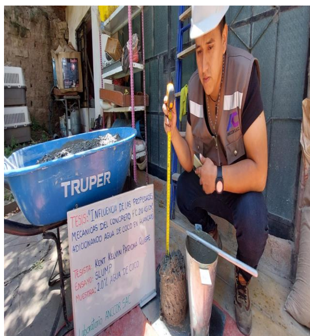
PRUEBA SLUMP CON ADICION DEL 2.0% DE AGUA DE COCO
