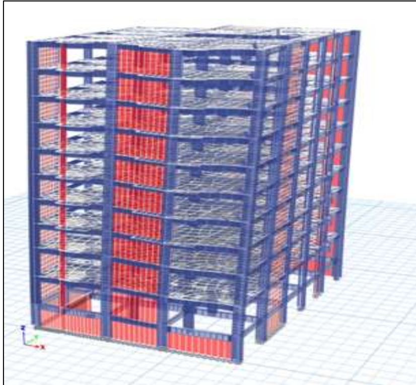
Figura N° 58. Simulación de la deriva eje X-X Nota: Propia
