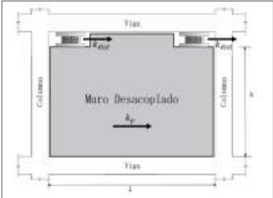
Figura N° 18. Componentes de funcionamiento del disipador SLB.
