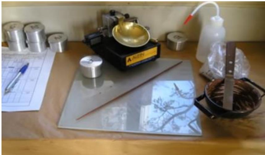
**Figura 09.** Equipos utilizados para el ensayo de límites de consistencia.
