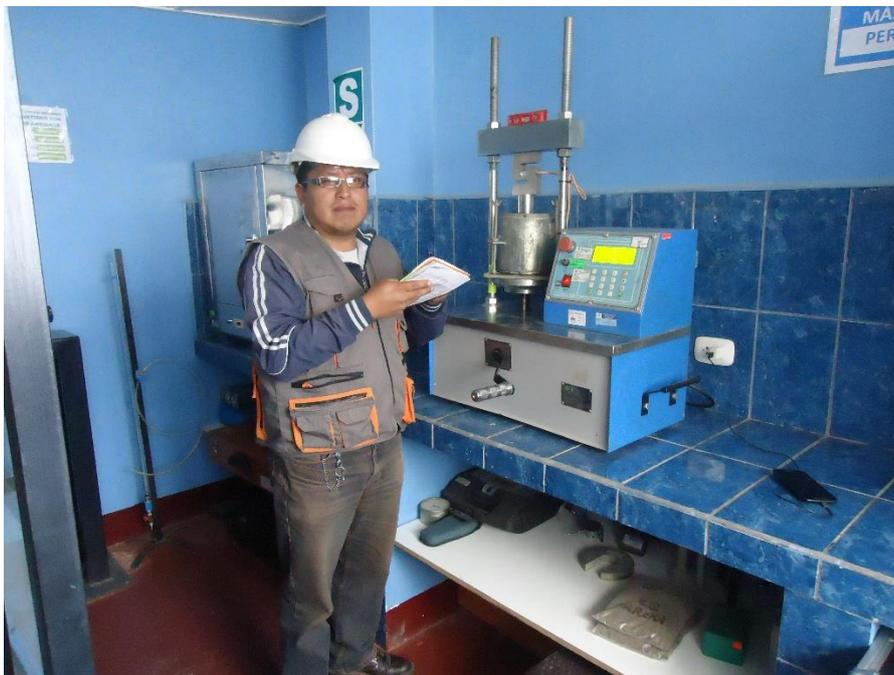
**Figura 11.** Ensayo de penetración.
