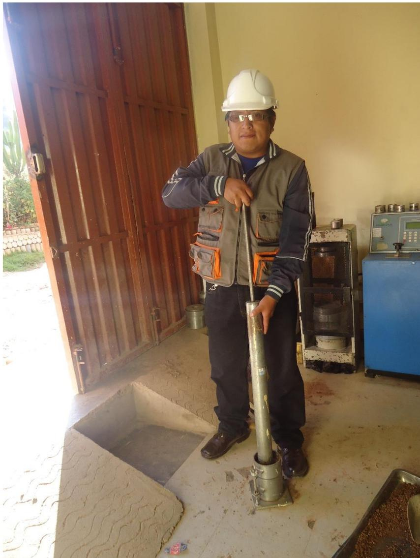
**Figura 10.** Ensayo de proctor modificado
