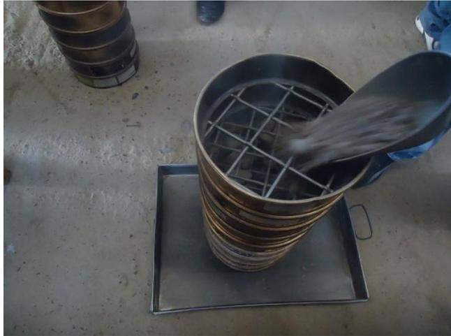
**Figura 08.** Ensayo de granulometría.
