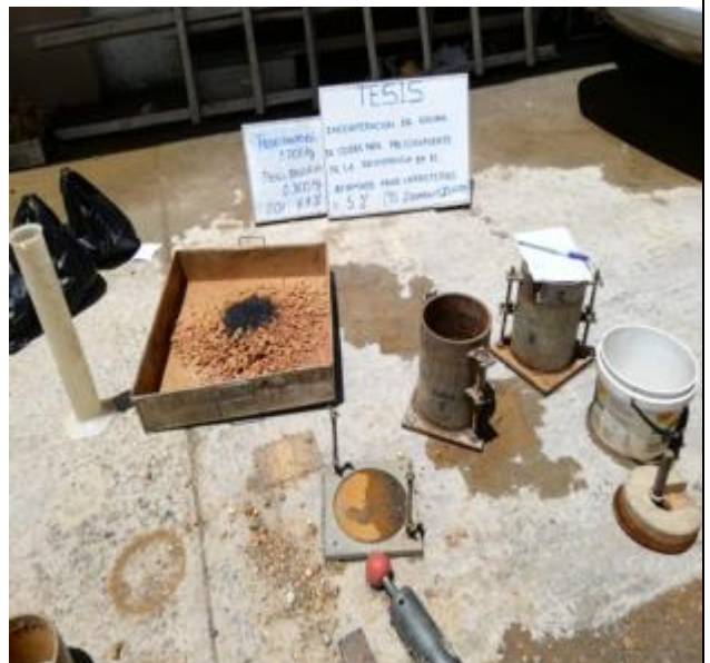
Foto 28: Preparación de muestra con incorporación de escoria de cobre para ensayo CBR.
