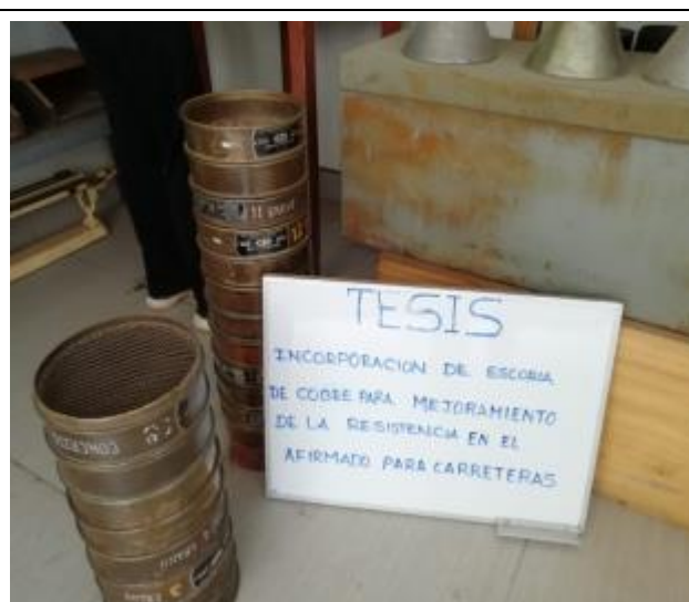
Foto 06: Juego de tamices de diferentes aberturas (mm), para distribución de partículas de agregados.
