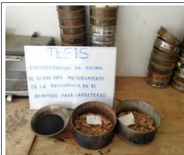
Foto 05: Distribución de materiales de escoria y afirmado para ensayo granulométrico.
