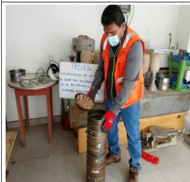
Foto 19: Ejecución de ensayo granulométrico.
