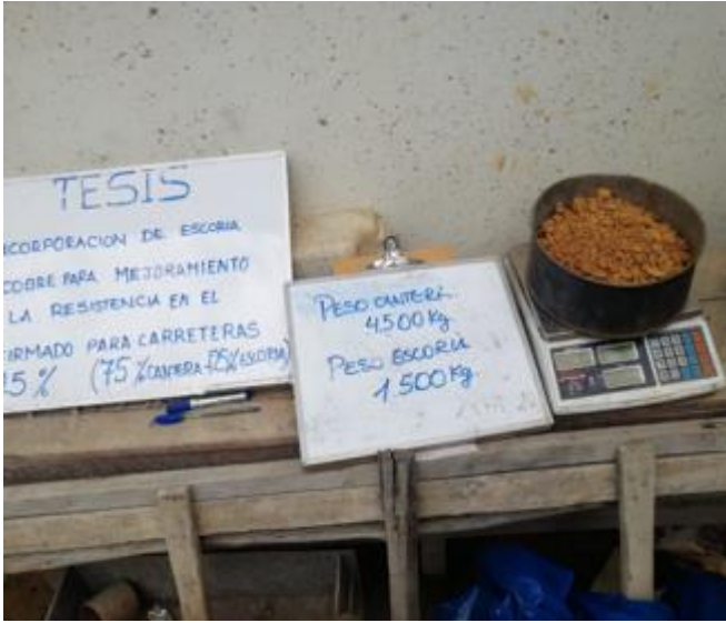
Foto 21: Pesado de materiales para ensayo de proctor modificado con 25% de escoria de cobre.
