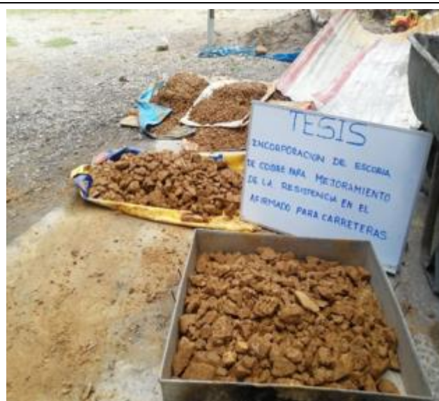
Foto 15: Separación de material grueso en afirmado de cantera km 8+000.
