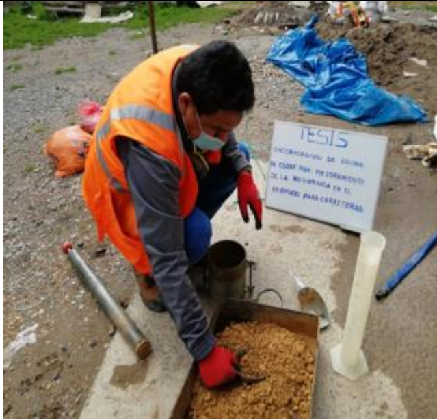
Foto 29: Ejecución de ensayo de proctor modificado de cantera de afirmado.
