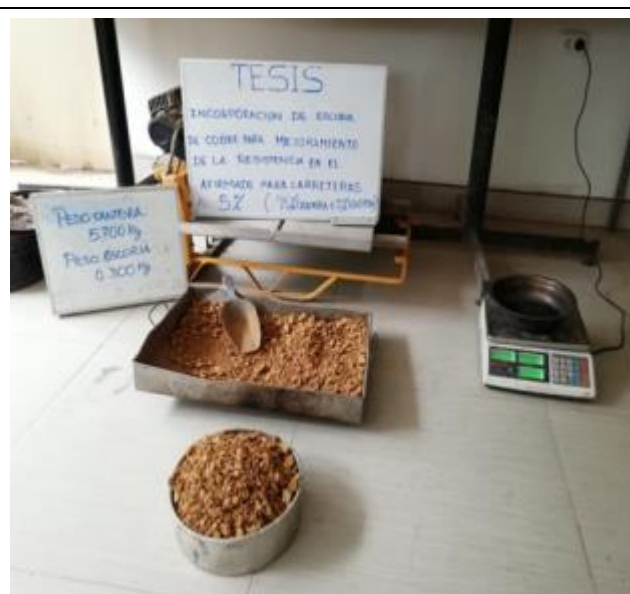
Foto 14: Pesado de material de afirmado para la mezcla con 5% de escoria de cobre.
