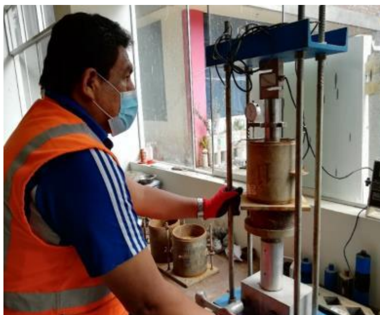
Figura N° 15: Características Mecánicas del afirmado para carreteras C.B.R. método de compactación ASSHTO T-180 D
