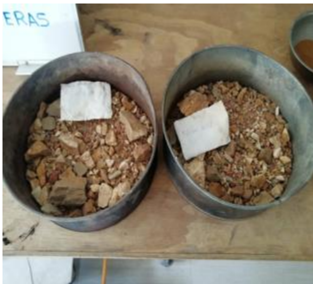
Foto 11: Secado de material de afirmado cantera Km 8+000.
