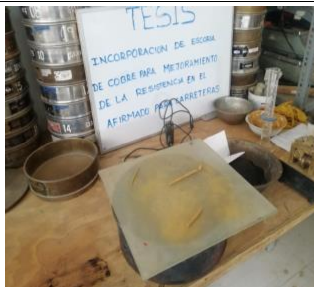
Foto 16: Ensayo de límite líquido del material de afirmado de la cantera km 8+000.
