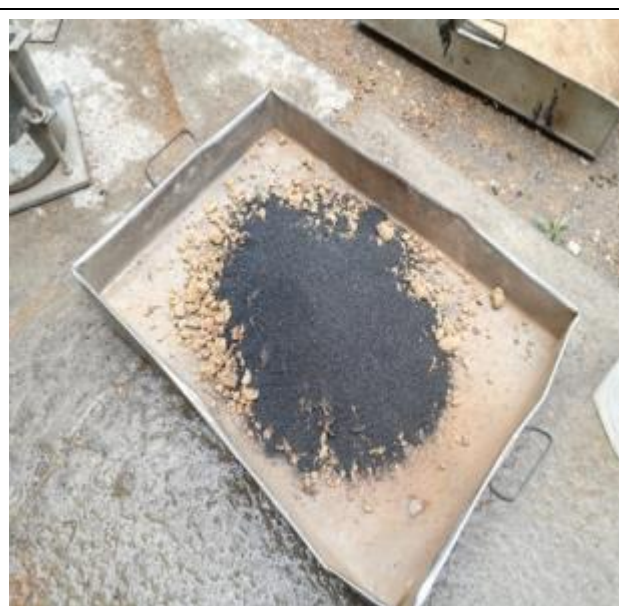
Foto 18: Materiales de afirmado y escoria de cobre para mezcla y ejecución de ensayo de proctor modificado.
