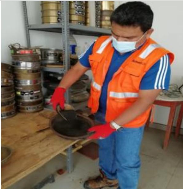
Foto 31: Ejecución de ensayo granulométrico de la escoria de cobre
