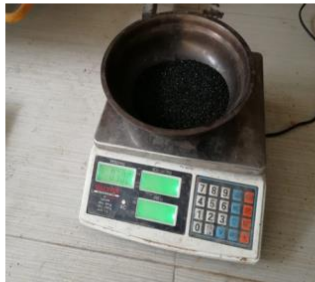
Foto 12: Pesado de escoria de cobre para incorporar al material de afirmado.
