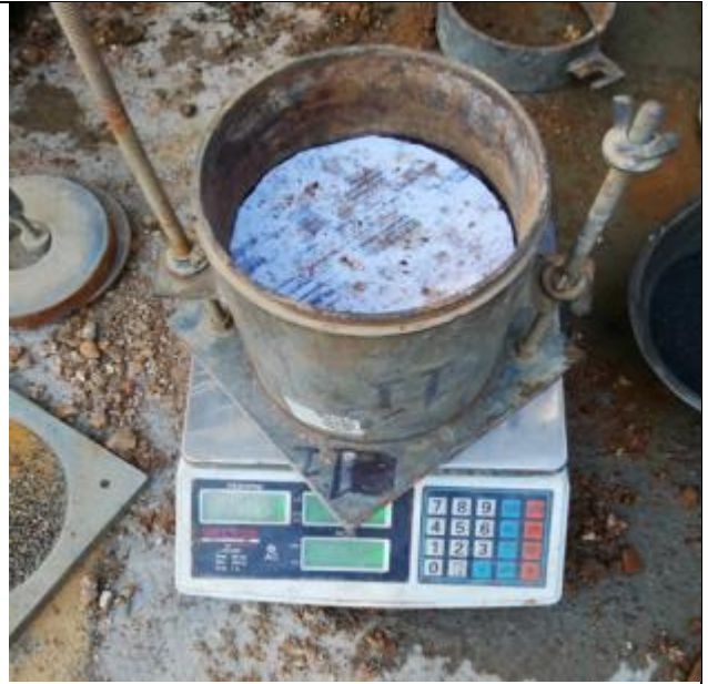
Foto 26: Pesado de molde más material compactado para ensayo CBR.
