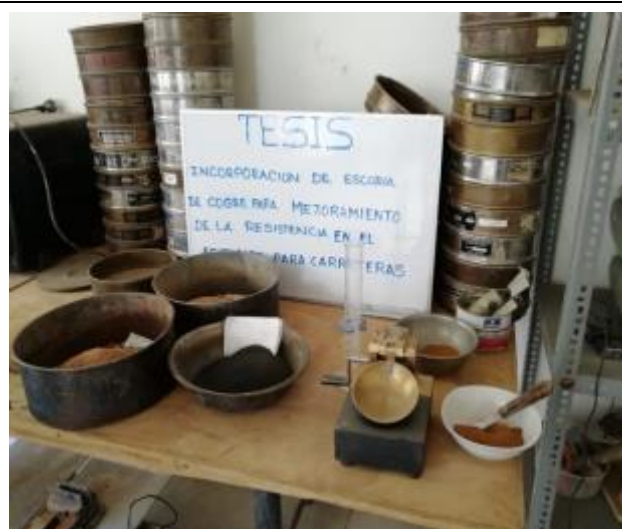
Foto 08: Materiales de afirmado y escoria de cobre para determinación de ensayos de Límites de Atterberg.
