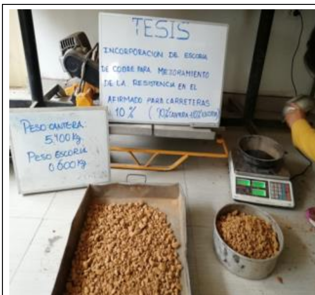
Foto 17: Pesado de materiales para ensayo de proctor modificado.
