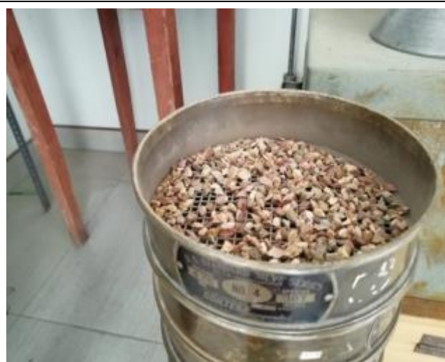
Foto 07: Material de afirmado en proceso de ensayo granulométrico.
