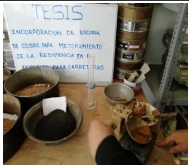
Foto 10: Ensayo para determinación de Límites de Atterberg.
