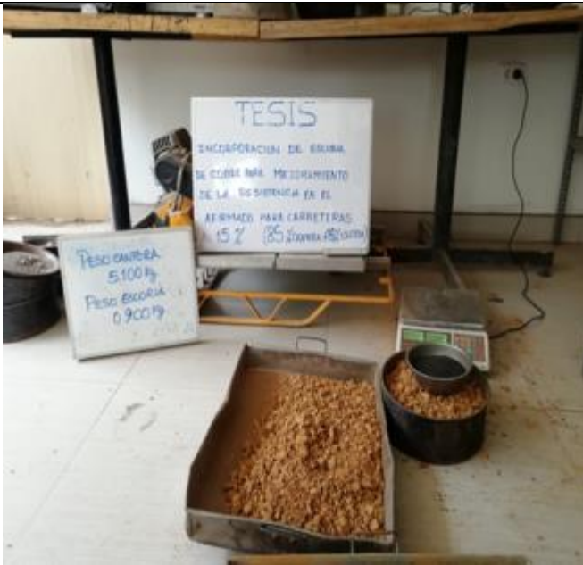
Foto 23: Pesado de materiales para ensayo de proctor modificado con 15% de escoria de cobre
