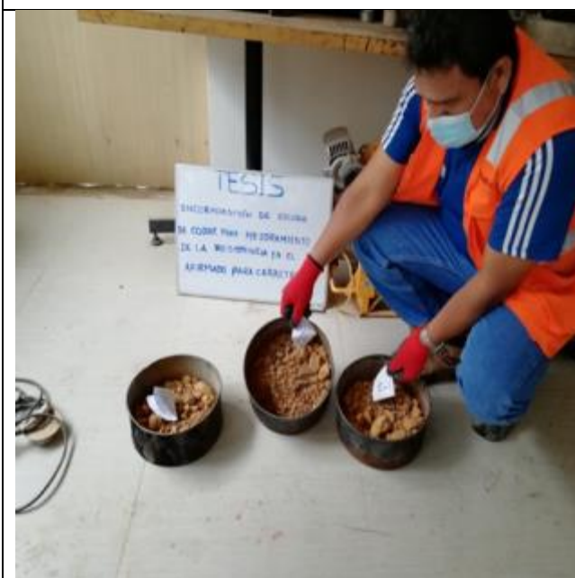
Foto 03: Selección de material de afirmado para las diferentes dosificaciones
