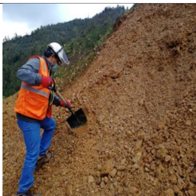
Foto 02: Muestreo de material de cantera de afirmado km 8+000
