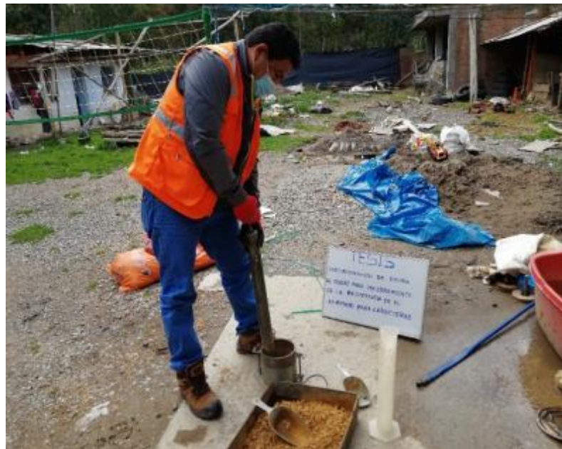
Figura N° 14: Características Mecánicas del afirmado para carreteras Proctor Modificado
