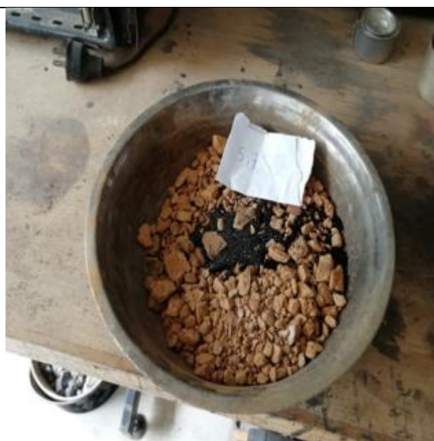
Foto 04: Dosificación de afirmado con escoria de cobre para ensayo granulométrico.
