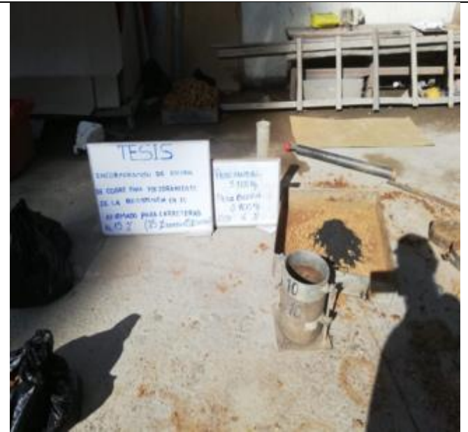
Foto 24: Pesado de materiales para ensayo de proctor modificado con 15% de escoria de cobre
