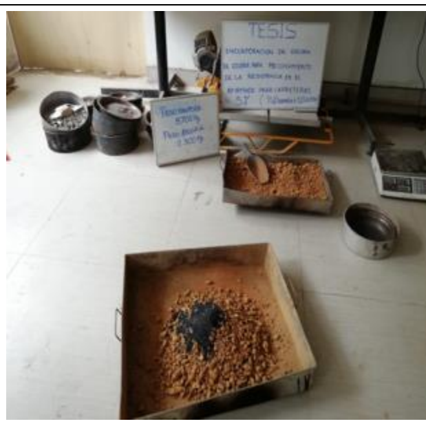
Foto 20: Mezcla al incorporar 5% de material de escoria de cobre y de afirmado.
