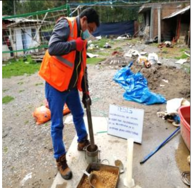
Foto 30: Aplicación de energía de compactación con martillo de 10 lb para ensayo de proctor modificado de material de cantera de afirmado.
