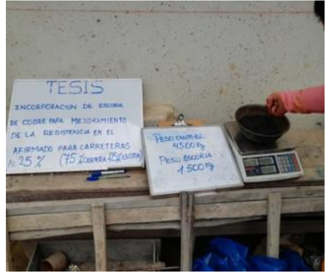
Foto 22: Pesado de escoria de cobre 25%
