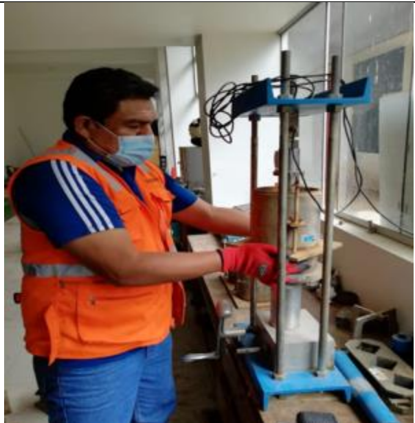
Foto 32: Ejecución de ensayo de CBR.
