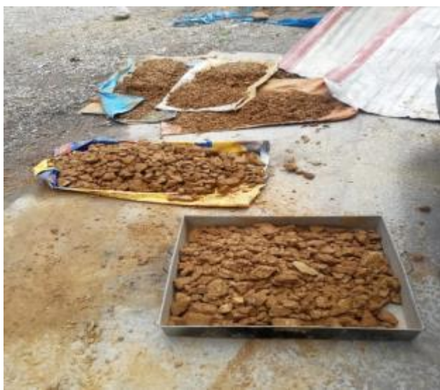
Foto 09: Separación de partículas en el proceso de secado del material de afirmado.
