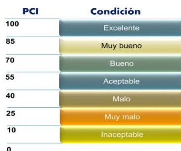
Figura N° 13. Clasificación del estado del pavimento del acuerdo al PCI
