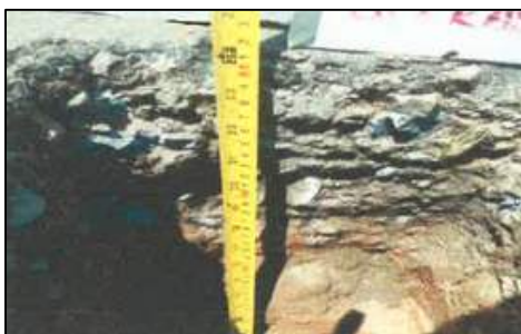
Figura N° 7. Toma de muestras e identificación el espesor de la capa estructural Nota: Elaboración Propia
