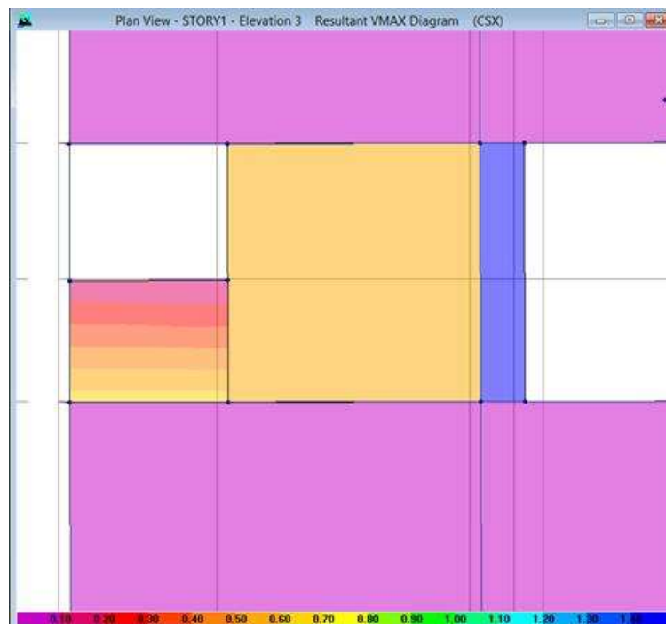
Figura 93 Diagrama de Fuerza Cortante en la dirección XX para la losa maciza
