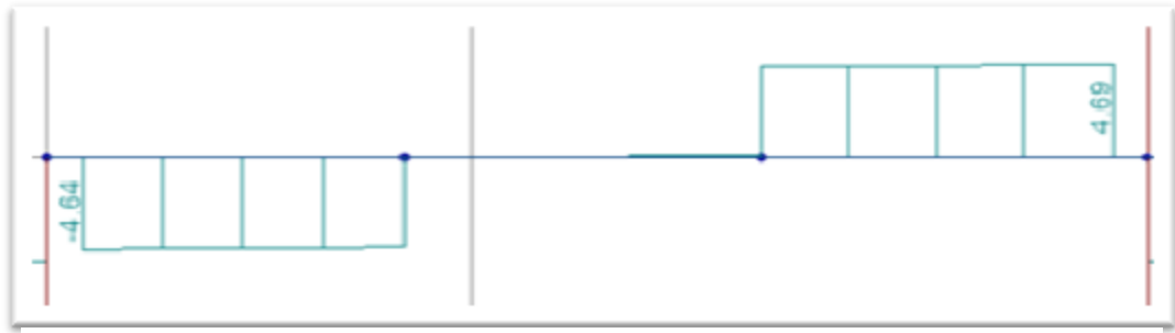
Figura 147 Vista de Fuerza Cortante por carga muerta en ETABS
