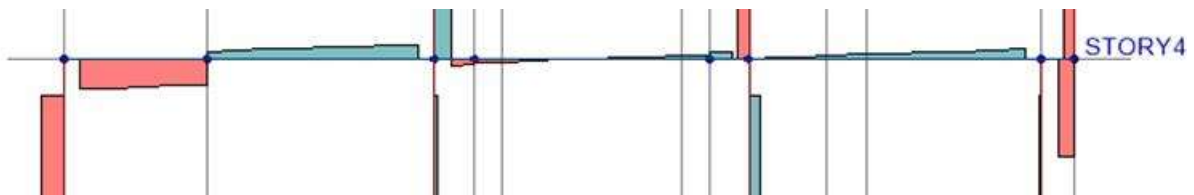
Figura 100 Diagrama de fuerza cortante de viga VP-102 (Cargas de gravedad).
