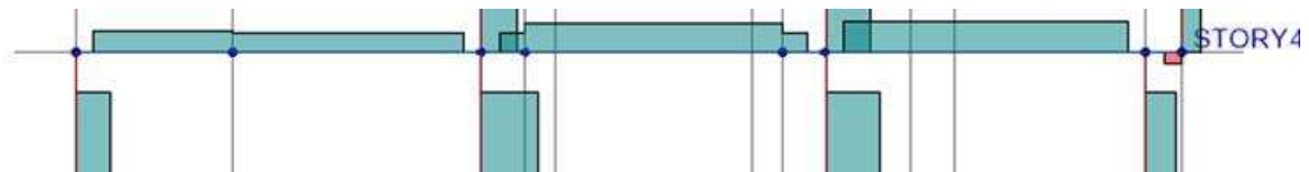
Figura 101 Diagrama de fuerza cortante de viga VP-102 (Cargas de sismo).
