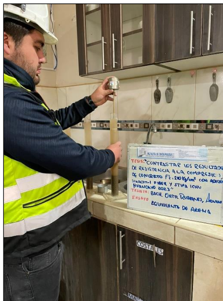
Fotografía N° 4: Prueba para el análisis del equivalente de arena. NTP 339.146
