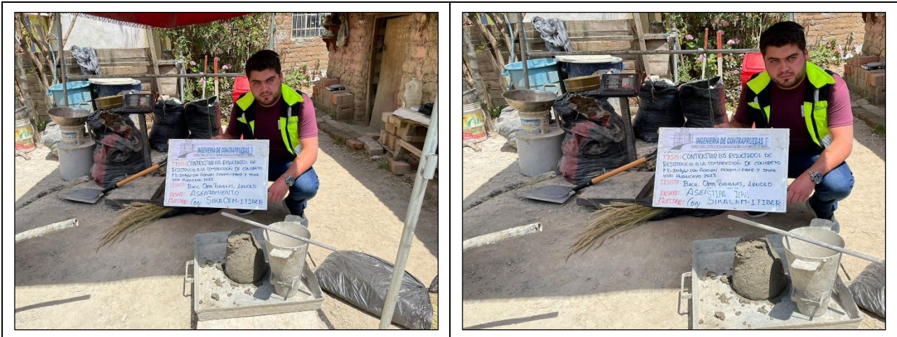
Fotografía N° 11: Prueba de consistencia en el concreto empleando SIKACEM-1 FIBER y STIPA ICHU en los porcentajes de 0.25% y 0.75%.
