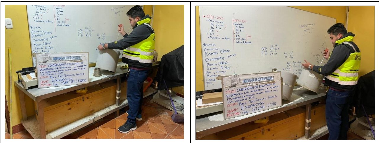
Fotografía N° 13: Ensayo de Exudación en la mezcla con SIKACEM-1 FIBER y con STIPA ICHU en los porcentajes de 0.25% y 0.75%.
