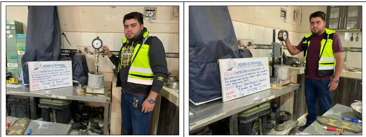
Fotografía N° 14: Ensayo de TF en la mezcla de concreto empleando SIKACEM-1 FIBER y con STIPA ICHU en los porcentajes de 0.25% y 0.75%.
