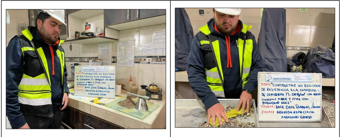
Fotografía N° 3: Prueba de peso específica y gravedad específica. MTC E206 y MTC E205.
