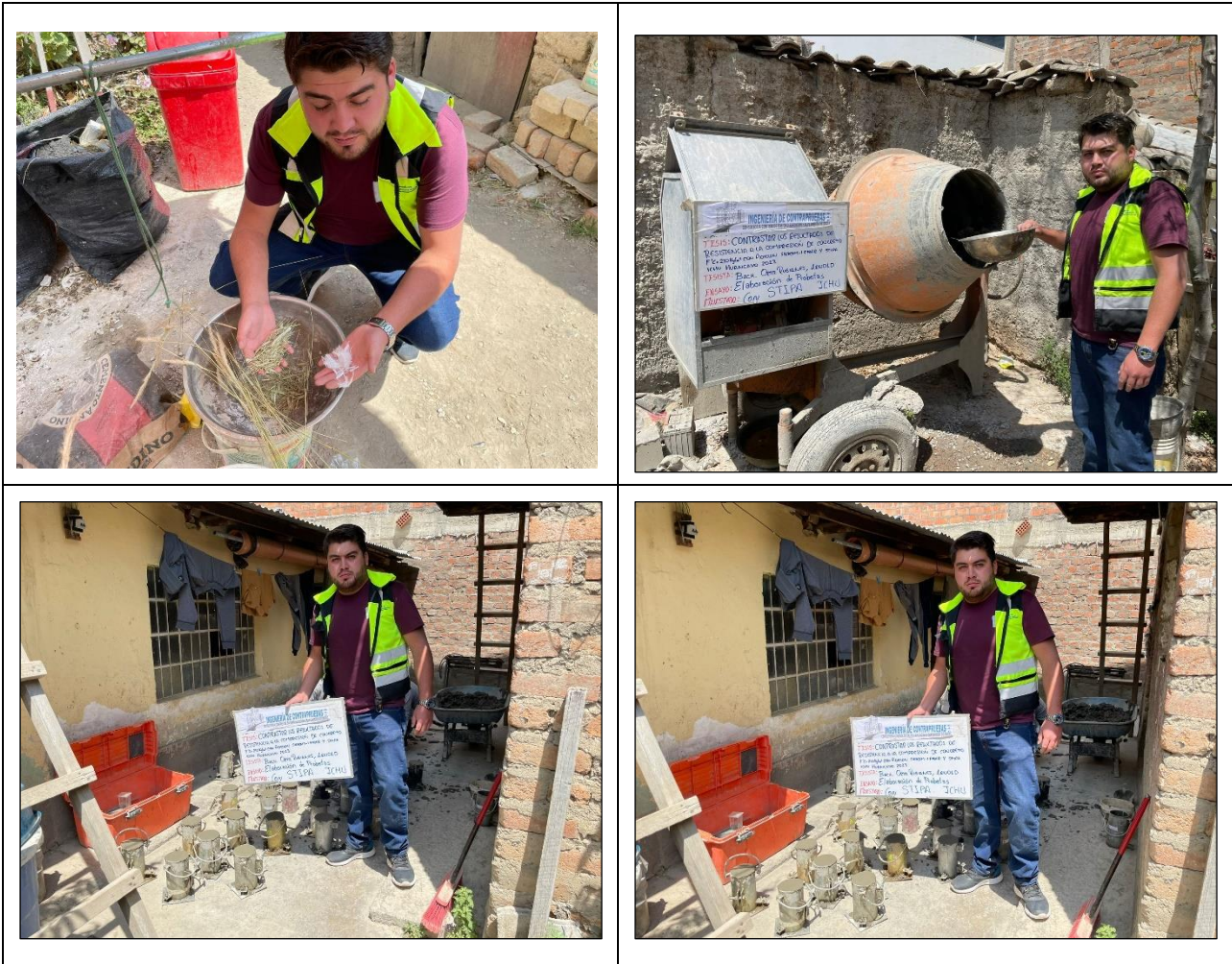
Fotografía N° 9: Elaboración de muestras con adición STIPA ICHU en los porcentajes de 0.25% y 0.75% Nota: Propia
