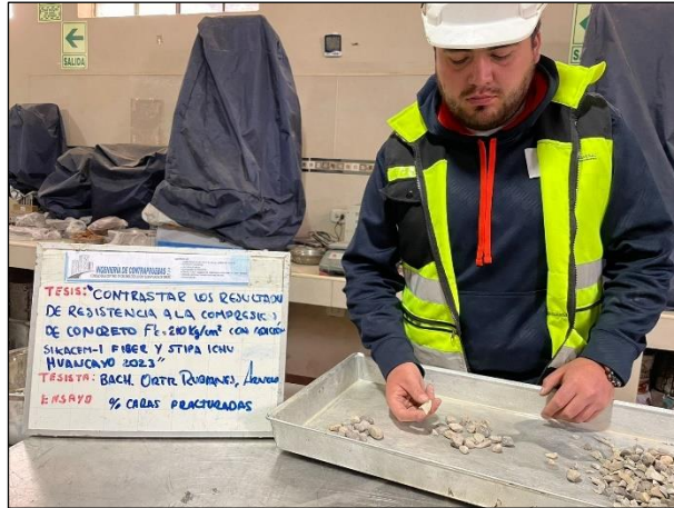
Fotografía N° 7: Prueba de caras fracturadas en agregados. MTC E210.
