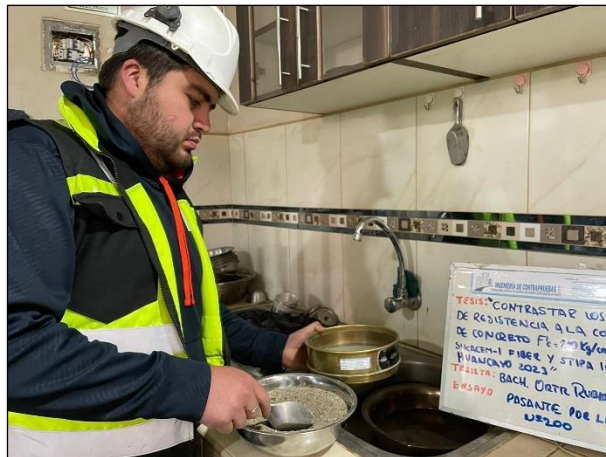
Fotografía N° 8: Prueba Pasante por la malla N°200. MTC E202.
