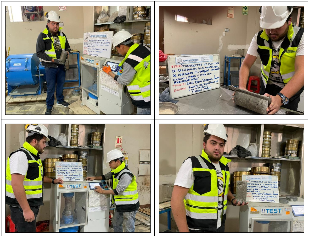
Fotografía N° 15: Ensayo de Resistencia a la compresión del concreto convencional, con adición SIKACEM-1 FIBER y con STIPA ICHU en los porcentajes de 0.25% y 0.75%.
