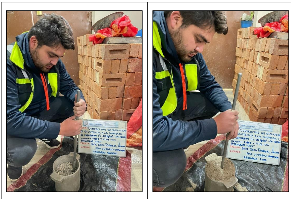
Fotografía N° 2: Prueba de PUC y PUS de los agregados. NTP 400.017
