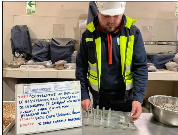
Fotografía N° 6: Prueba del porcentaje de chatas y alargadas. ASTM D4791.
