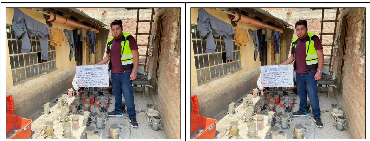
Fotografía N° 10: Elaboración de muestras con adición SIKACEM-1 FIBER Nota: Propia
