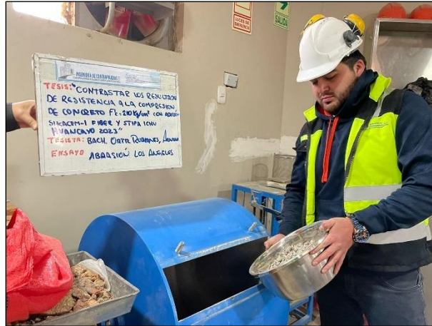
Fotografía N° 5: Prueba del desgaste en el agregado grueso. MTC E207.
