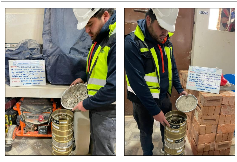
Fotografía N° 1: Prueba del AF y AG de acuerdo con la NTP 400.012
