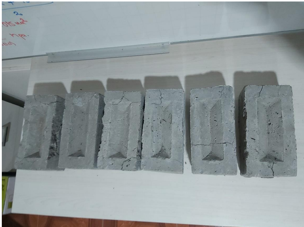
Fotografía 14. Rotura de unidades de concreto
