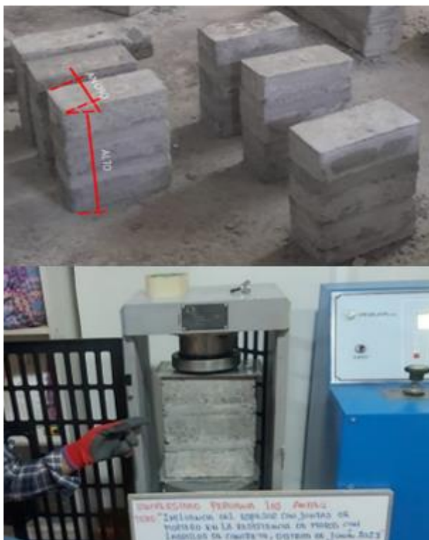
Figura 4.15. Pilas con ladrillos de concreto ensayadas a compresión axial.
