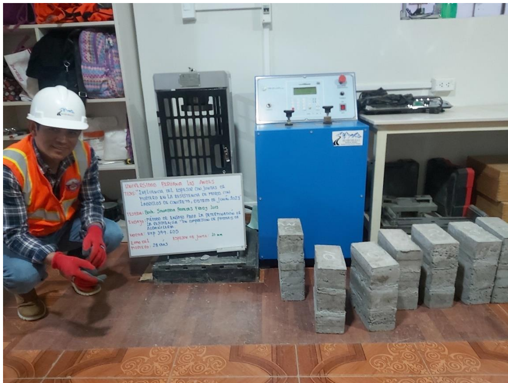
Fotografía 19. Ensayo de resistencia a compresión axial de pilas
