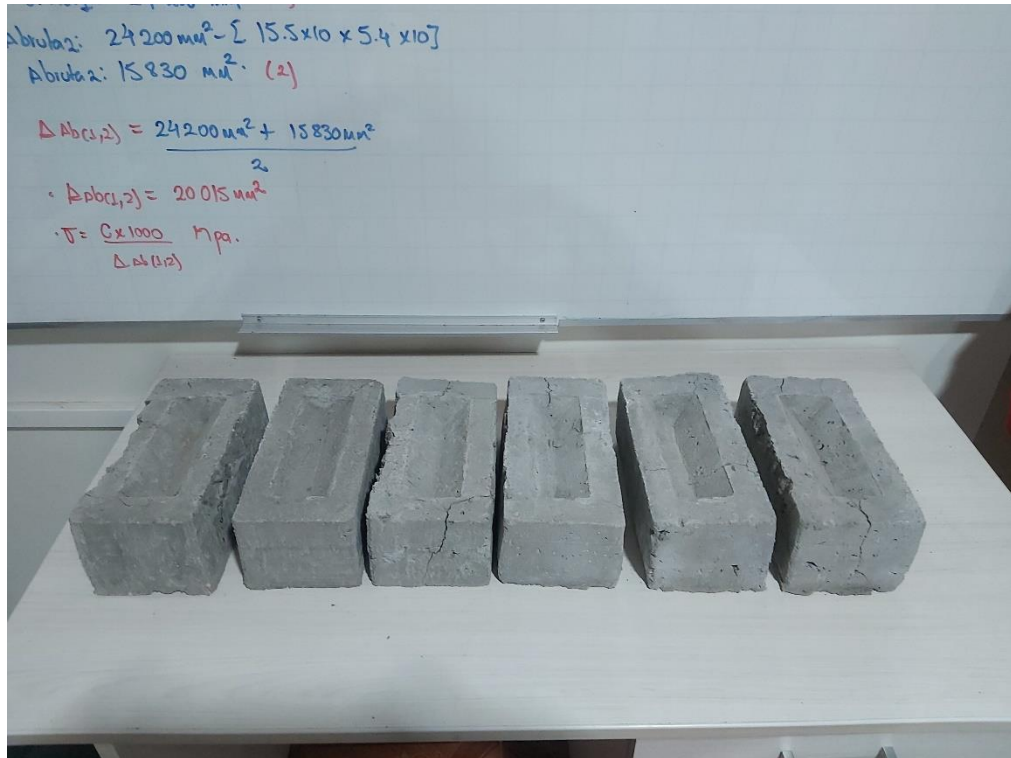
Fotografía 13. Rotura de ladrillos de concreto
