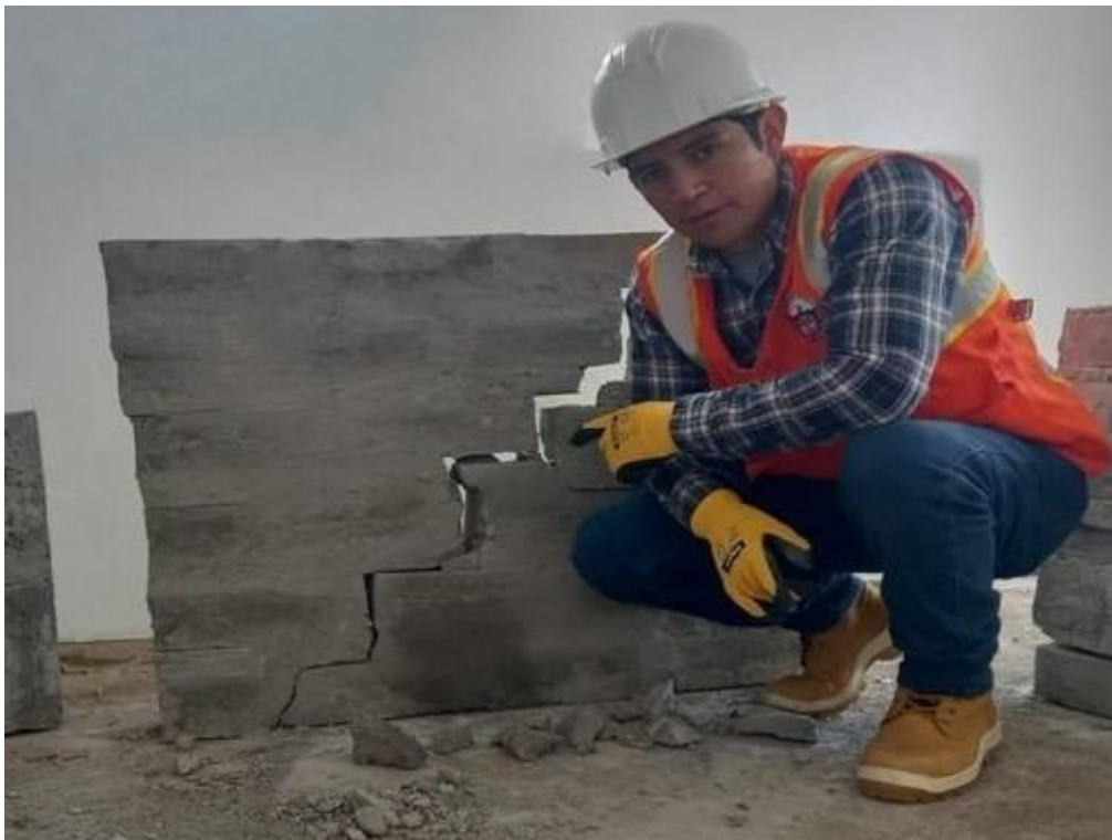
Fotografía 24. Falla por corte escalonada.
