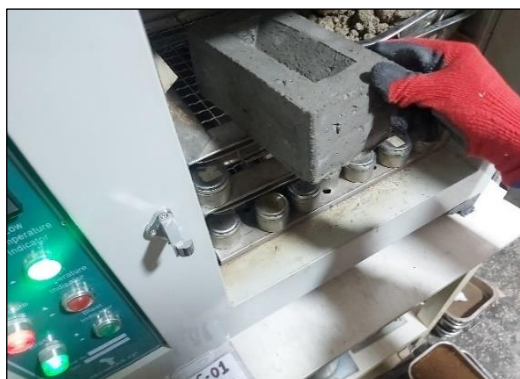
Figura 4.10. Horno equipo para determinar el peso seco.
