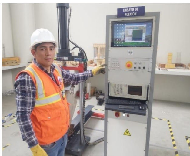
Figura 4.16. Equipo para ensayo de compresión diagonal en muros de albañilería.
