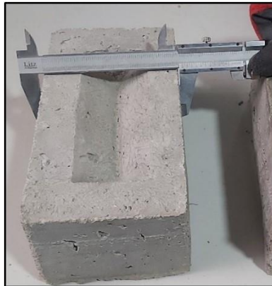
Figura 4.8. Uso de vernier para determinar medidas del ladrillo.
