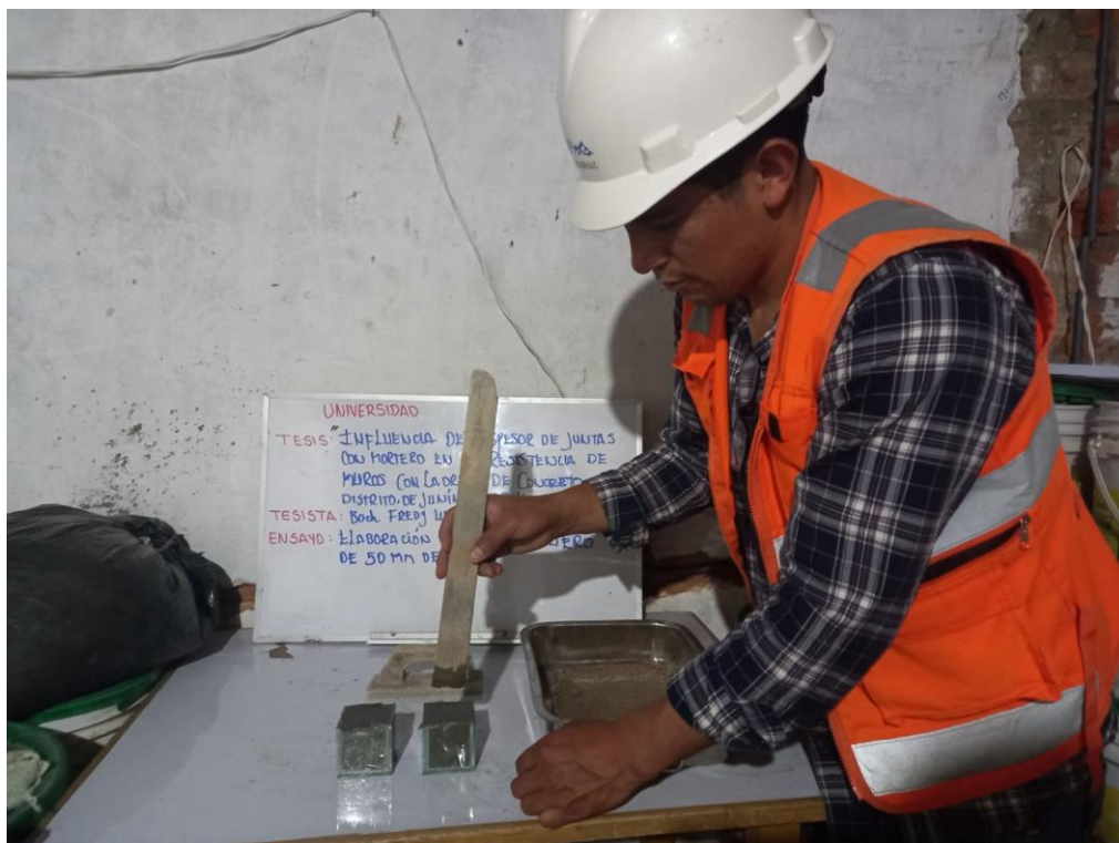
Fotografía 04. Elaboración de cubo de mortero
