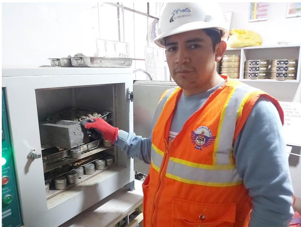
Fotografía 10. Horno para secado del ladrillo de concreto
