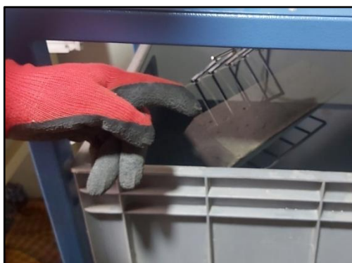
Figura 4.11. Equipo para ensayo de absorción de unidad de albañilería.
