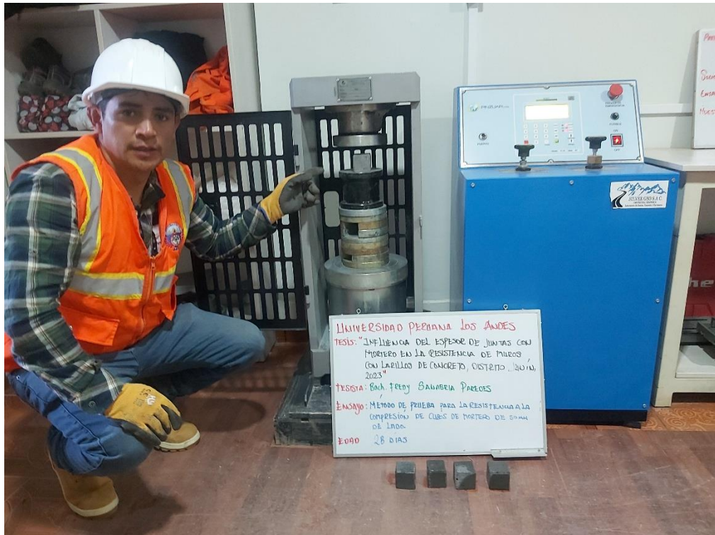
Fotografía 05. Ensayo de la resistencia del mortero pasado los 28 días
