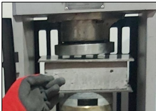
Figura 4.12. Equipo de ensayo de resistencia a compresión axial.
