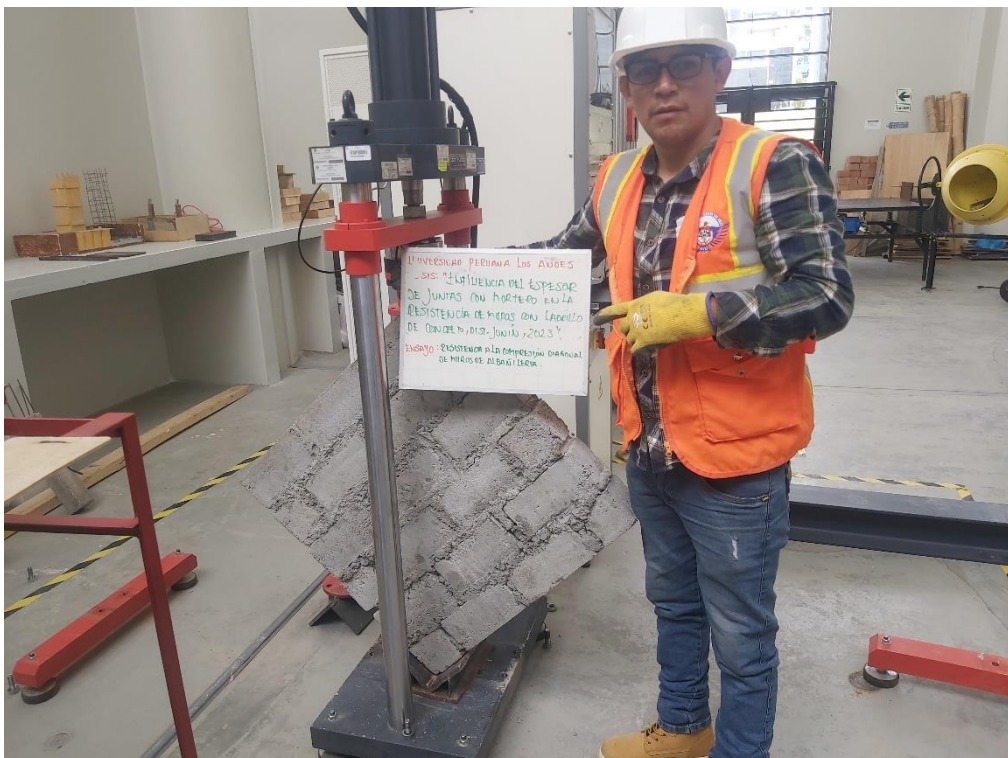
Fotografía 22. Rotura del muro por ensayo de resistencia a compresión diagonal
