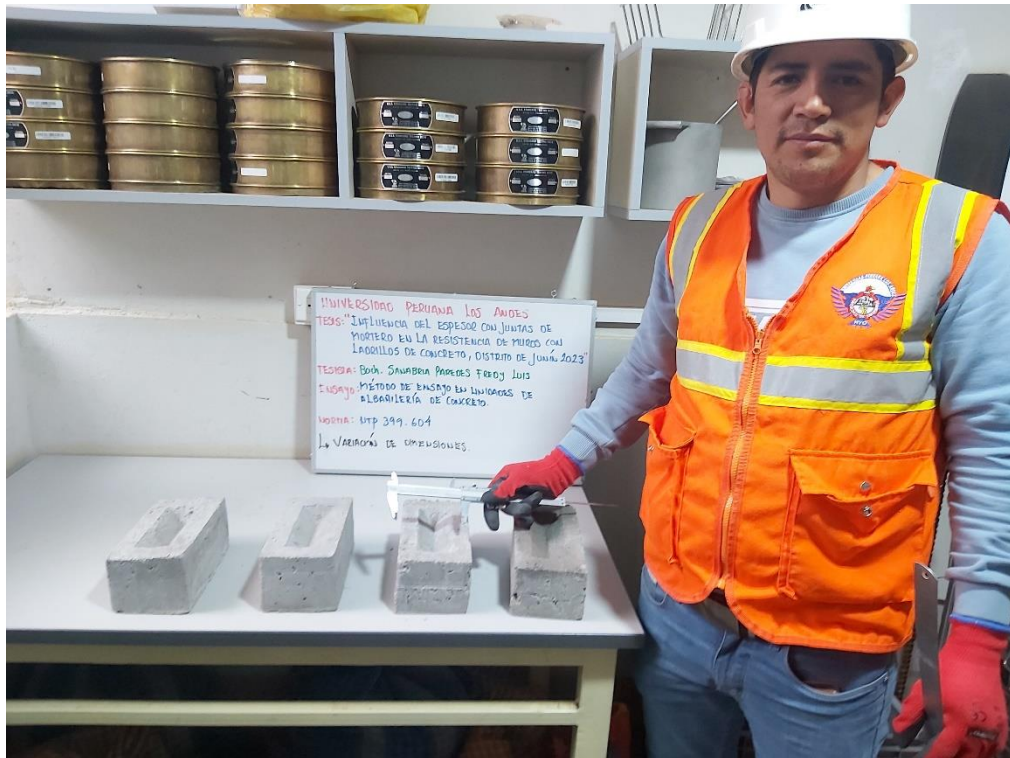
Fotografía 07. Medidas de variación dimensional del ladrillo de concreto
