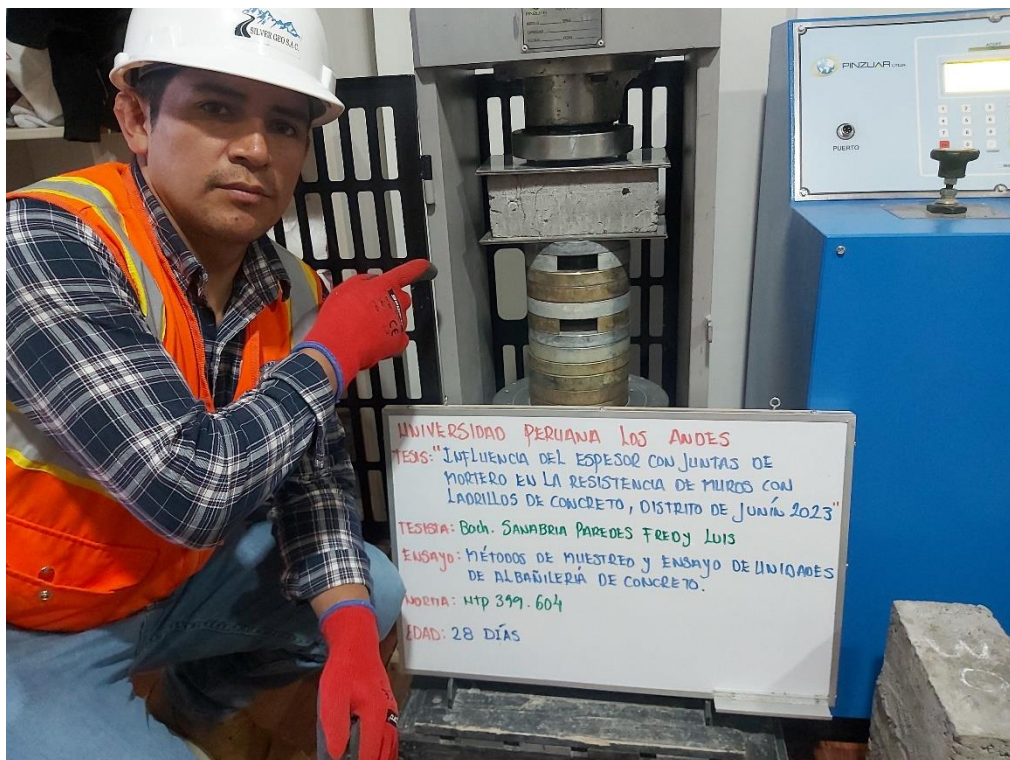
Fotografía 12. Ensayo de resistencia a compresión axial del ladrillo
