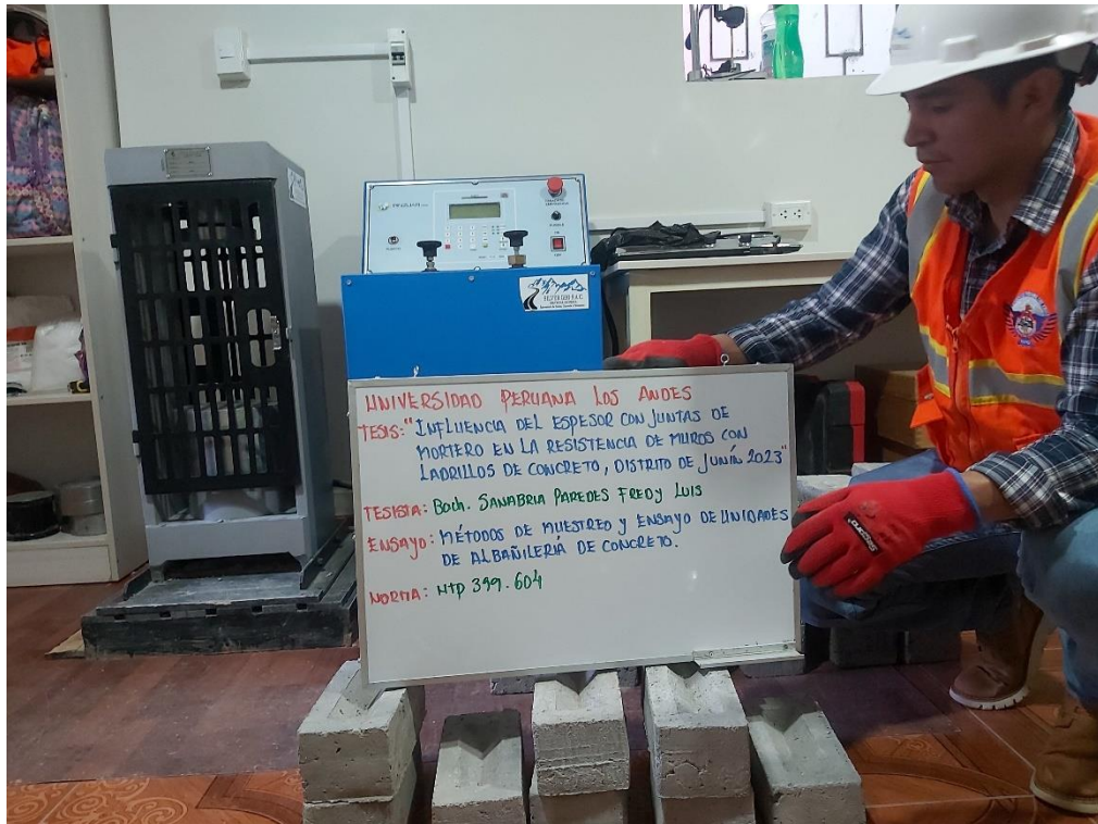
Fotografía 11. Ensayo de resistencia del ladrillo de concreto
