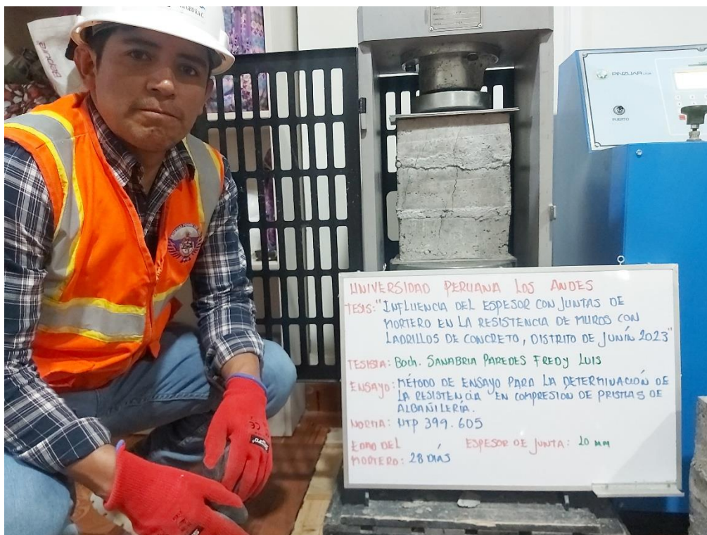
Fotografía 20. Rotura de pila por ensayo de resistencia a compresión axial
