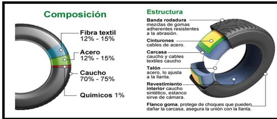
Figura 4. Estructura y composición de un neumático.
