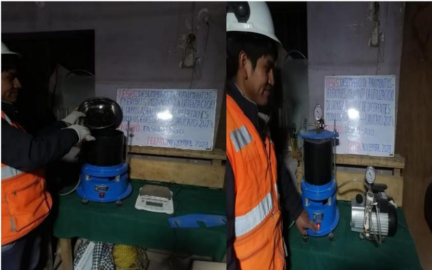
Fotografía 21. Ensayo RICE en la mezcla asfáltica convencional.
