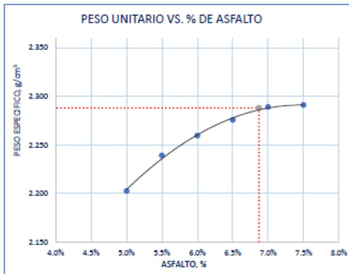
Figura 5.14. Peso unitario vs contenido de cemento asfáltico en la SMA.
