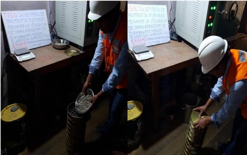
Fotografía 24. Granulometría del agregado grueso para la mezcla asfáltica SMA.
