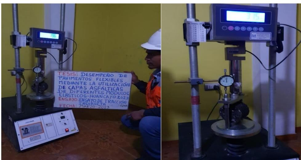
Fotografía 38. Subgrupo acondicionado (especímenes de MAC - 2, SMA y MAC - SMA) ensayados mediante mordaza Lottman.
