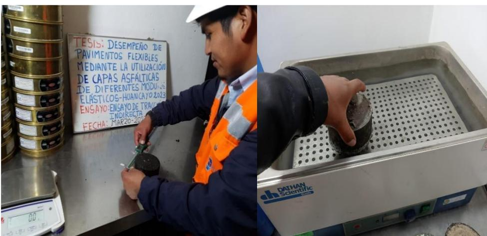
Fotografía 35. Medición de espesor, diámetro y acondicionamiento del subgrupo seco de los especímenes de MAC, SMA y MAC-SMA.
