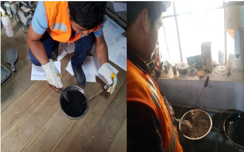
Fotografía 17. Vista de la preparación de la mezcla asfáltica en caliente convencional.
