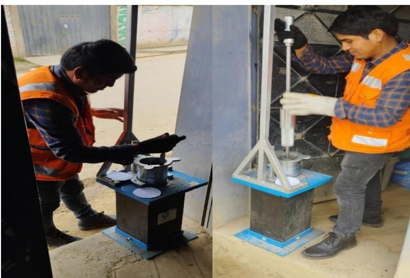
Fotografía 18. Vista del compactado de la mezcla asfáltica convencional.
