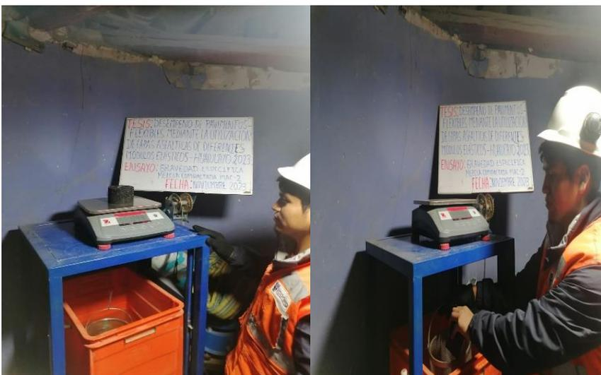
Fotografía 20. Ensayo para determinar la gravedad específica de las briquetas de mezcla asfáltica convencional.
