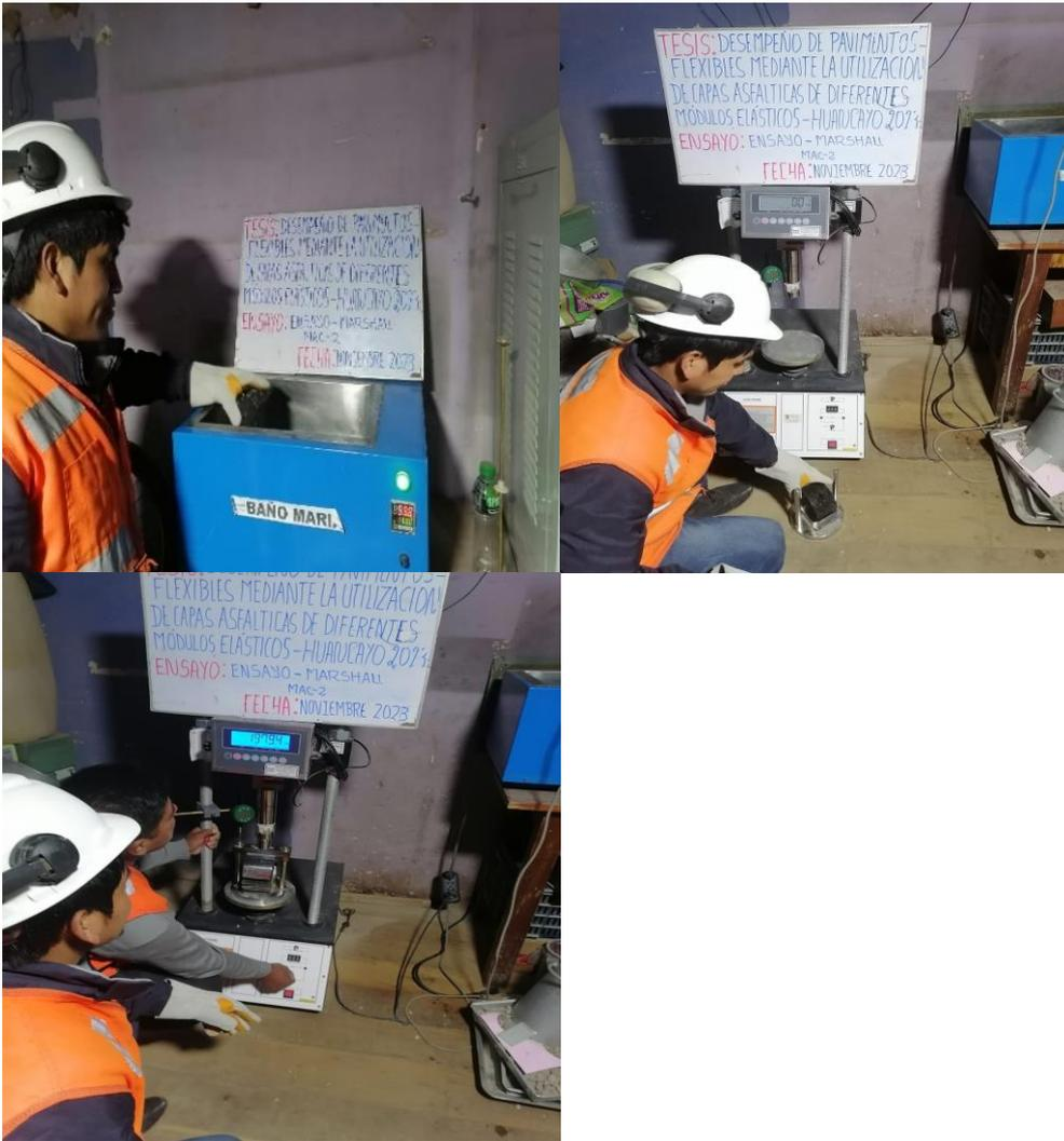
Fotografía 19. Ejecución del ensayo Marshall de la mezcla asfáltica en caliente convencional.
