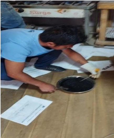
Fotografía 25. Elaboración de la mezcla asfáltica SMA.
