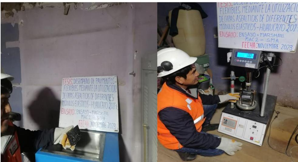
Fotografía 32. Ensayo Marshall de la mezcla convencional y SMA.
