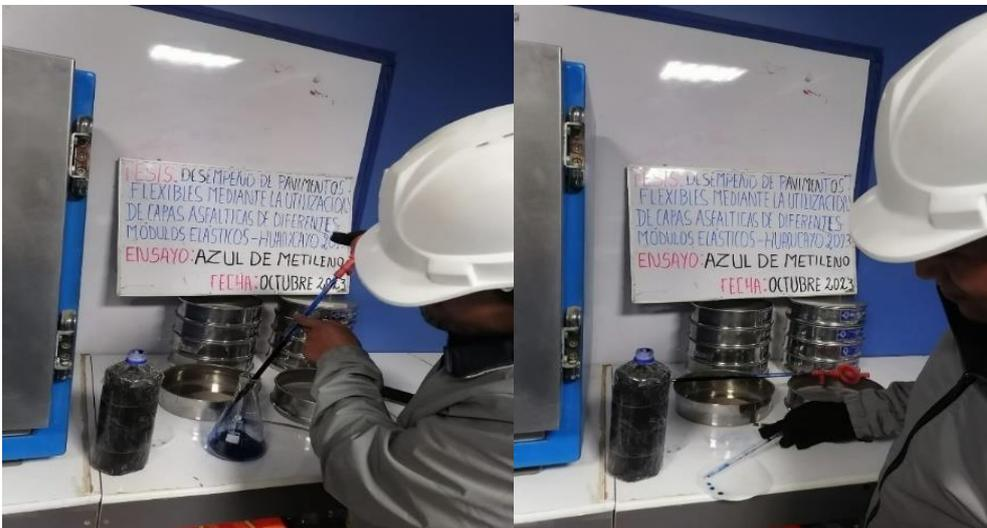
Fotografía 5. Vista de la ejecución del ensayo de azul de metileno.
