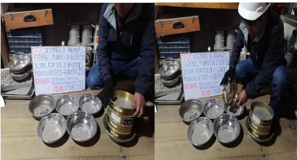
Fotografía 6. Vista de la ejecución del ensayo de durabilidad al sulfato de magnesio.
