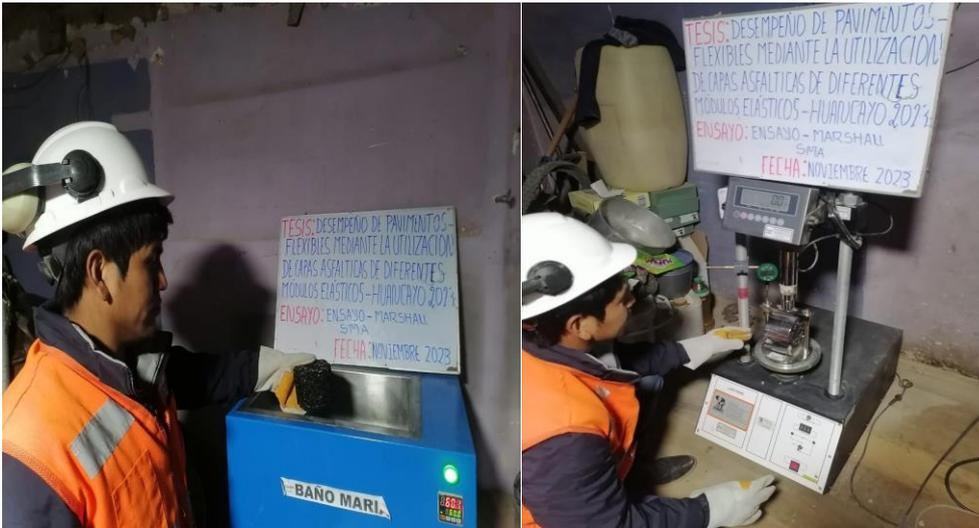
Fotografía 27. Ejecución del ensayo Marshall de la mezcla SMA.
