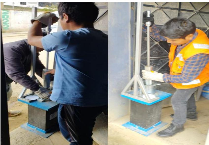
Fotografía 26. Compactado de las mezclas asfálticas SMA.
