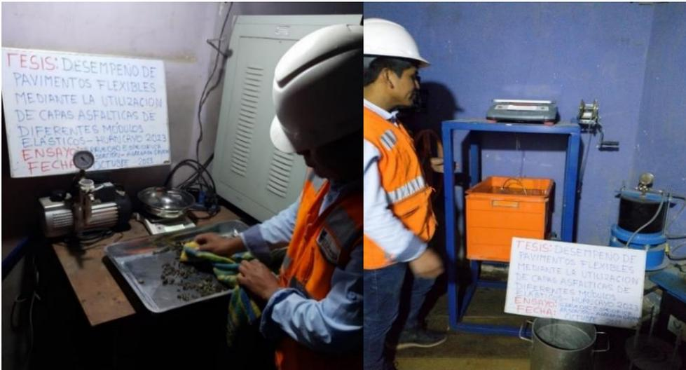
Fotografía 16. Ejecución del ensayo de absorción del agregado grueso.
