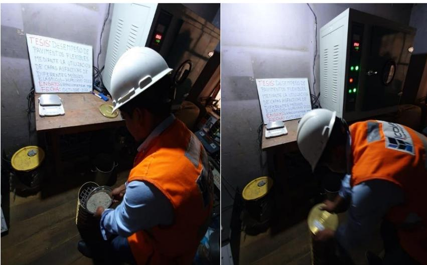
Fotografía 3. Vista del ensayo de granulometría del agregado fino.
