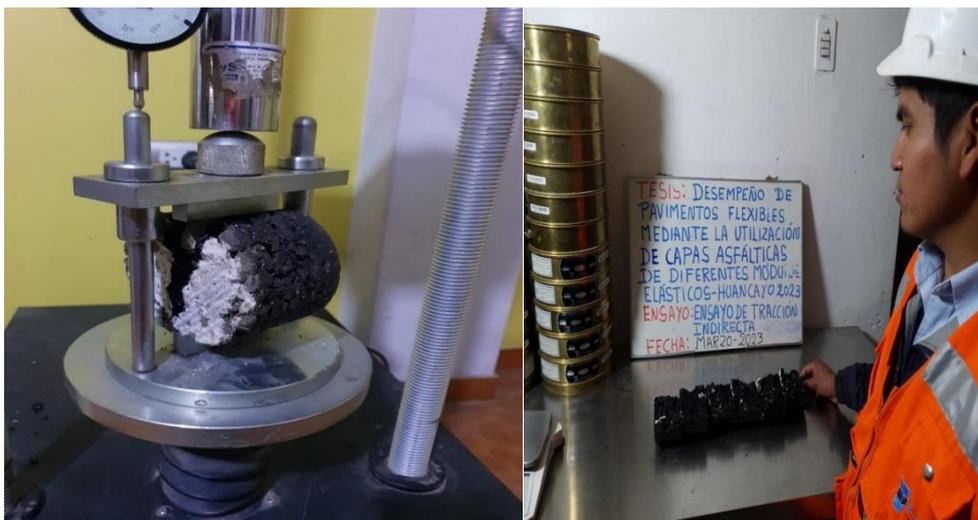
Fotografía 36. Subgrupo seco (especímenes de MAC, SMA y MAC-SMA) ensayados mediante mordaza Lottman.
