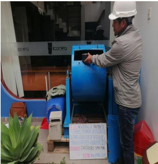
Fotografía 34. Ensayo Cantabro de la mezcla asfáltica convencional y SMA.
