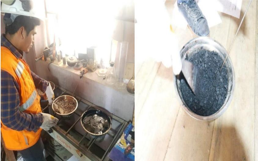
Fotografía 30. Elaboración de la mezcla convencional y SMA.
