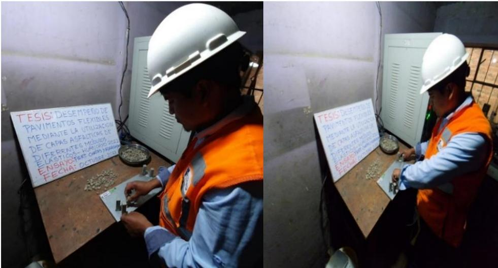
Fotografía 13. Ensayo para determinar las partículas chatas y alargadas.
