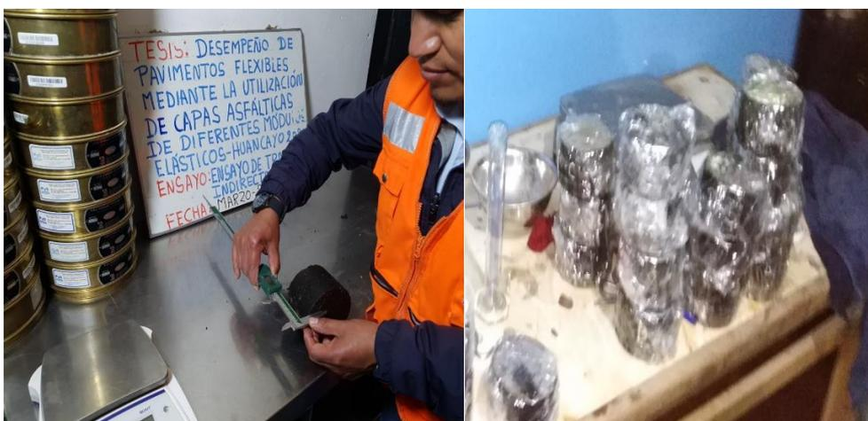
Fotografía 37. Toma de medidas de espesor, diámetro y acondicionamiento del subgrupo acondicionado (especímenes de MAC, SMA y MAC-SMA).
