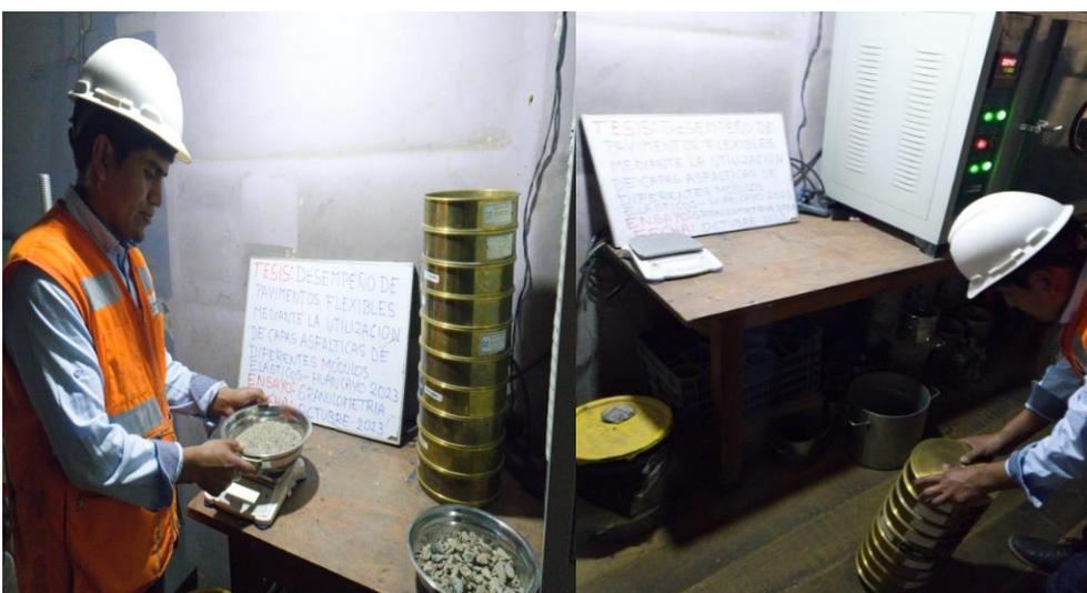
Fotografía 23. Granulometría del agregado fino para la mezcla asfáltica SMA.
