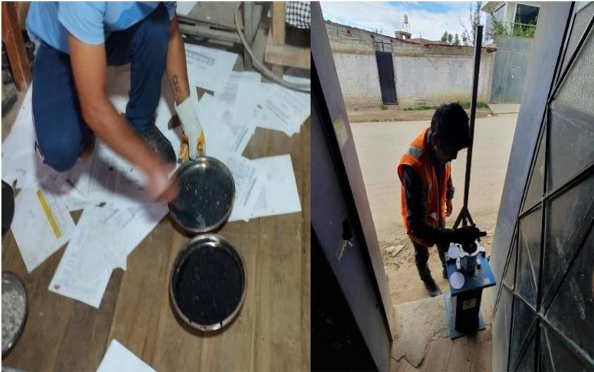
Fotografía 31. Compactación de la mezcla asfáltica convencional y SMA.
