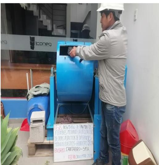
Fotografía 29. Ensayo Cantabro de la mezcla asfáltica SMA.
