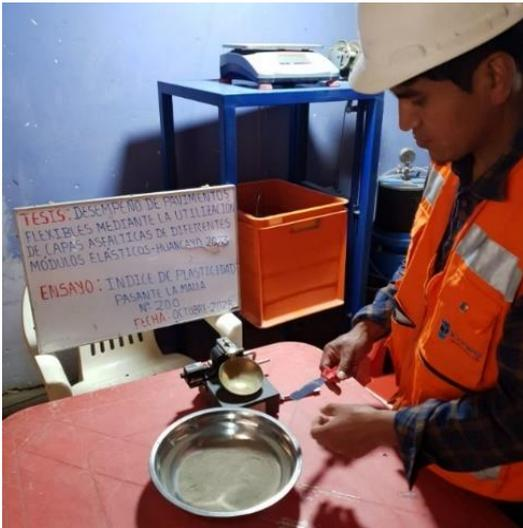
Fotografía 7. Vista de la determinación del índice de plasticidad del agregado fino.
