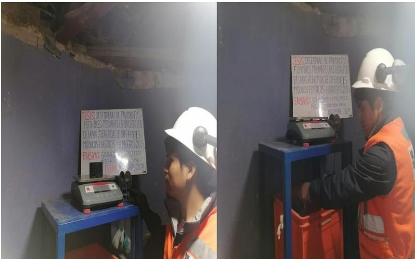
Fotografía 28. Determinación de la gravedad específica de la mezcla asfáltica SMA.
