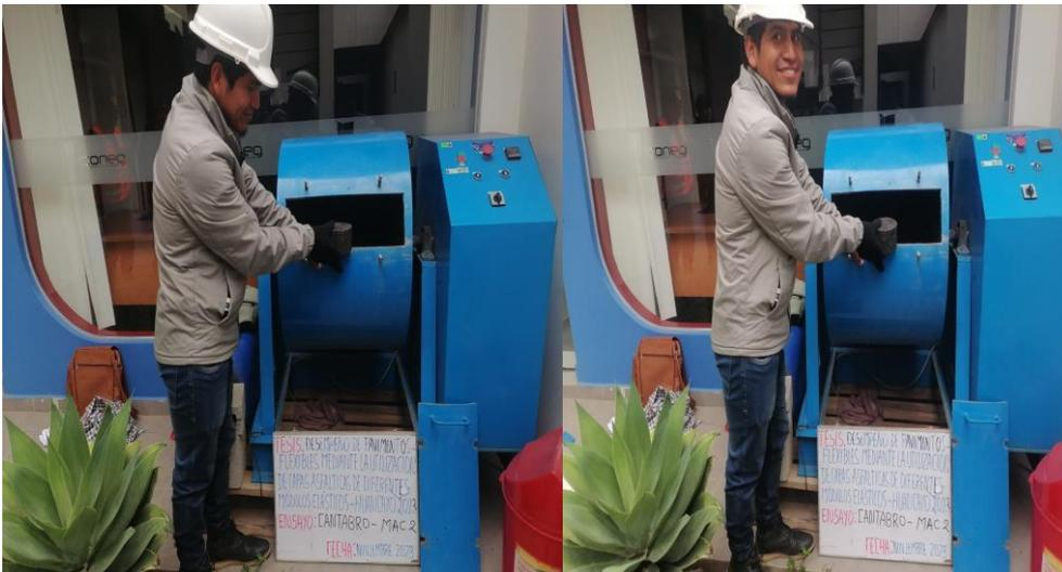
Fotografía 22. Ensayo Cantabro de la mezcla asfáltica en caliente convencional.
