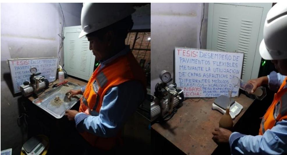
Fotografía 9. Ejecución del ensayo de absorción del agregado fino.
