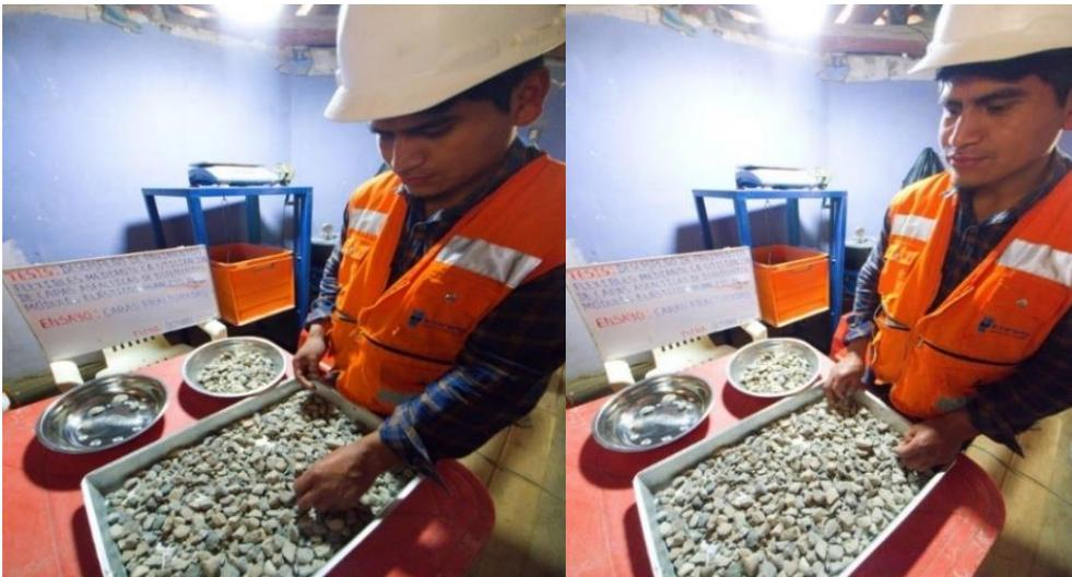
Fotografía 14. Determinación de las caras fracturadas en el agregado grueso.
