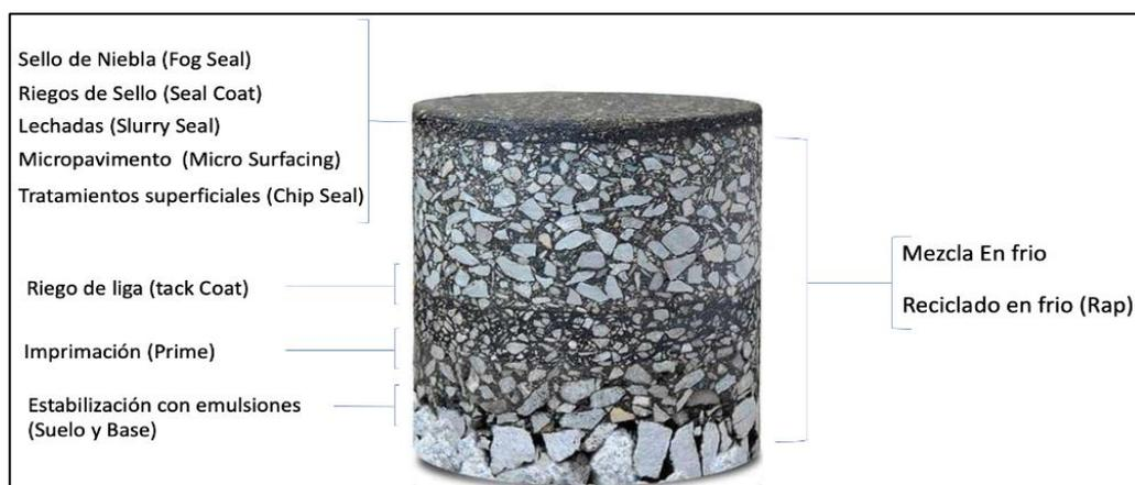
Figura 2.3. Partes del pavimento en la nueva era.
