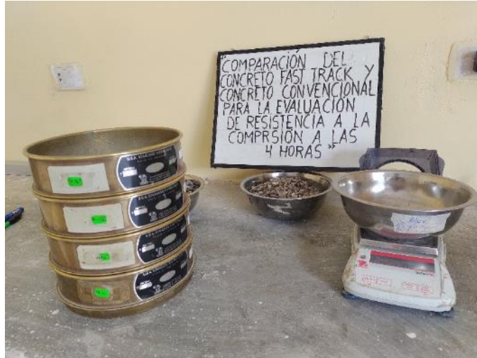
Fotografía N°02: Vista general del proceso de ensayo de granulometría del agregado fino (NTP 339.128).
