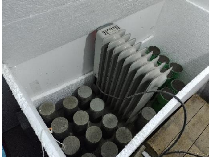
Fotografía N°11: Vista general del proceso de curado de los testigos de concreto tipo fast track.
