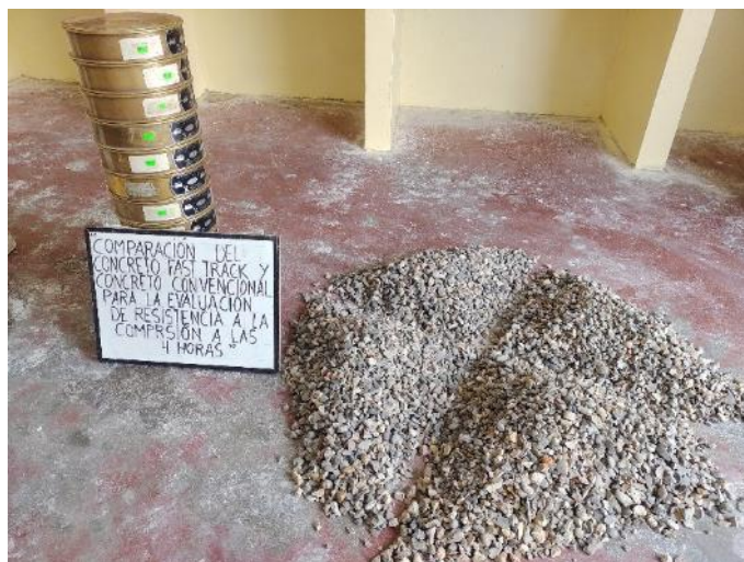
Fotografía N°01: Vista general del proceso de cuarteo del agregado grueso.
