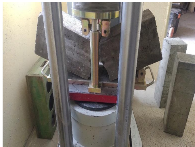
Fotografía N°16: Vista general del ensayo de resistencia a flexión del concreto fast track a las 8 horas.
