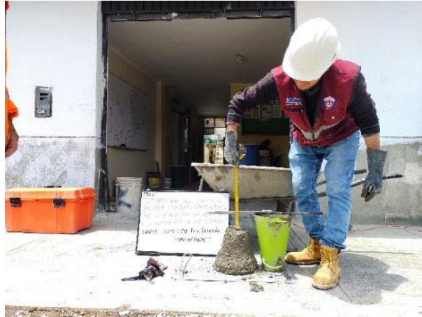
Figura 10 Control de asentamiento del concreto convencional.
