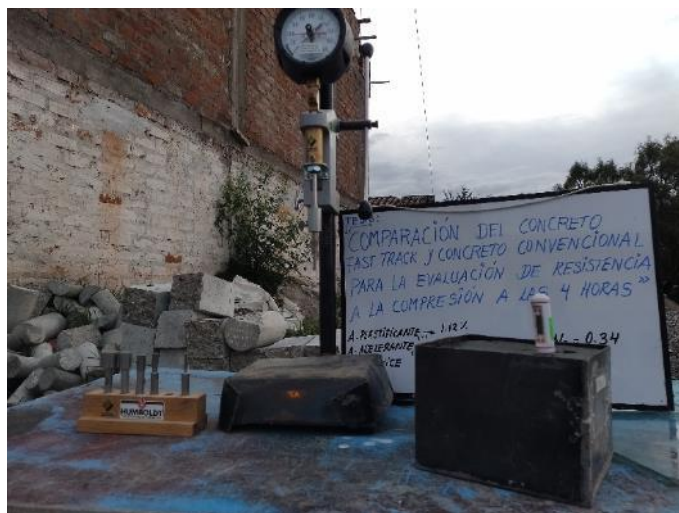
Fotografía N°07: Vista general del ensayo de tiempo de fragua del concreto convencional (NTP 339.082).
