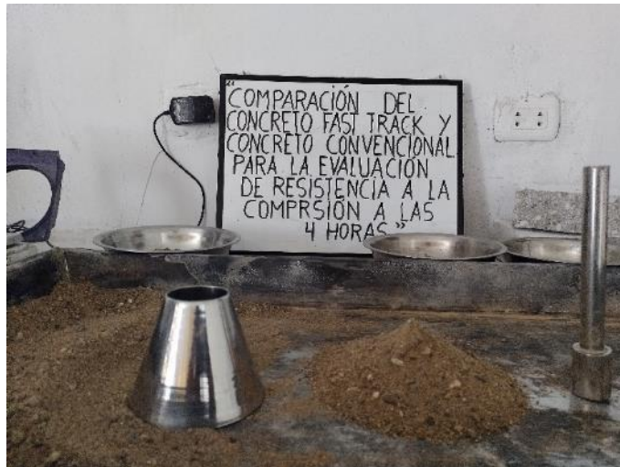
Fotografía N°06: Vista general del ensayo de peso específico del agregado fino (NTP 400.022).
