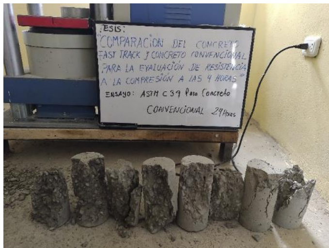
Fotografía N°15: Vista general de los tipos de fallas de los testigos de concreto convencional.
