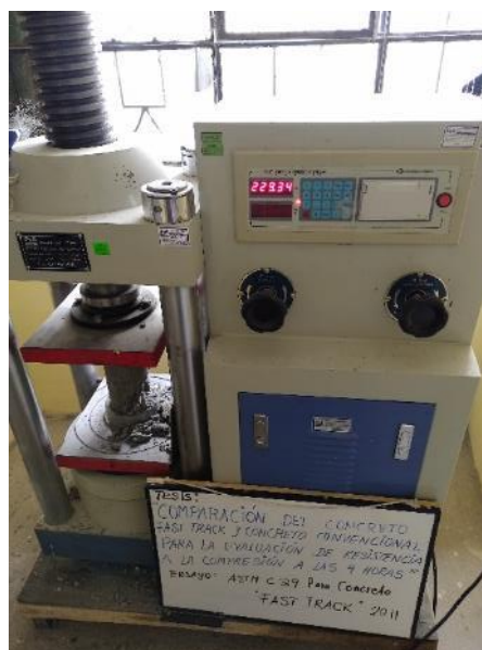
Fotografía N°13: Vista general del ensayo de resistencia a compresión del concreto.
