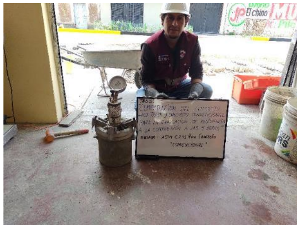
Figura 11 Vista general del ensayo de contenido de aire del concreto convencional en estado fresco.
