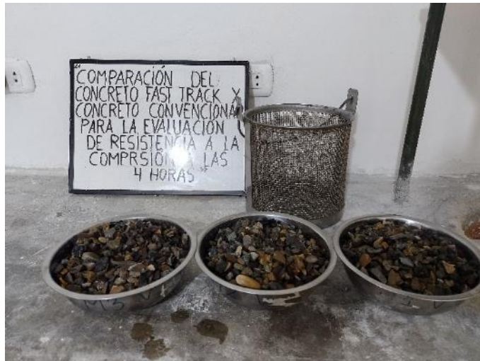
Fotografía N°03: Vista general del ensayo de peso específico del agregado grueso (NTP 400.021).
