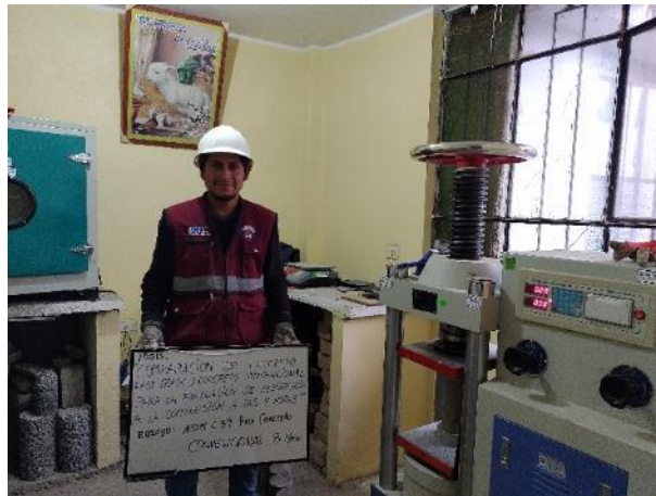
Figura 14 Vista general del ensayo de resistencia a compresión del concreto convencional.
