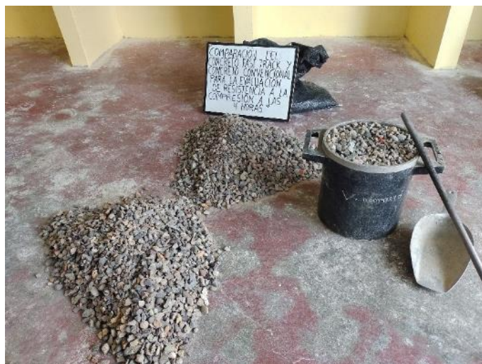
Fotografía N°04: Vista general del ensayo de peso unitario suelto del agregado grueso (NTP 400.017).
