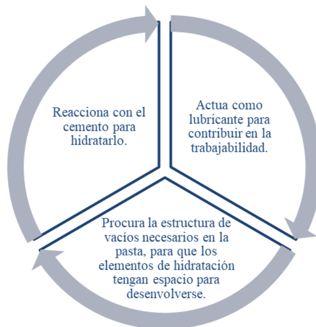
Figura 5 Funciones del agua dentro del concreto. Fuente: Tópicos de tecnología del concreto, de Pasquel (1993).
