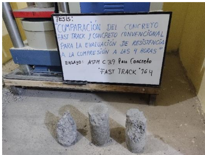
Fotografía N°12: Vista general de los tipos de fallas de los testigos de concreto fast track.
