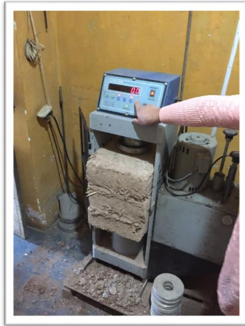
Figura 5: Traslado y montaje de la pila en la celda de ensayo. Fuente: Elaboración propia.
