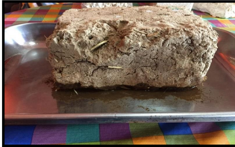
Figura 8: Prueba de Succión en Adobe Convencional. Fuente: Elaboración propia.
