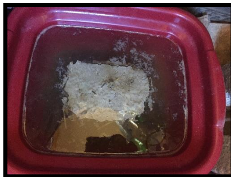
Figura 15: Adobes Impermeabilizados transcurridas las 24 horas. Fuente: Elaboración propia.
