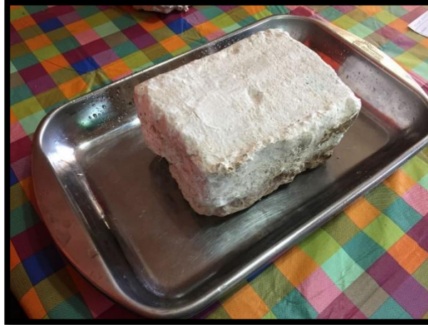
Figura 11: Prueba de Succión en Adobe Impermeabilizado. Fuente: Elaboración propia.
