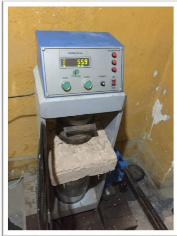
Figura 1: Unidad de adobe sometido a ensayos de compresión. Fuente: Elaboración propia.
