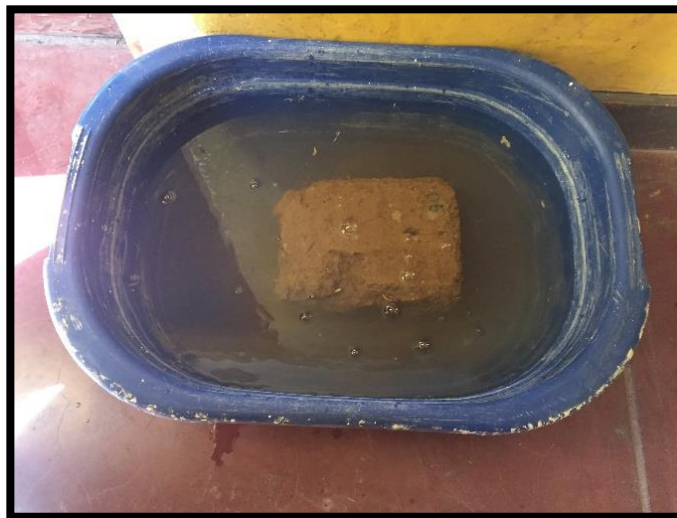
Figura 13: Ensayo de Absorción Adobe convencional. Fuente: Elaboración propia.
