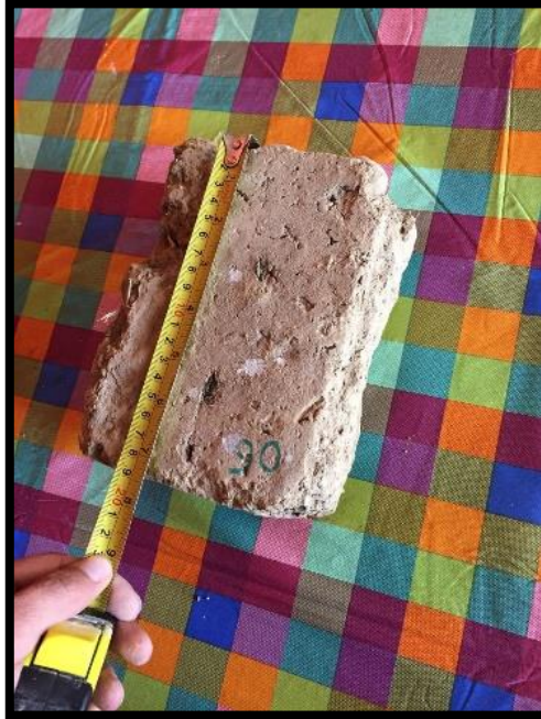
Figura 6: Toma de dimensiones de la muestra. Fuente: Elaboración propia.
