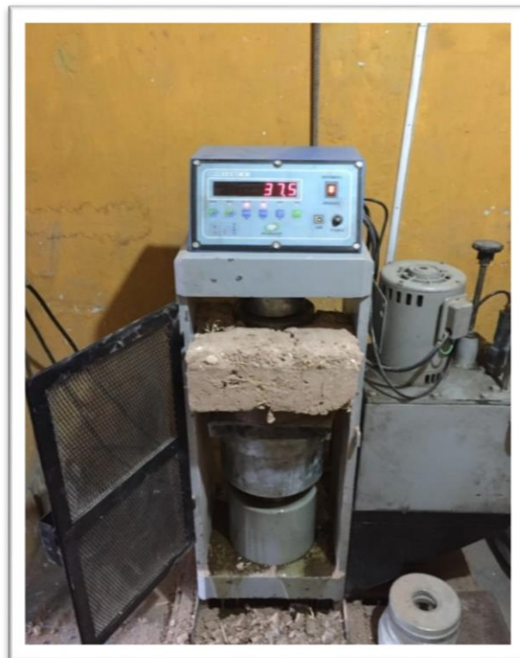
Figura 2: Unidad de adobe sometido a ensayos de compresión. Fuente: Elaboración propia.
