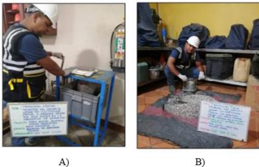
Fotografía N° 2: Evaluación de A) peso específico y absorción, B) PUC y PUS, del AF y del AG.
