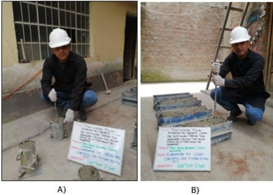
Fotografía N° 7: Elaboración de A) probetas y b) vigas, con piedra pómez al 12 %. De acuerdo a NTP 339.183.
