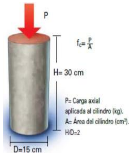
Figura 15: Resistencia a la compresión
