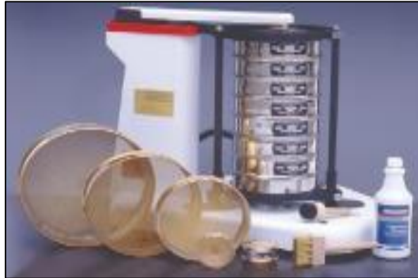
Figura 25: Tamices y equipos para granulometría
