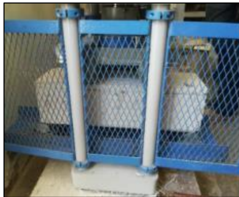
Figura 28: Centrar la viga en la máquina de carga
