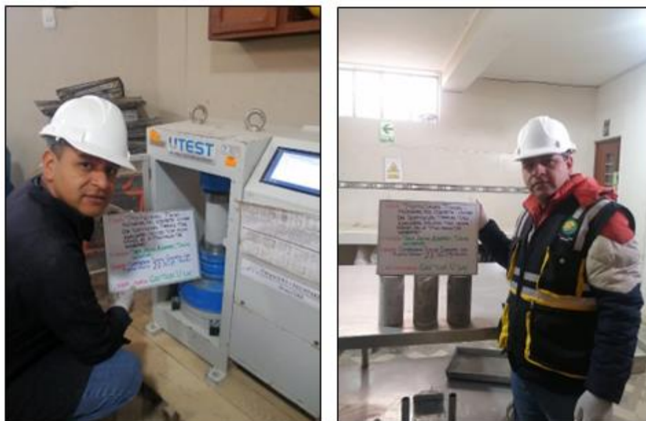
Fotografía N° 18: Ensayo de resistencia a la compresión, 7 días, 14 días, 21 días y 28 días del concreto con 22% de piedra pómez.
