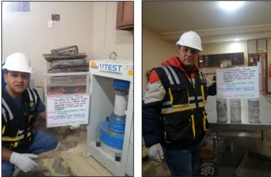
Fotografía N° 15: Ensayo de resistencia a la compresión, 7 días, 14 días, 21 días y 28 días del concreto con 12% de piedra pómez.
