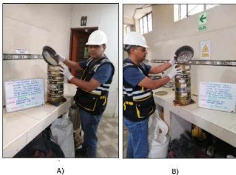
Fotografía N° 1: Tamizado del agregado a) fino y b) grueso
