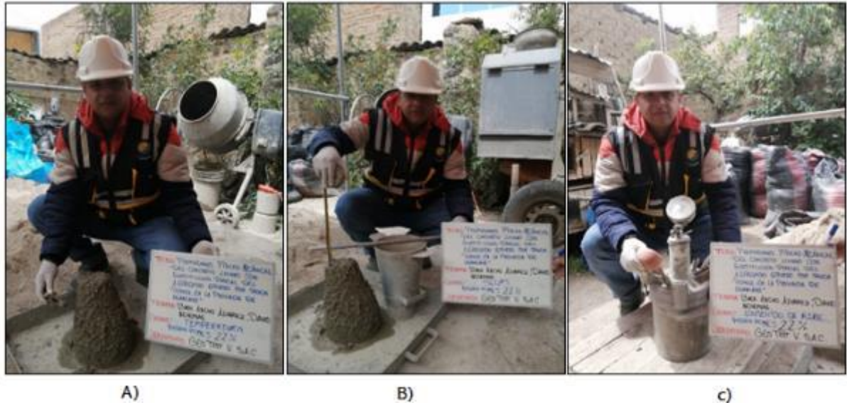
Fotografía N° 11: LAS propiedades en estado fresco es de a) prueba de temperatura, b) asentamiento (Slump) y c) contenido de aire, del concreto con piedra pómez al 22%.
