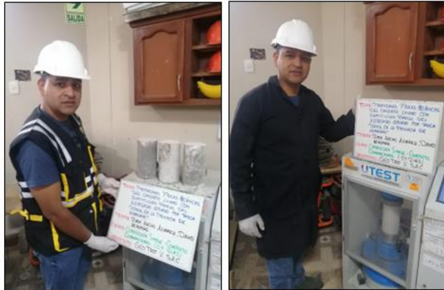
Fotografía N° 13: Ensayo de resistencia a la compresión, 7 días, 14 días, 21 días y 28 días del concreto convencional.
