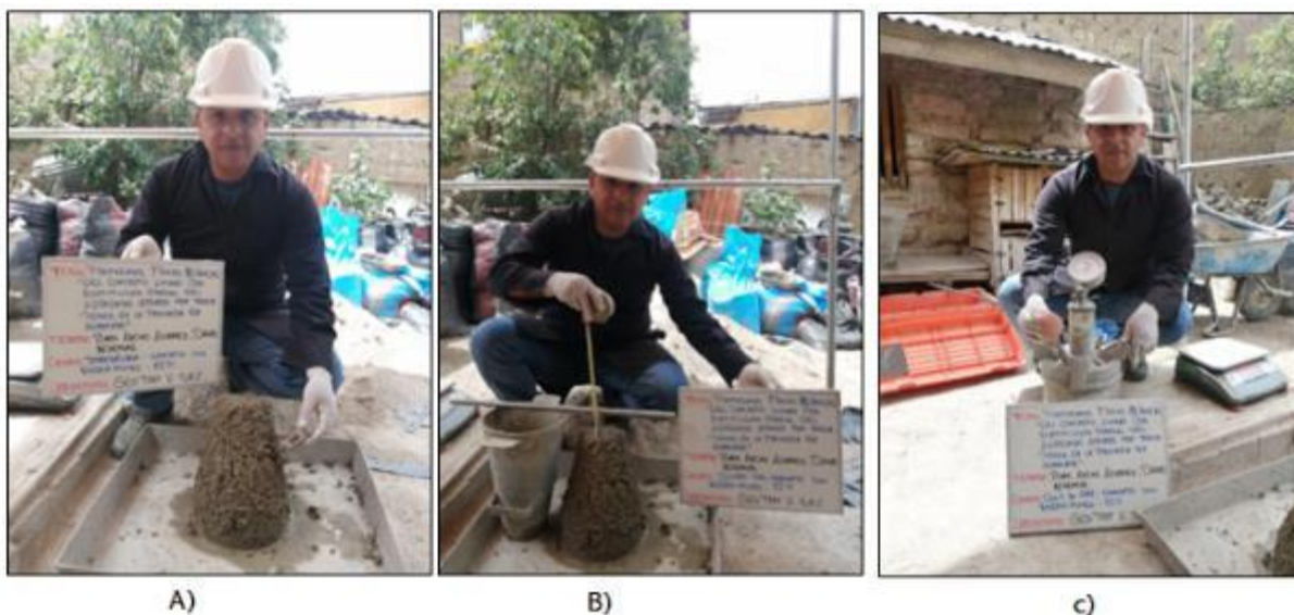
Fotografía N° 6: Medición de a) temperatura, b) asentamiento y c) contenido de aire, empleando piedra pómez al 12%. De acuerdo a NTP 339.184.
