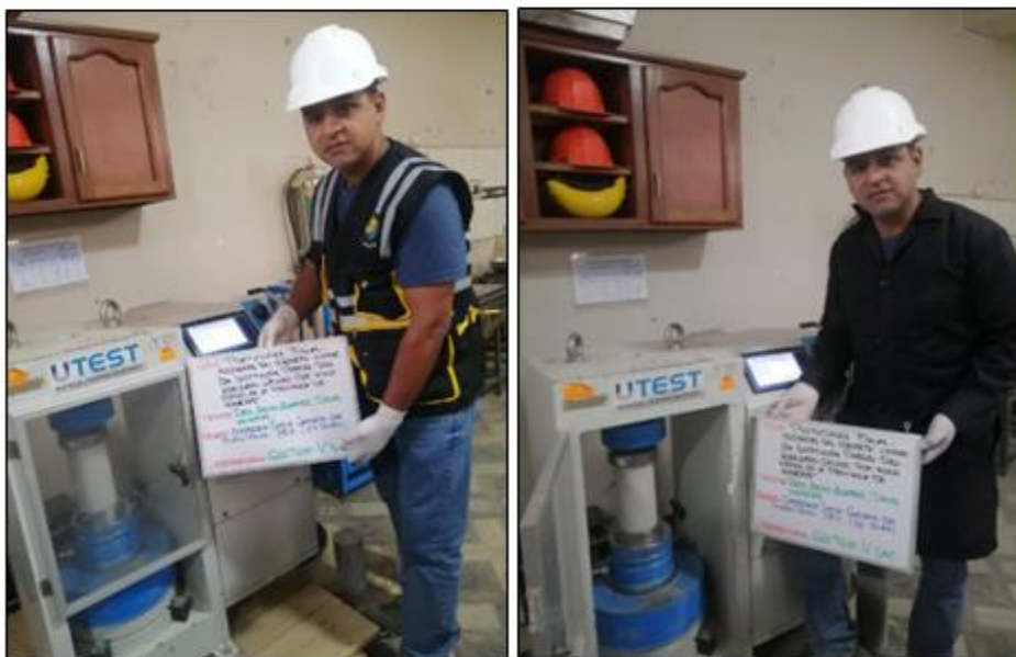
Fotografía N° 16: Ensayo de resistencia a la compresión, 7 días, 14 días, 21 días y 28 días del concreto con 18% de piedra pómez.
