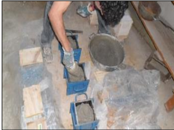
Figura 11: Operación de llenado de los recipientes con mortero de hormigón
