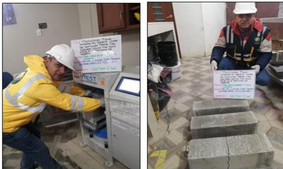
Fotografía N° 17: Ensayo de resistencia a la flexión (valor del MR) 7 días, 14 días, 21 días y 28 días del concreto con 22% de piedra pómez.
