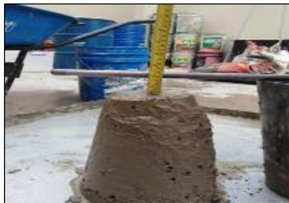
Figura 10: Ensayo Slump (trabajabilidad)
