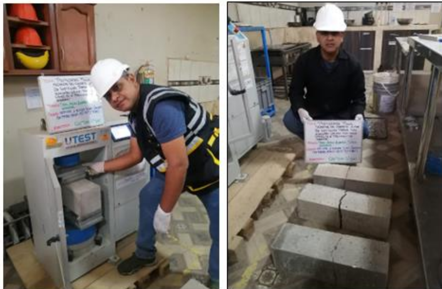
Fotografía N° 14: Ensayo de resistencia a la flexión (valor del MR) 7 días, 14 días, 21 días y 28 días del concreto con 12% de piedra pómez.
