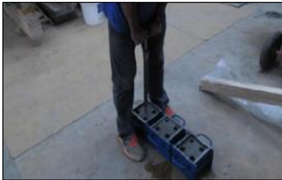
Figura 13: Medición de penetración para determinación del tiempo de fraguado
