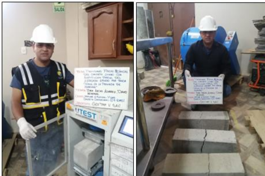
Fotografía N° 12: Ensayo de resistencia a la flexión 7 días, 14 días, 21 días y 28 días del concreto convencional.
