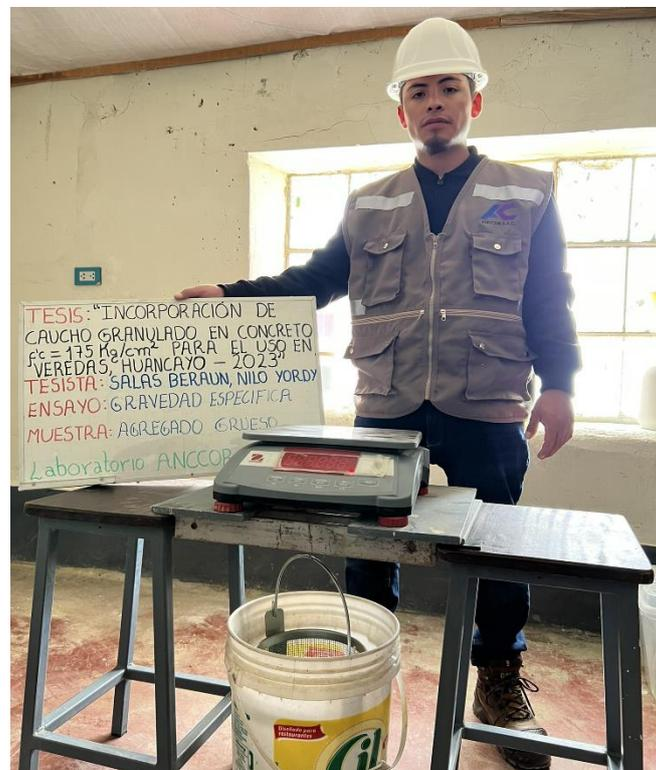
Gravedad específica y % de absorción del agregado grueso
