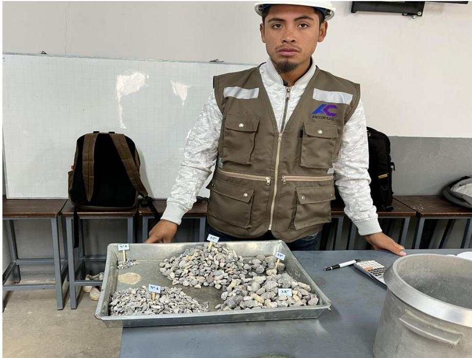
Análisis Granulométrico del agregado grueso
