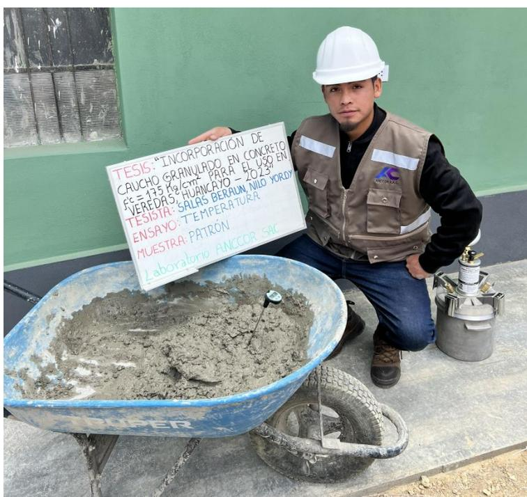
Ensayo de concreto fresco - temperatura
