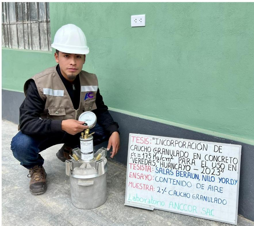
Contenido de aire del concreto con adición del 2% de caucho granulado (olla de Washington)
