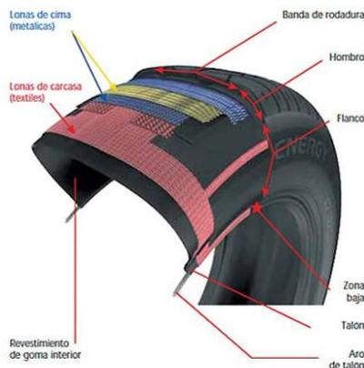
*Figura 6.2.* Partes de una llanta, Bridgestone (2020)
