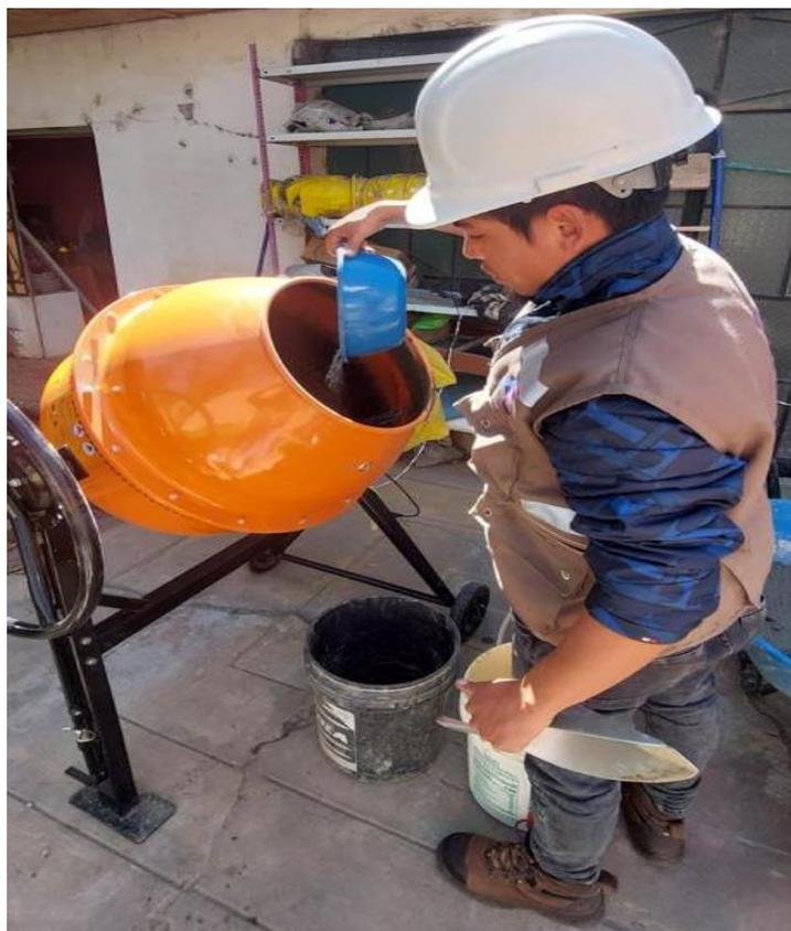
Adición del caucho granulado en porcentajes de 2%, 5% y 8% en concreto  $f'c = 175 \text{ kg/cm}^2$
