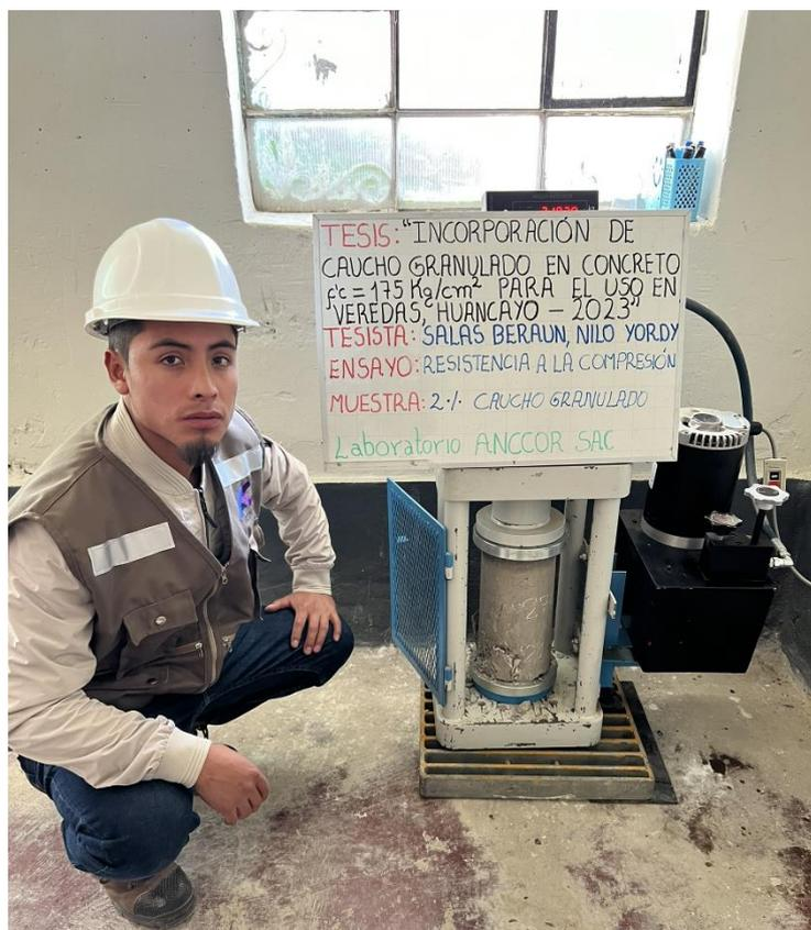
Resistencia a la compresión del concreto  $f'c = 175 \text{ kg/cm}^2$  con la adición del 2%, 5% y 8% de caucho granulado
