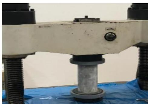
Figura 10.2. Rotura del testigo de concreto, Hernández et al. (2018)
