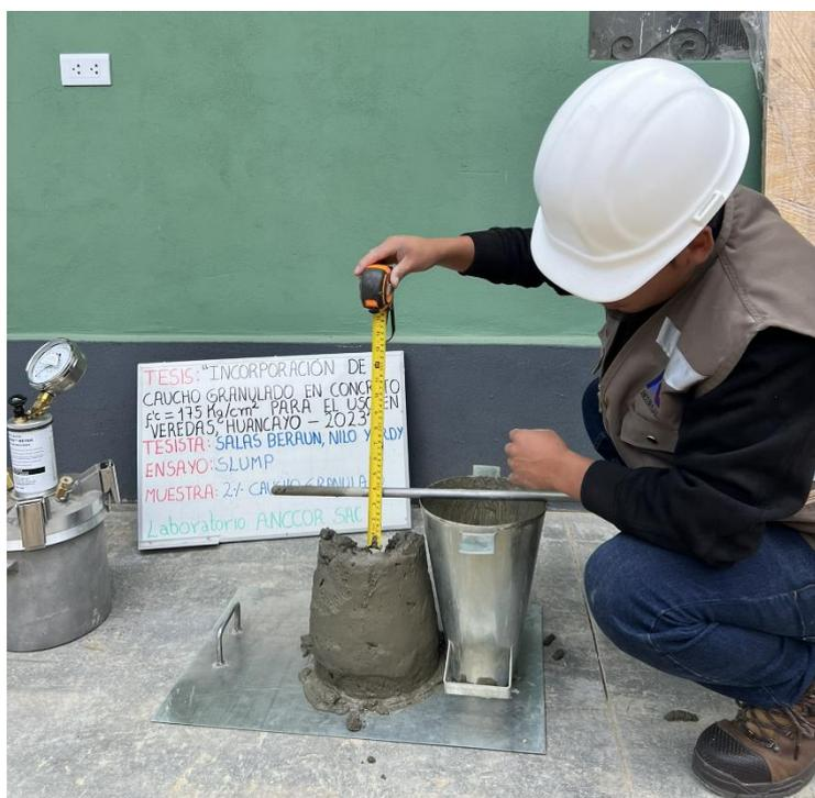
Slump del concreto  $f_c = 175 \text{ kg/cm}^2$  con adición del 2% de caucho granulado
