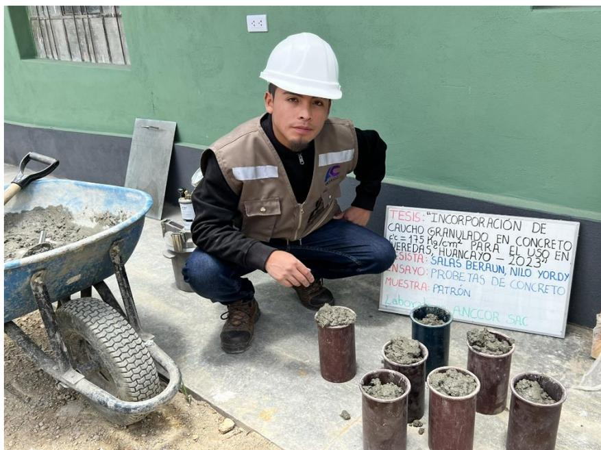
Elaboración de las probetas de concreto con la adición de caucho granulado en 2%, 5% y 8%
