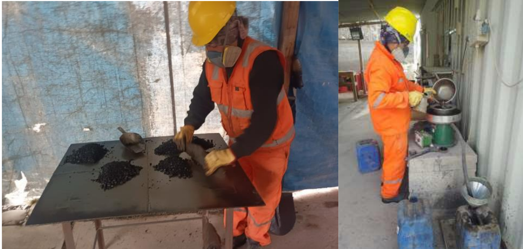
Fotografía N° 02 - Retiro de la Muestra y Secado de la Muestra.
