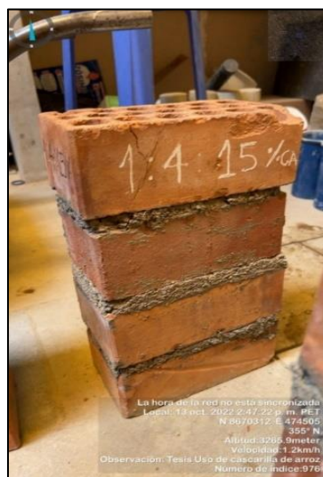
Figura 25 Rotura de prisma de 15%
