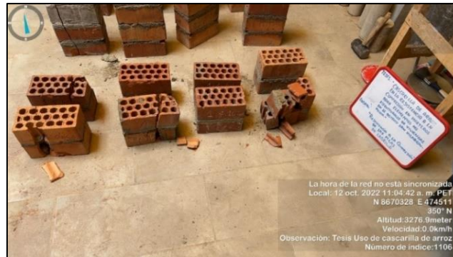
Figura 17 Rotura de prismas de dos pilas de 0%, 5% , 10% y 15%
