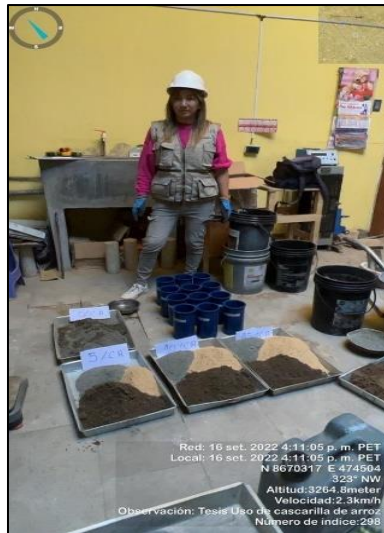
Figura 26. Elementos de la mezcla de concreto para probeta
