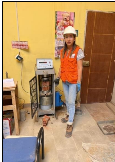
Figura 15 Rotura de prisma de dos pilas a los 14 días
