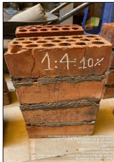
Figura 24 Rotura de prisma de 10%
