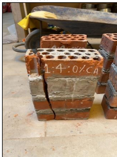
Figura 22 Rotura de prisma de 0%
