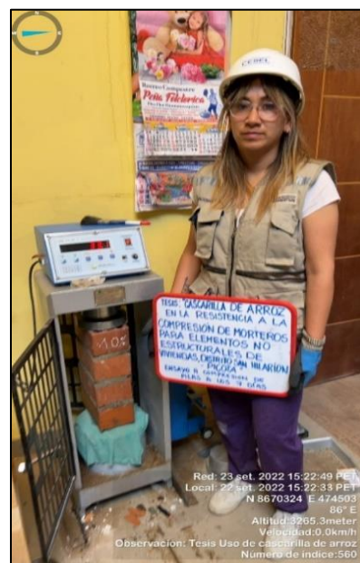
Figura 16 Rotura de prisma de 4 pilas con porcentaje de sustitución de 10% a los 14 días
