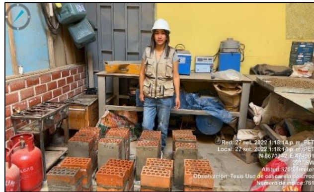
Figura 14 Prismas en proceso de curado
