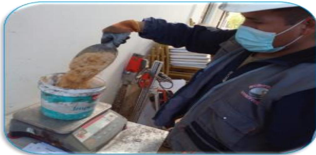
Figura 12 *Proceso del pesado de agregados de aserrín, poliestireno expandido, piedra chancada, agregado grueso y agua de acuerdo al diseño mezcla tanto para el diseño de mezcla del patrón, diseño de mezcla con la incorporación del 3,5 % de aserrín y luego 0.5,1%*
