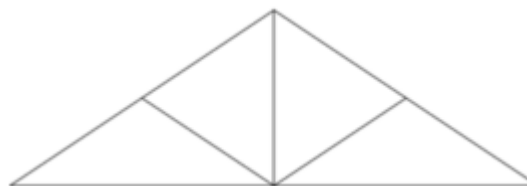
Figura 19 – Armadura de montante maestro.
