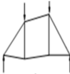
Figura 15 – Armadura – falla por cargas asimétricas.
