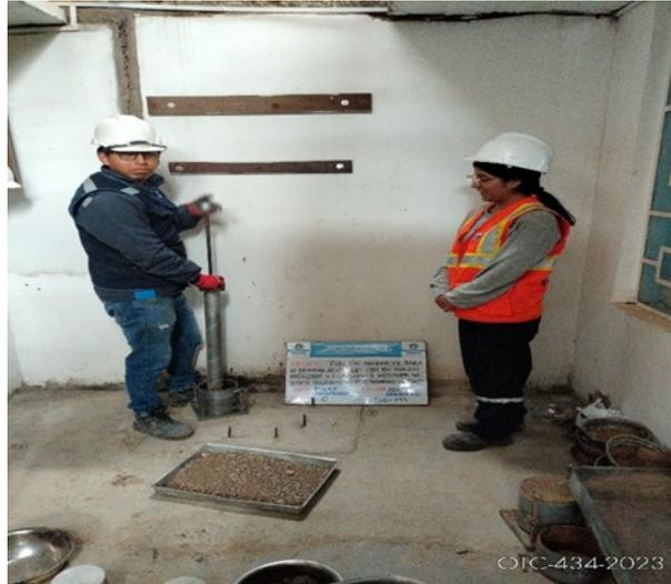
Fotografía 28. Se realizó la compactación de Proctor modificado al suelo arcilloso – granular.
