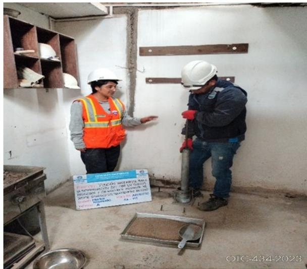
Fotografía 32. Se realizó el ensayo de Proctor modificado al suelo arcilloso, así como de los demás materiales sus 15 repeticiones.
