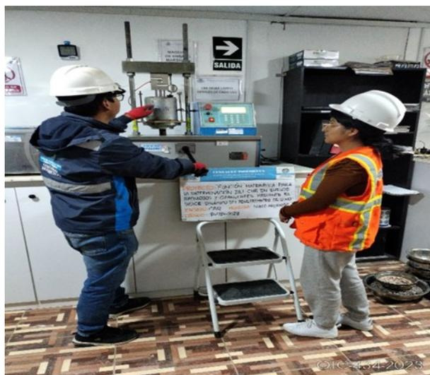
Fotografía 36. Se continuo hasta culminar los 45 ensayos de CBR en laboratorio.
