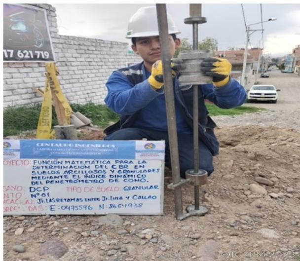
Fotografía 6. Se tomaron las medidas de penetración de los puntos de DCP realizados por el analista del laboratorio.
