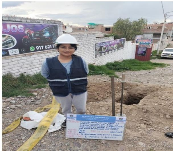
Fotografía 5. Realizamos los 15 puntos de DCP alrededor de la calicata realizada.
