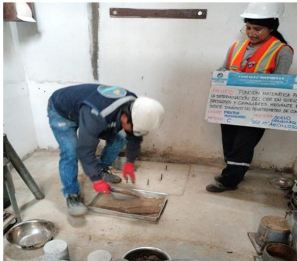
Fotografía 29. Se realizó el compactado por capas del Proctor modificado al suelo arcilloso – granular.
