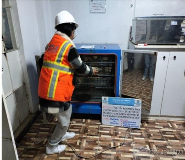
Fotografía 25. Se realizó los ensayos de contenido de humedad del suelo granular y el arcilloso.
