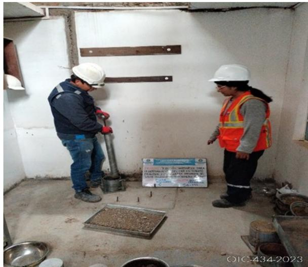
Fotografía 27. Se realizó el ensayo de Proctor modificado al suelo arcilloso – granular.
