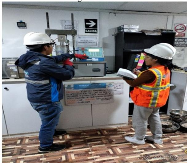
Fotografía 35. Se apoyo en la toma de datos de cada uno de los datos arrojados por el equipo de CBR.
