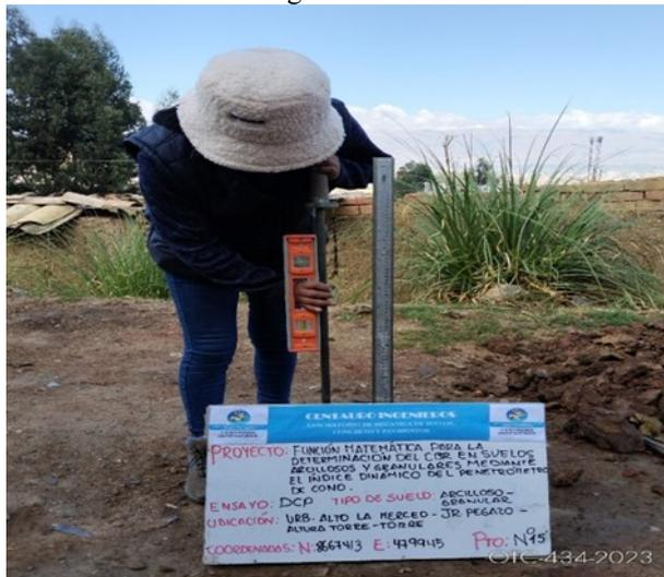
Fotografía 9. Se realizaron los 15 puntos de DCP alrededor de la calicata realizada.
