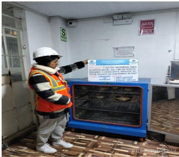
Fotografía 26. Se realizó los ensayos de contenido de humedad del suelo arcilloso - granular.
