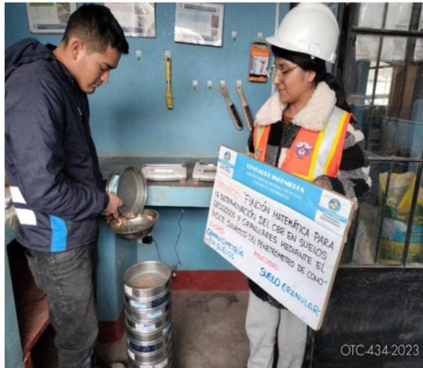
Fotografía 19. Se realizaron las granulometrías del suelo arcilloso - granular.
