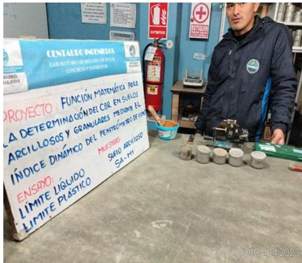
Fotografía 24. Se realizó los ensayos de límite líquido y límite plástico del suelo arcilloso.
