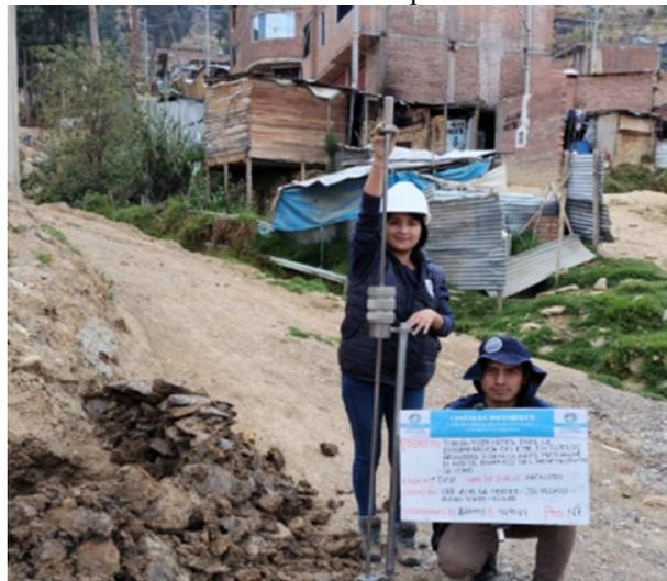
Fotografía 14. Se inició con el ensayo de DCP con apoyo del analista del laboratorio INGECIN SAC.
