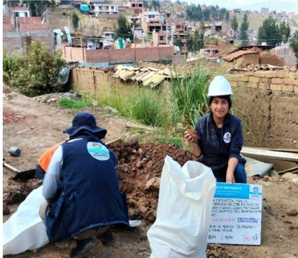
Fotografía 10. Se procedió con el llenado de material para realizar los 15 paquetes de CBR en laboratorio.
