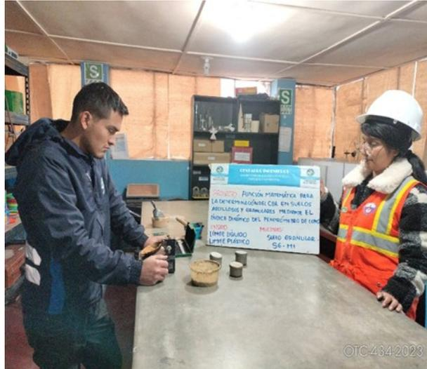
Fotografía 22. Se realizó los ensayos de límite líquido y límite plástico del suelo granular.
