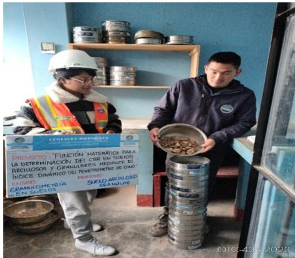
Fotografía 20. Se realizaron las granulometrías del suelo granular.
