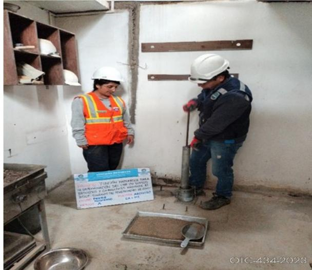
Fotografía 31. Se realizó el ensayo de Proctor modificado al suelo arcilloso.
