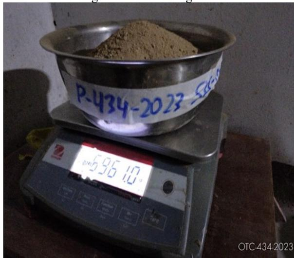
Fotografía 17. Se pesaron las muestras para proceder con los ensayos de laboratorio CBR.
