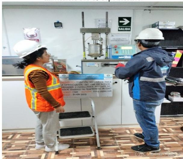
Fotografía 33. Se procedió con los ensayos de CBR en etapa de penetración de las muestras.
