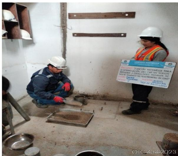
Fotografía 30. Se realizó el compactado de los 15 ensayos de Proctor modificado al suelo arcilloso – granular.
