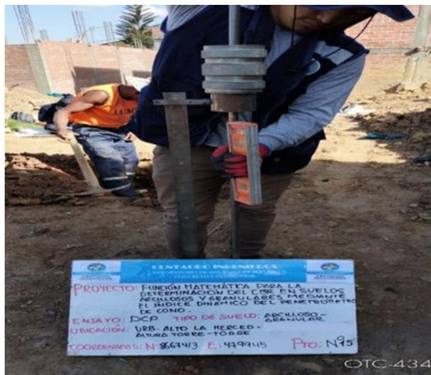
Fotografía 11. Se procedió a la culminación de los 15 puntos de DCP en el suelo arcilloso - granular intencionalmente buscado.
