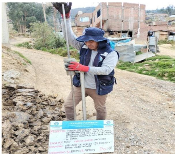
Fotografía 15. Se culminó con los 15 puntos de DCP realizados alrededor de la calicata realizada en el suelo arcilloso.
