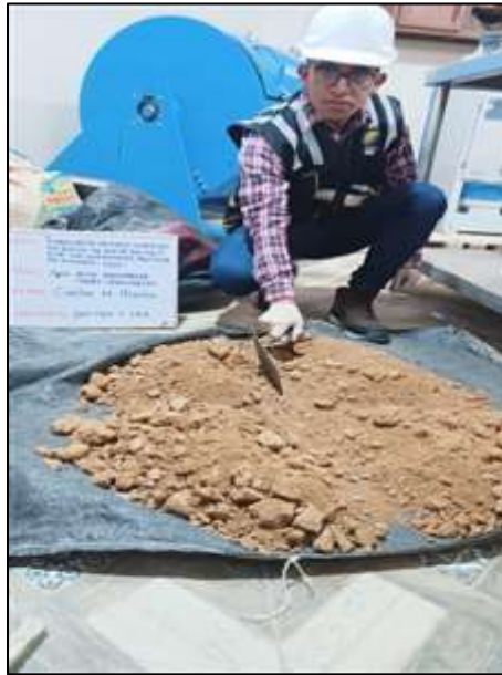
Fotografía N° 3: Obtención en laboratorio de muestras representativas (cuarteo), según referencia de la norma MTC E 105.
