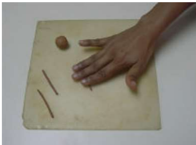
Figura 22. Elaboración de muestras tubulares de 2.5 mm de diámetro para el cálculo del LP
