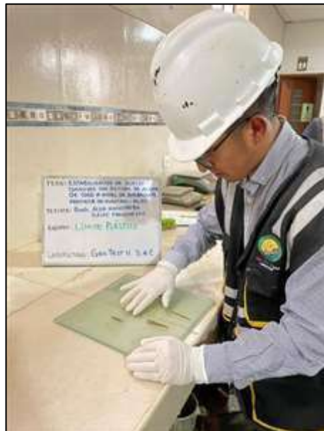
Fotografía N° 6: Ensayo de Limite plástico con muestra de control, según referencia de la norma MTC E 111.
