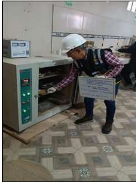
Fotografía N° 1: Determinación de la obtención del contenido de humedad del suelo, según referencia de la norma MTC E 108.
