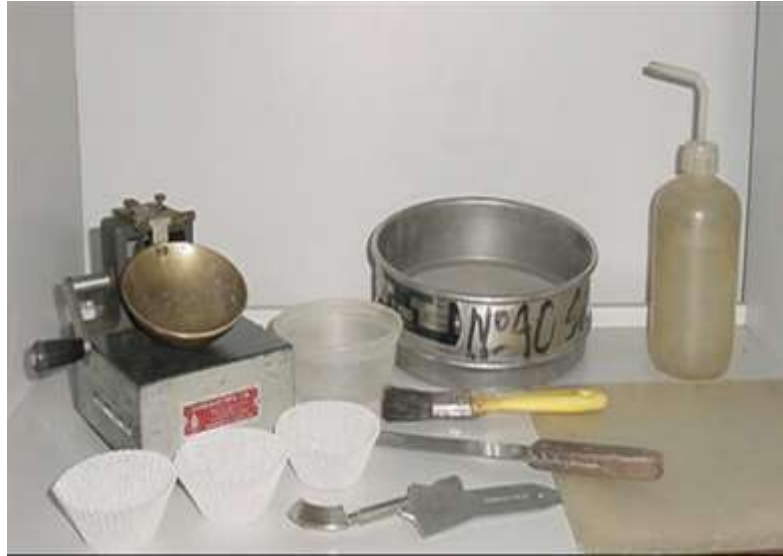
Figura 20. Materiales empleados para los ensayos de límites de consistencia. Nota: “Evaluación de los límites de Atterberg de un suelo”, por LANAVIAL (2003)
