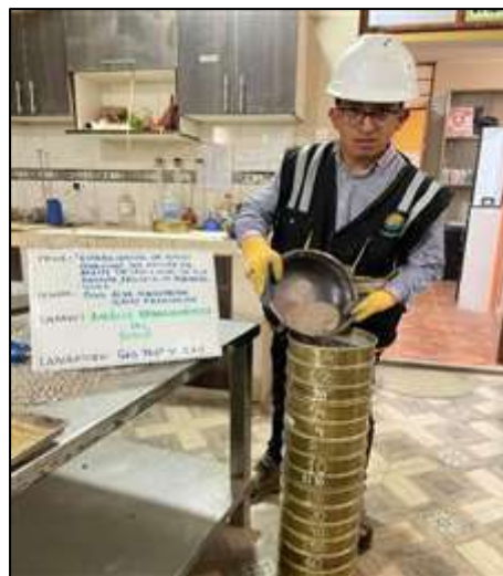
Fotografía N° 4: Ensayo de análisis granulométrico del material arcilloso, separación de material por tamaño de partículas método de tamizado, según referencia de la norma MTC E 107.
