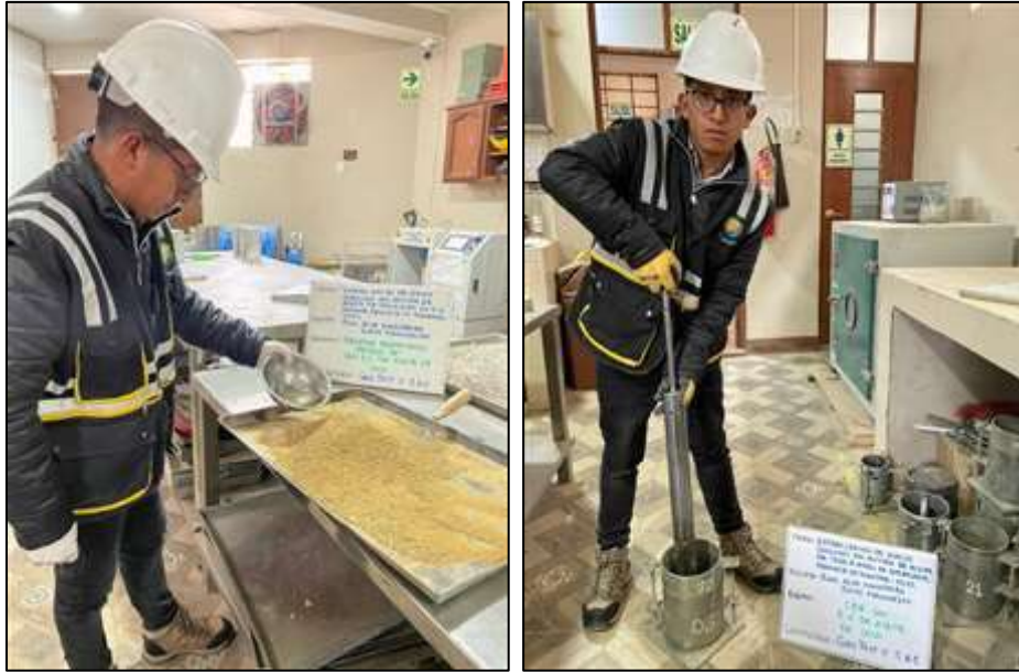
Fotografía N° 14: Homogenización de suelo con +5 % de aceite y proceso de compactación.
