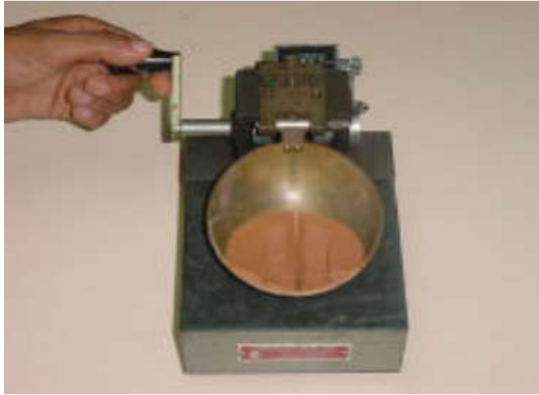
Figura 21. Secuencia de golpes en la copa de casa grande para el cálculo de Limite Liquido.
