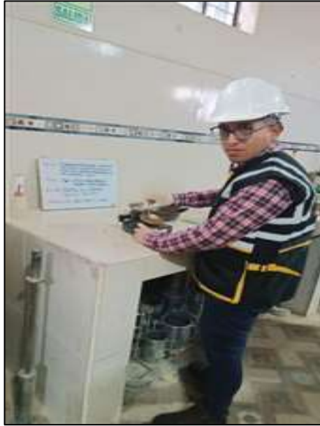
Fotografía N° 5: Ensayo de limite líquido con muestra convencional, según referencia de la norma MTC E 110.
