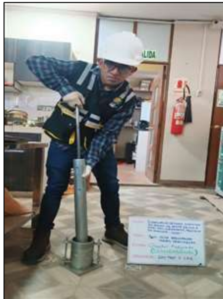
Fotografía N° 8: Apisonamiento del material convencional dentro del molde en 5 capas, en un molde con 25 golpes, según referencia de la norma MTC E 115.
