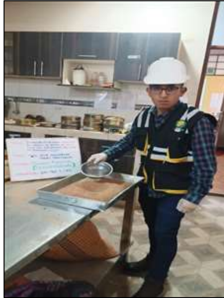
Fotografía N° 7: Homogenización del material convencional, según referencia de la norma MTC E 115.
