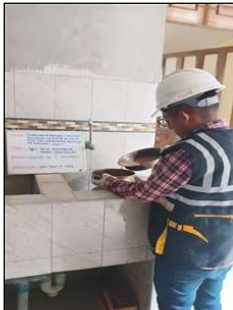
Fotografía N° 2: Ensayo del material más fino que pasa por el tamiz N°200, según referencia de la norma MTC E 202.
