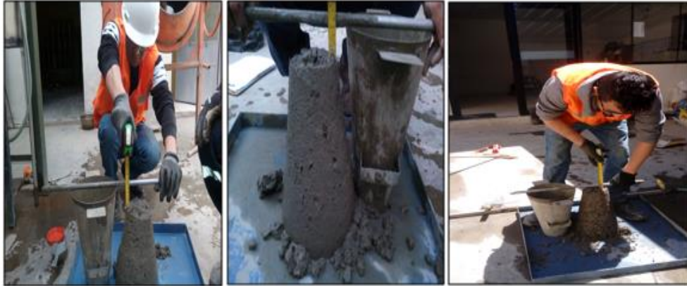
Figura 18. Asentamiento del concreto Fuente: Elaboración propia.
