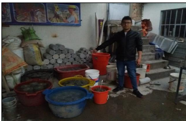
Figura 22. Curado de especímenes de concreto. Fuente: Elaboración propia.
