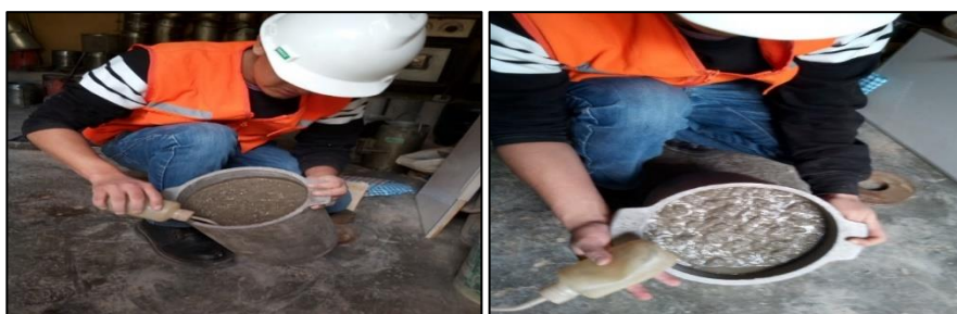
Figura 19. Exudación del concreto.
