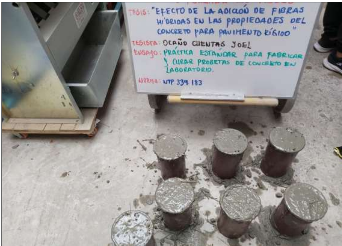
Figura 36. Muestreo de probetas de concreto con fibras híbridas en laboratorio.
