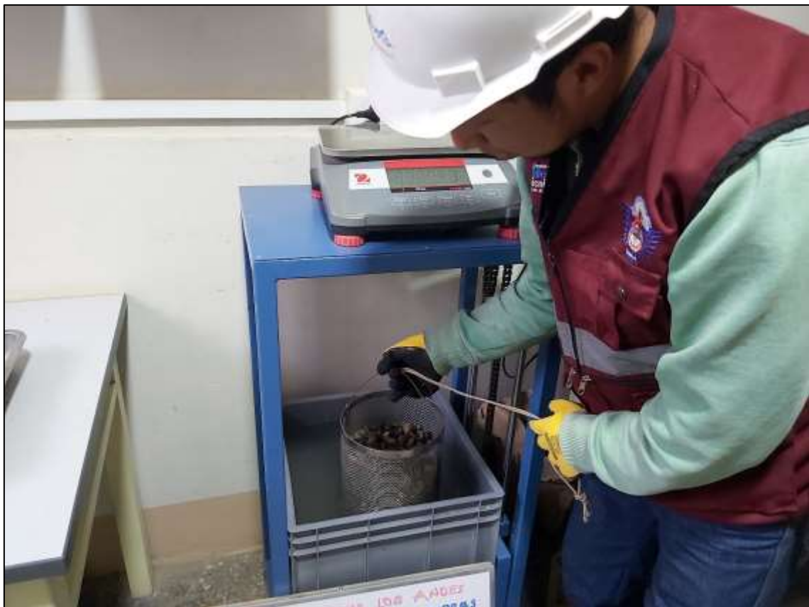
Figura 46. Prueba para la gravedad específica y absorción del agregado grueso.
