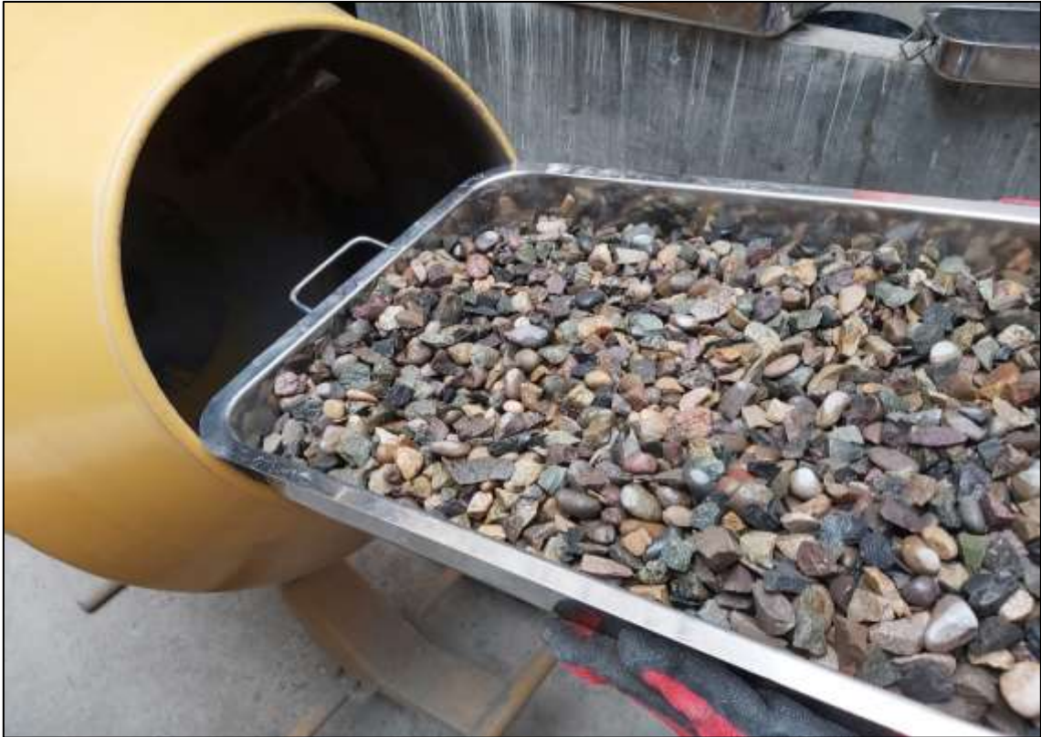
Figura 30. Vertido de agregado grueso a máquina mezcladora.
