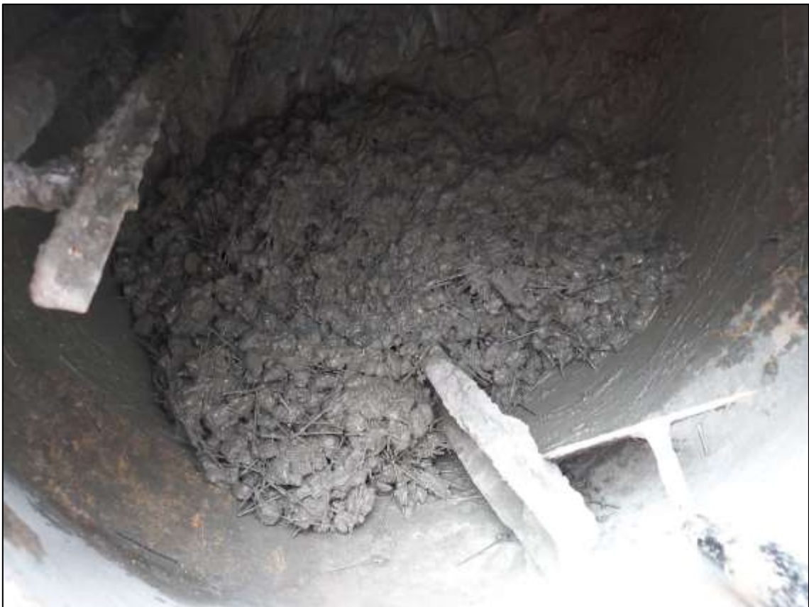
Figura 32. Vertido de fibra de tereftalato polietileno a máquina mezcladora.
