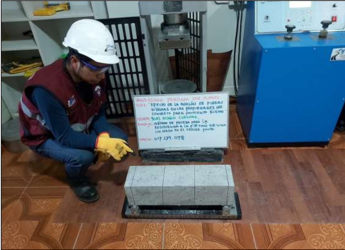
Figura 20. Método de prueba para la resistencia a flexión de viga con cargas en el tercer punto.
