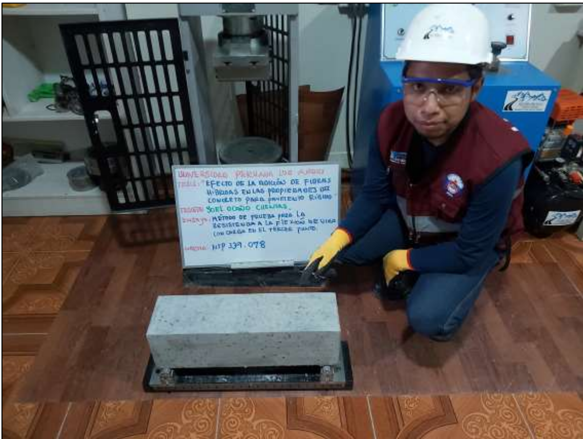
Figura 20. Método de prueba para la resistencia a flexión de viga con cargas en el tercer punto.
