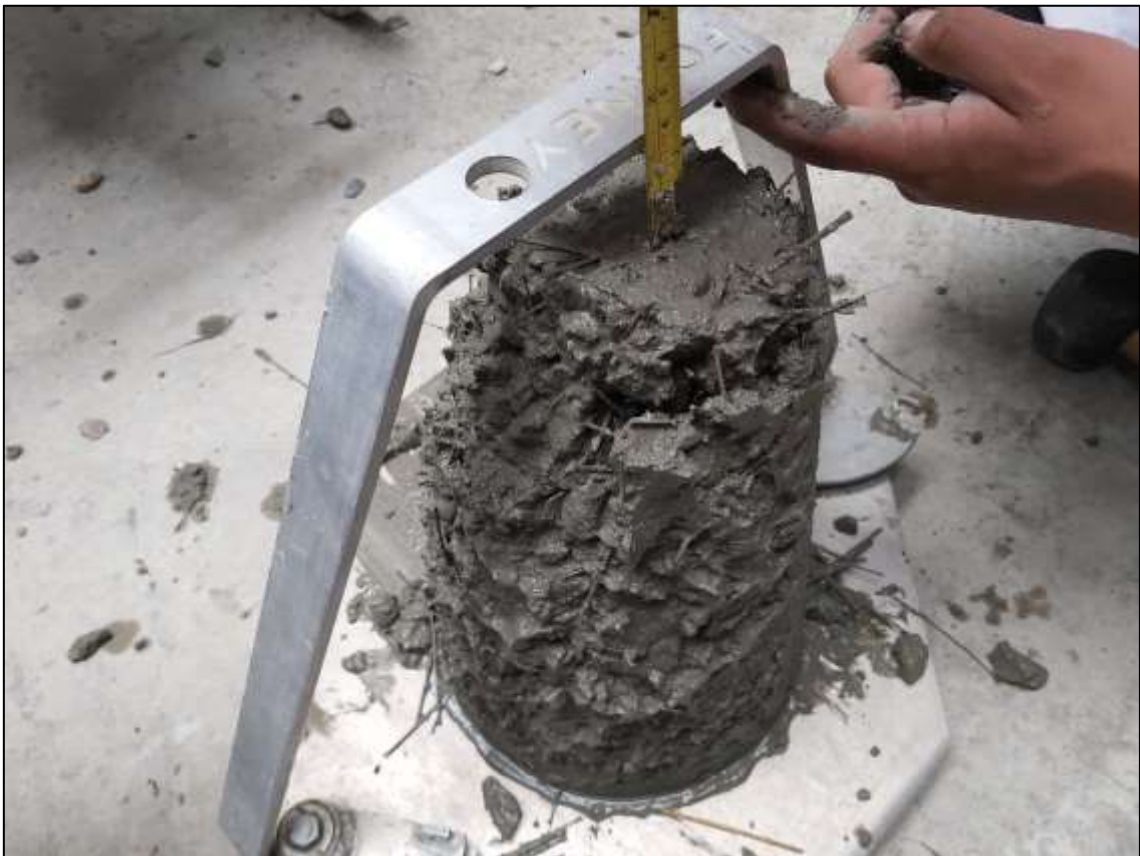
Figura 25. Lectura del ensayo de revenimiento de concreto con adición de fibras híbridas.
