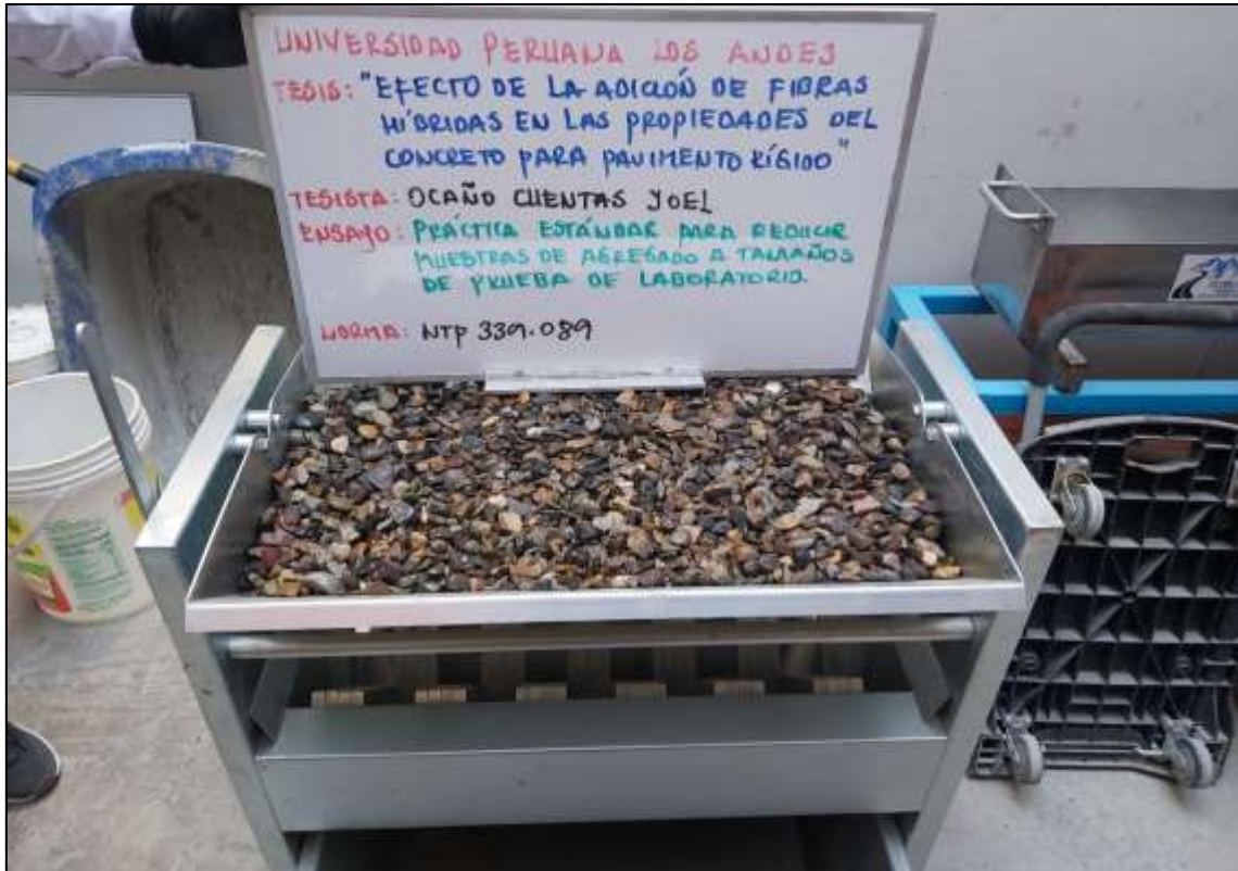
Figura 38. Practica estándar para reducir muestras de agregados a tamaños de prueba de laboratorio.
