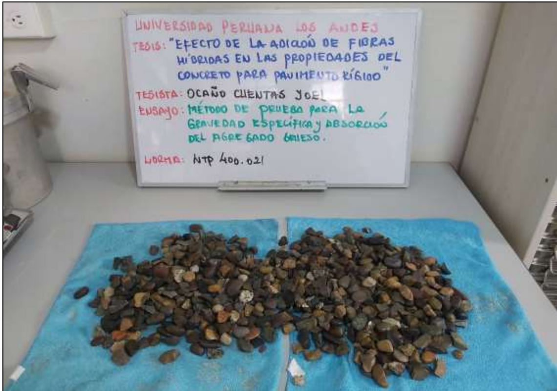
Figura 46. Prueba para la gravedad específica y absorción del agregado grueso.
