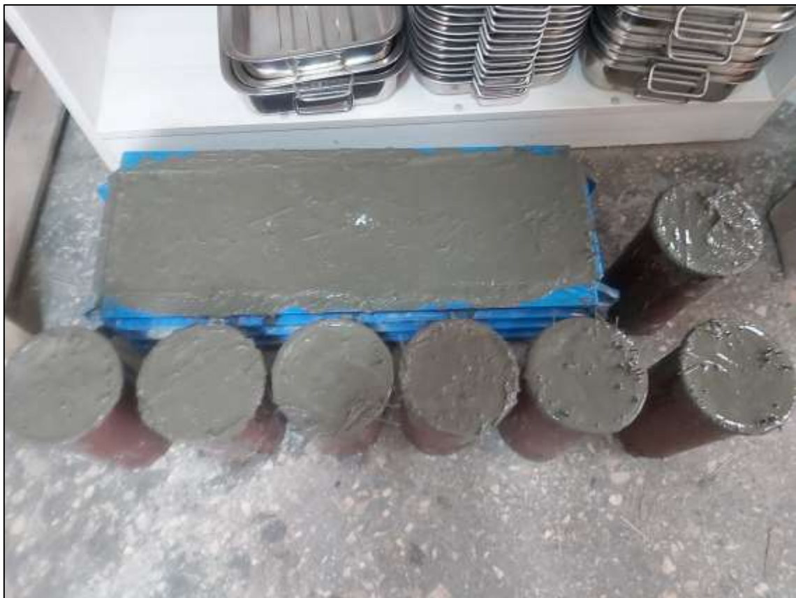
Figura 36. Muestreo de probetas de concreto con fibras híbridas en laboratorio.
