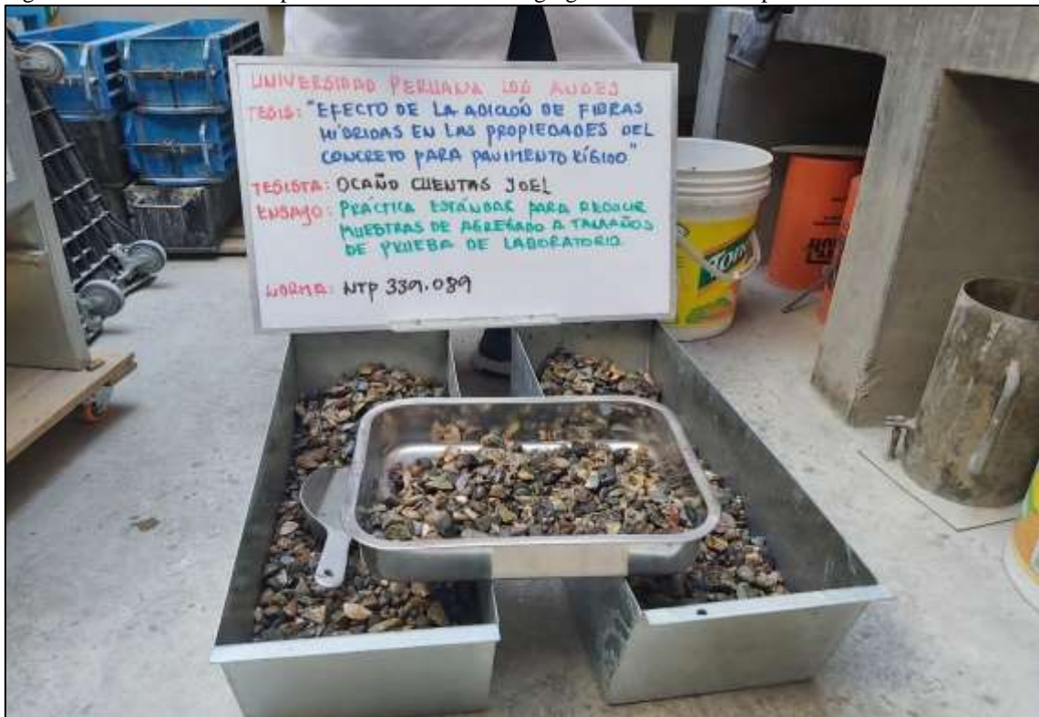
Figura 39. Practica estándar para reducir muestras de agregados a tamaños de prueba de laboratorio.
