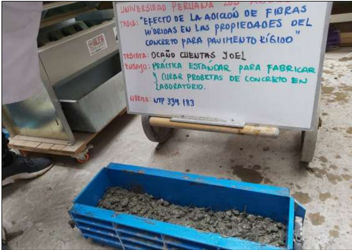
Figura 34. Muestreo de vigas de concreto con adición de fibras híbridas en laboratorio.
