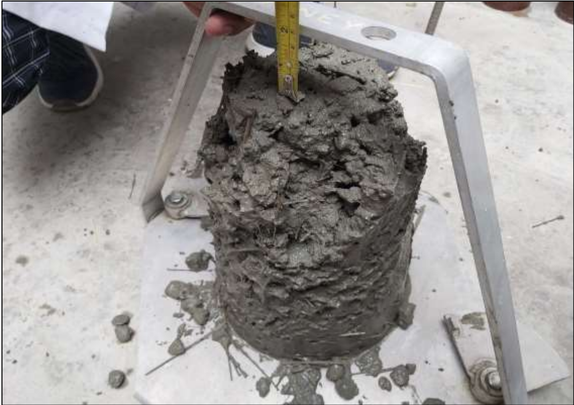
Figura 24. Ensayo de revenimiento de concreto con adición de fibras híbridas.
