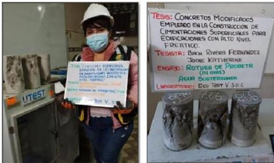
**Fotografía N° 14:** Tipo de falla del ensayo resistencia a la compresión 7, 17, 21, 28 días de edad.
