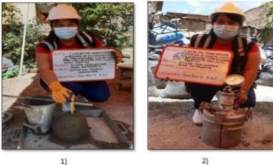
**Fotografía N° 6:** Prueba de propiedades del concreto en estado fresco
