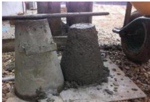
*Figura 5: Ensayo de “Slump” en el concreto en estado fresco*
