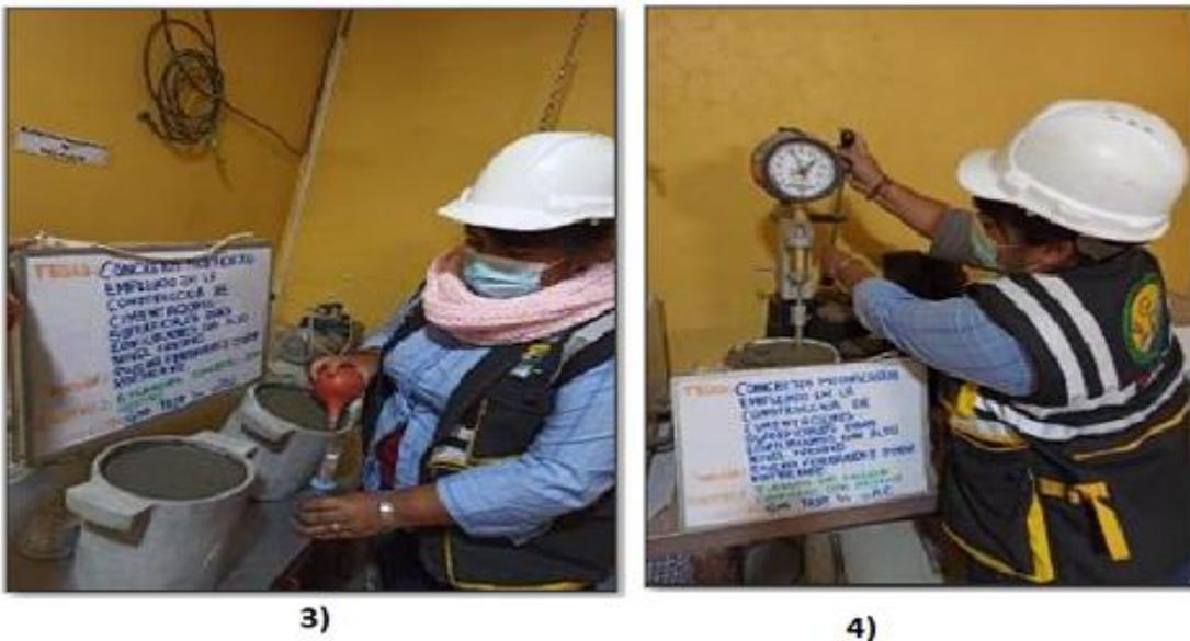
**Fotografía N° 10:** 1) asentamiento, 2) contenido de aire 3) exudación, 4) tiempo de fraguado
