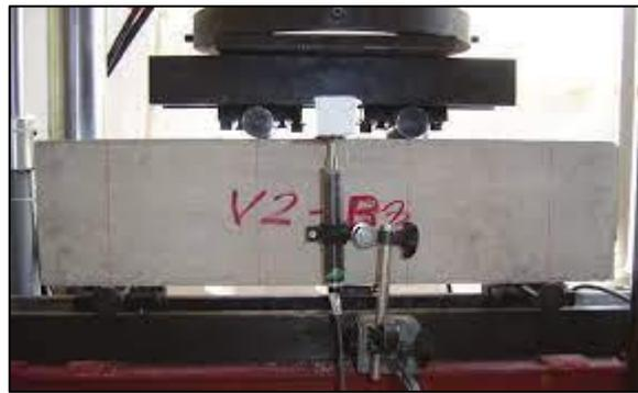
**Figura 21:** vigas simplemente apoyadas con cargas a los tercios del tramo
