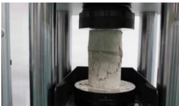
**Figura 6:** Testigo sometido al ensayo de resistencia a la compresión
