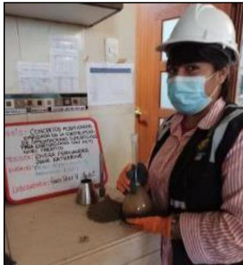
**Fotografía N° 2:** De acuerdo a la NTP 400.022. se desarrolló el ensayo normalizado del peso específico y absorción del agregado fino.
