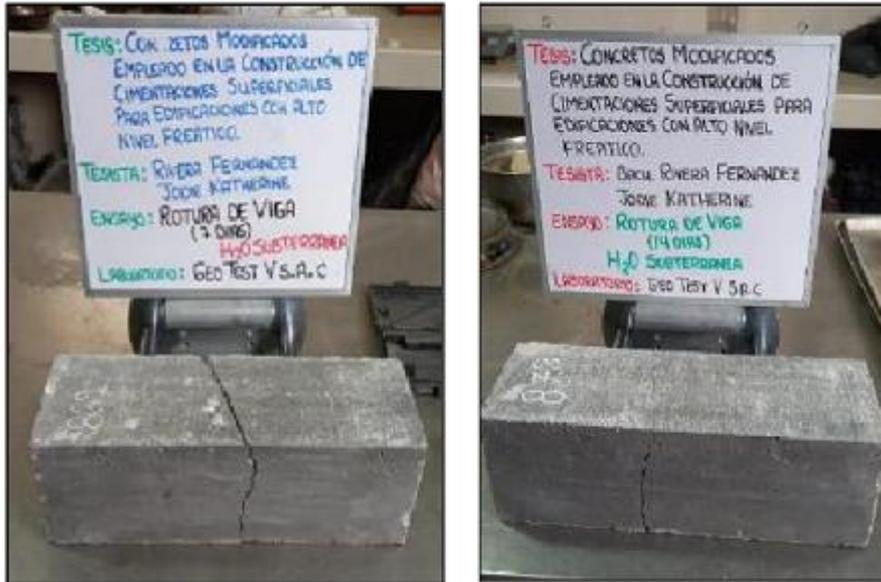
**Fotografía N° 17:** Mediciones de las caras fracturadas a los 7, 14, 28 días de edad.
