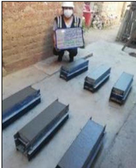
**Fotografía N° 12:** Elaboración de vigas de concreto convencional con agua subterránea y aditivo (Chema Aqua) Según NTP 339.183.
