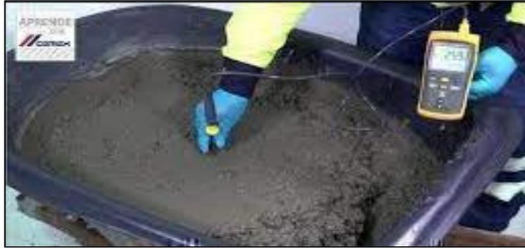
**Figura 18:** Medición de la temperatura de concreto fresco.
