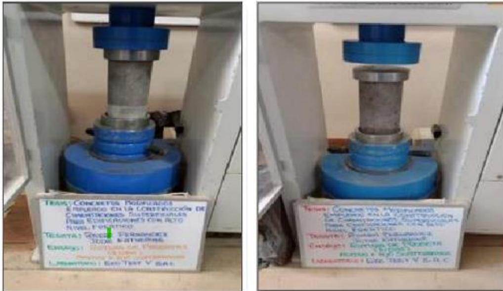
**Fotografía N° 15:** Resistencia a la compresión a los 7,14,21,28 días de edad
