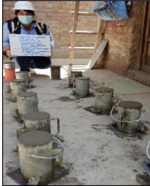
**Fotografía N° 11:** Elaboración de probetas de concreto convencional con agua subterránea y aditivo (Chema Aqua) Según NTP 339.183.
