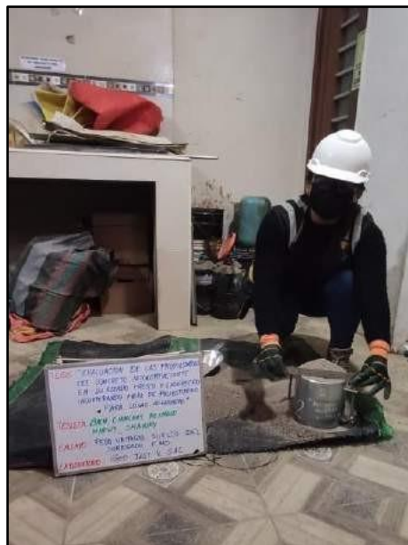
Fotografía N° 8: Prueba para calcular el PUS de los áridos finos
