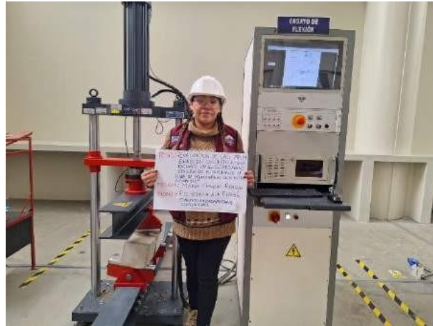
Fotografía N° 182: Ensayo de resistencia a la flexión a los 7 días en el concreto autocompactante convencional.
