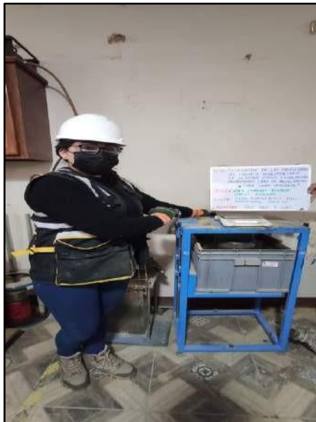
Fotografía N° 6: Prueba para el cálculo del peso sumergido dentro de la canastilla a una temperatura de agua de 23°C.
