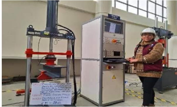
Fotografía N° 217: Ensayo del MR a los 28 días en el concreto, CC + 1% de fibra de poliestireno.
