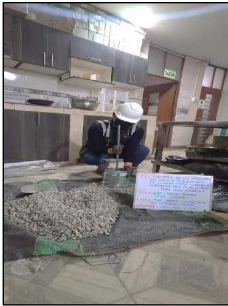
Fotografía N° 9: Prueba para el cálculo del PUC del agregado grueso.
