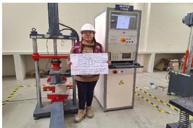
Fotografía N° 46: Ensayo de resistencia a la flexión a los 28 días en el concreto autocompactante convencional.
