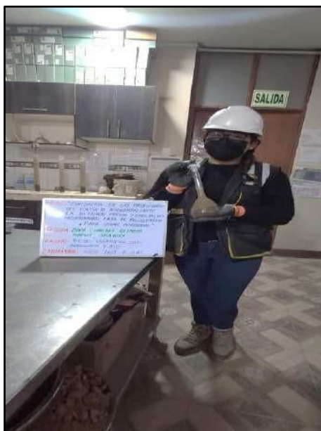
Fotografía N° 4: Fiola herramienta normalizado peso específico y absorción del agregado fino, según referencia de la norma NTP 400.022.
