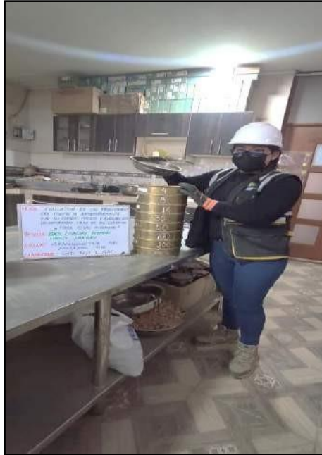
Fotografía N°1: Ensayo de análisis granulométrico del agregado fino, según referencia de la norma NTP 400.012.
