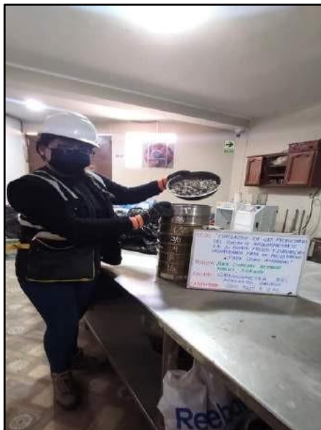
Fotografía N°2: Ensayo de granulometría del agregado grueso, según referencia de la norma NTP 400.012.
