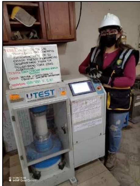
Fotografía N° 11: Evaluación Del f'c en testigos cilíndricos en un periodo de 7 días de edad del concreto convencional.
