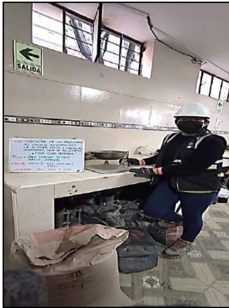
Fotografía N° 3: Ensayo con el molde cónico, metálico de 40\pm 3 mm de diámetro, y la varilla de apisonamiento de 340\pm 15 g, normalizado peso específico y absorción del agregado fino, según referencia de la norma NTP 400.022.
