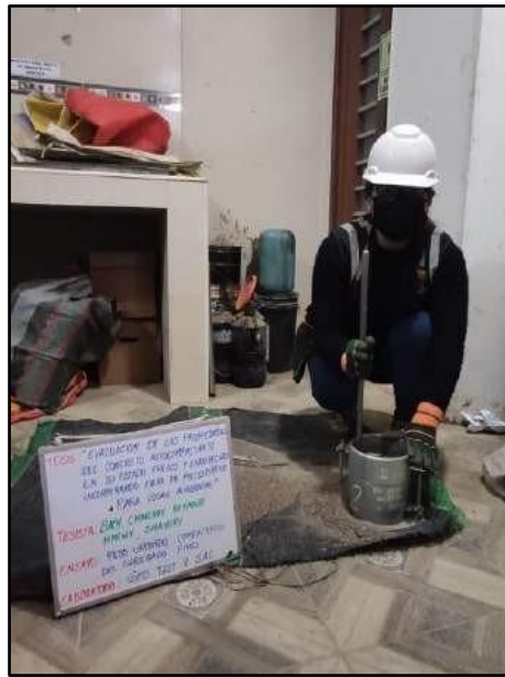
Fotografía N° 7: Prueba para el cálculo del PUC del árido fino
