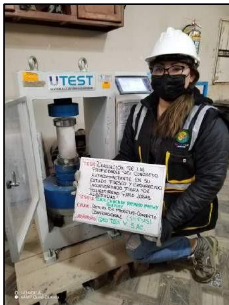
Fotografía N° 12: Evaluación Del f'c en testigos cilíndricos en un periodo de 14 días de edad del concreto convencional.
