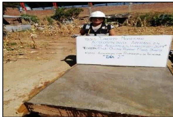
Fotografía N° 234: Segundo día de curado, esta debe ser realizado en un medio libre de vibraciones; según referencia de la NTP 339.183.
