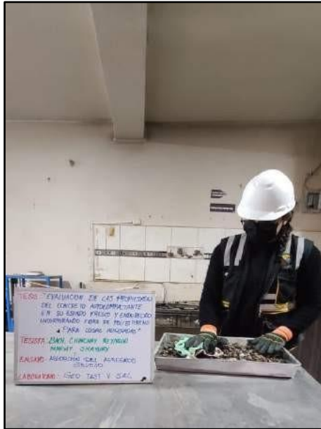
Fotografía N° 5: Prueba de cálculo de peso específico y absorción en áridos finos, NTP 400.022.
