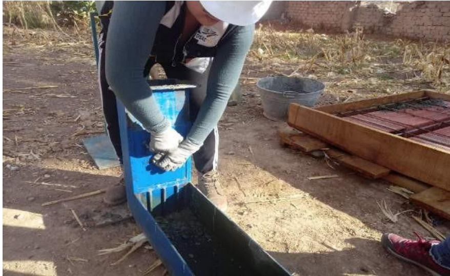
Fotografía N° 62: En imágenes de puede observar ensayo de caja en L de este modo se evalúa la consistencia del concreto
