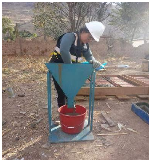
Fotografía N° 59. En imágenes se puede observar ejecutando el ensayo de embudo en V donde se determinó la capacidad de relleno (consistencia) del concreto.
