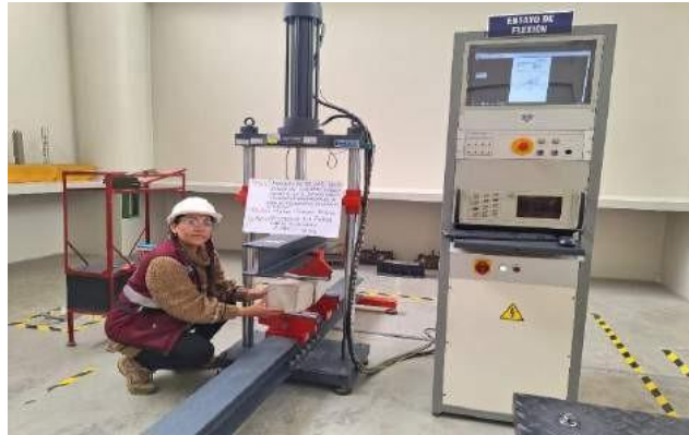
Fotografía N° 45: Prueba para el cálculo del MR a los 14 días en el concreto compactante convencional
