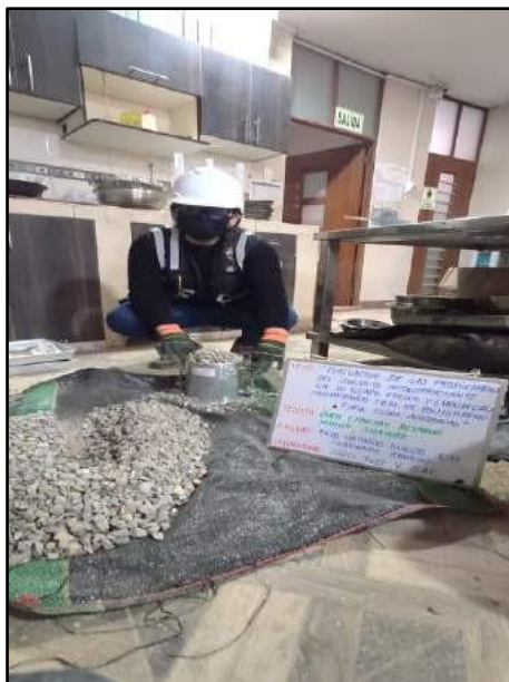
Fotografía N° 10: Prueba para el cálculo del PUS del agregado grueso.
