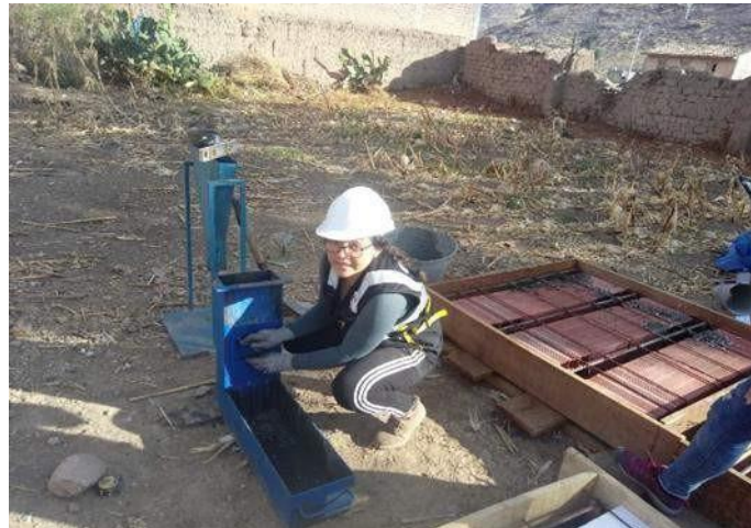
Fotografía N° 61: Realizando ensayo de caja en L de este modo se evalúa la consistencia del concreto
