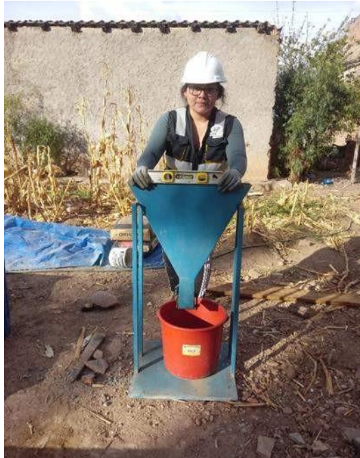
Fotografía N° 58: En imágenes observa el equipo para el método de ensayo Embudo V
