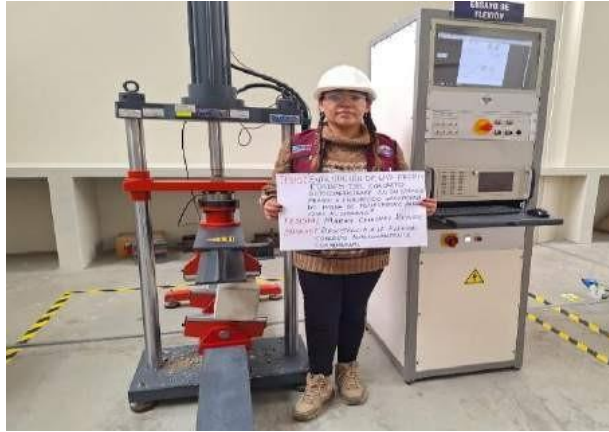
Fotografía N° 204: Ensayo para el cálculo del MR a los 14 días en el concreto, CC + 0.5% con fibra de poliestireno.
