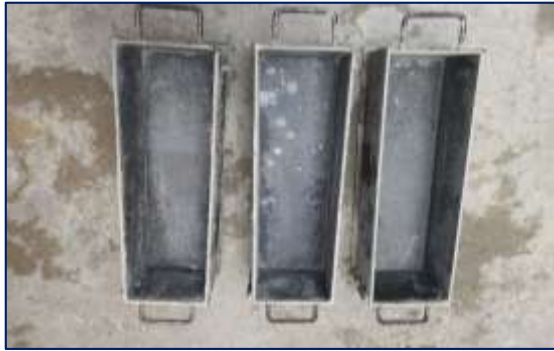
Fotografía 12. Vista de los moldes para la elaboración de las vigas de concreto.
