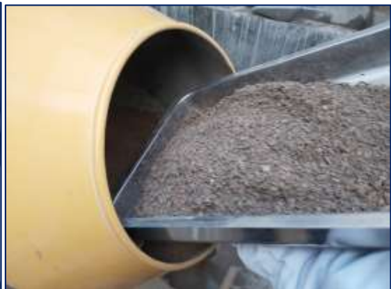
Fotografía 17. Vista de materiales para la elaboración del concreto con 20 % de escoria de piedra.
