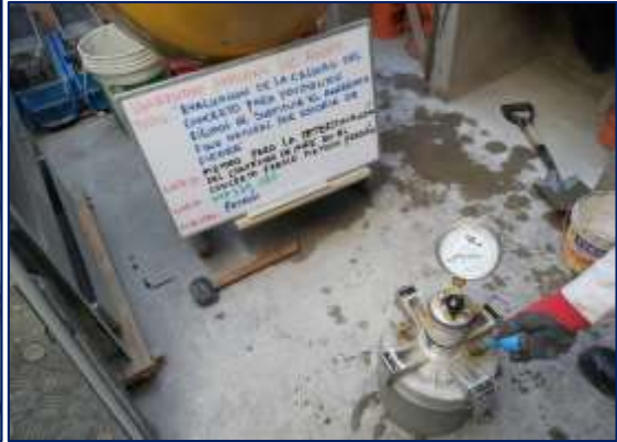
Fotografía 16. Vista de la medición del contenido de aire del concreto patrón.
