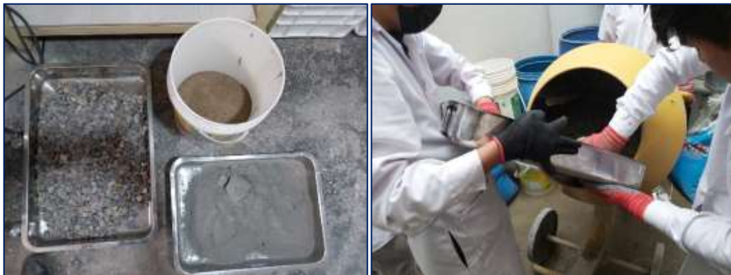
Fotografía 21. Vista de materiales para la elaboración del concreto con 60 % de escoria de piedra.
