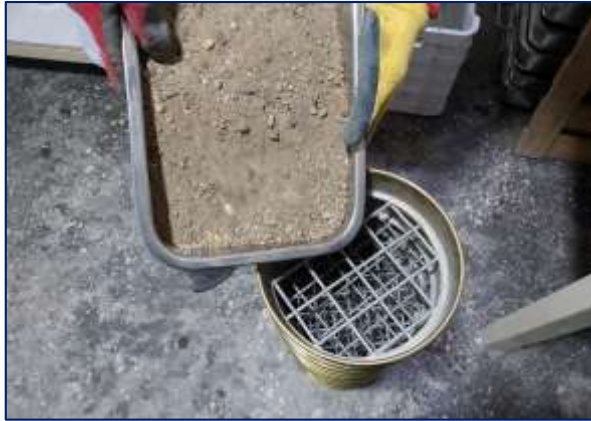
Fotografía 7. Análisis granulométrico del agregado fino.
