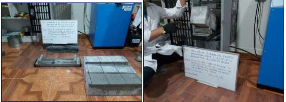
Fotografía 28. Medición de la resistencia a flexión a los 14 días del concreto patrón.
