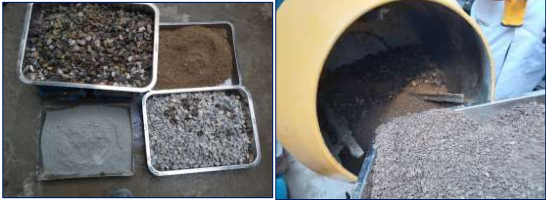
Fotografía 23. Vista de materiales y la elaboración del concreto con 80 % de escoria de piedra.
