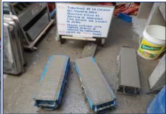
Fotografía 13. Vista de los materiales y la elaboración del concreto patrón sin sustitución del agregado fino por escoria de piedra.
