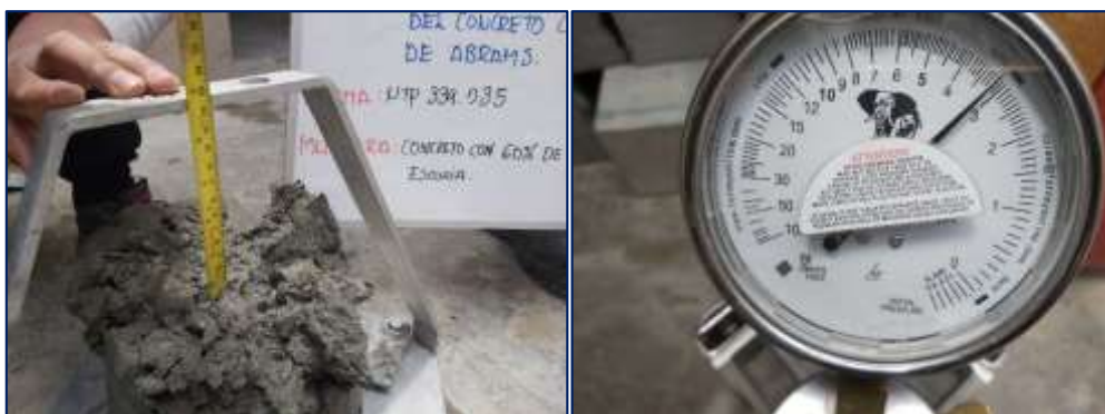
Fotografía 22. Medición del asentamiento y el contenido de aire del concreto con 60 % de escoria de piedra.
