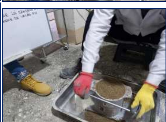
Fotografía 9. Determinación de la densidad en masa e índice de vacíos de los agregados.
