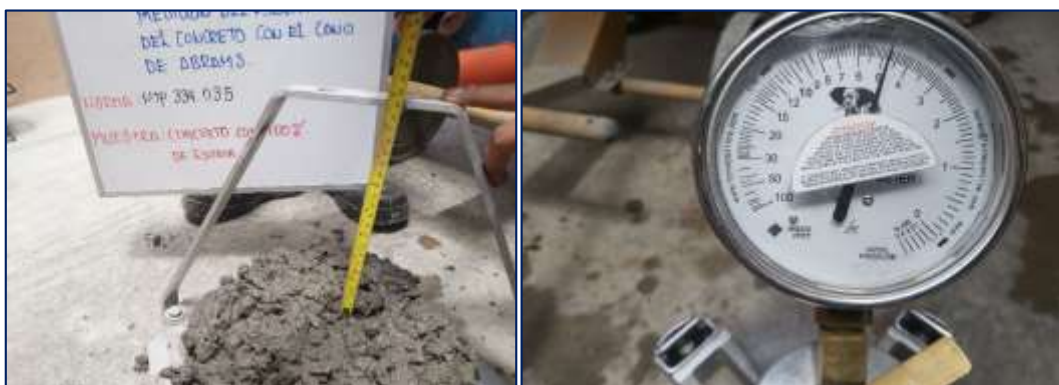
Fotografía 26. Medición del asentamiento y contenido de aire del concreto con 100 % de escoria de piedra.
