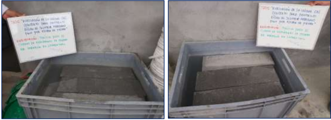
Fotografía 27. Vista del curado de vigas de concreto.
