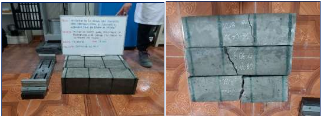
Fotografía 36. Medición de la resistencia a flexión a los 14 días del concreto con 80 % de escoria de piedra.
