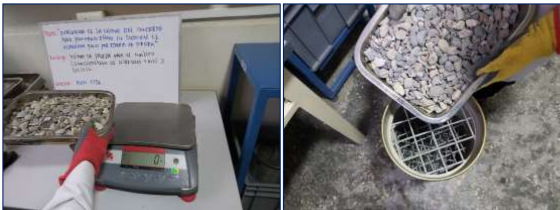
Fotografía 6. Pesado de muestra de agregado grueso y su correspondiente análisis granulométrico.
