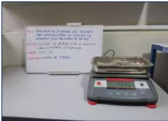
Fotografía 8. Pesado y análisis granulométrico de la escoria de piedra triturada.
