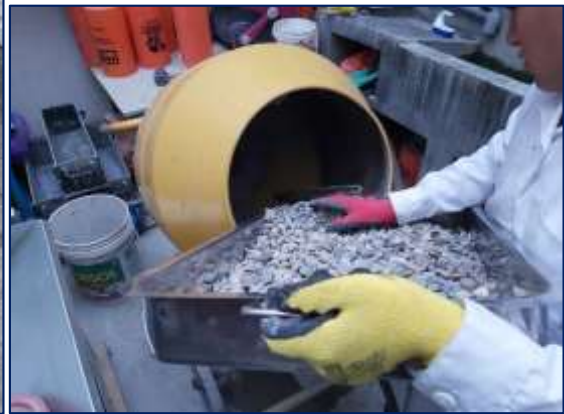
Fotografía 13. Vista de los materiales y la elaboración del concreto patrón sin sustitución del agregado fino por escoria de piedra.
