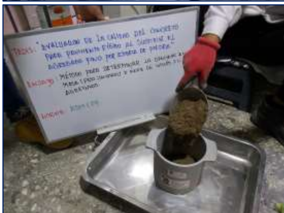
Fotografía 9. Determinación de la densidad en masa e índice de vacíos de los agregados.
