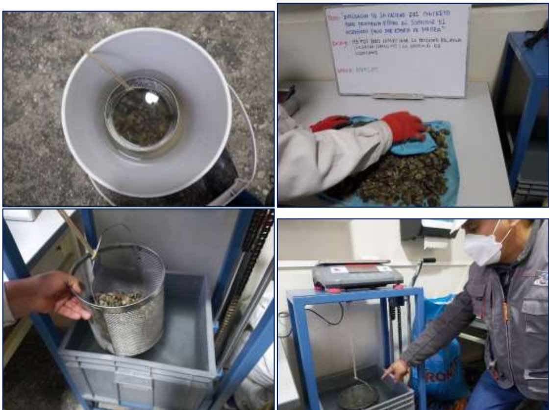
Fotografía 11. Medición de la densidad, densidad relativa y absorción de los agregados gruesos.
