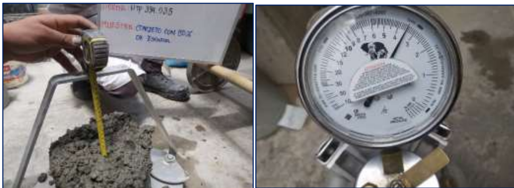
Fotografía 24. Medición del asentamiento y contenido de aire del concreto con 80 % de escoria de piedra.
