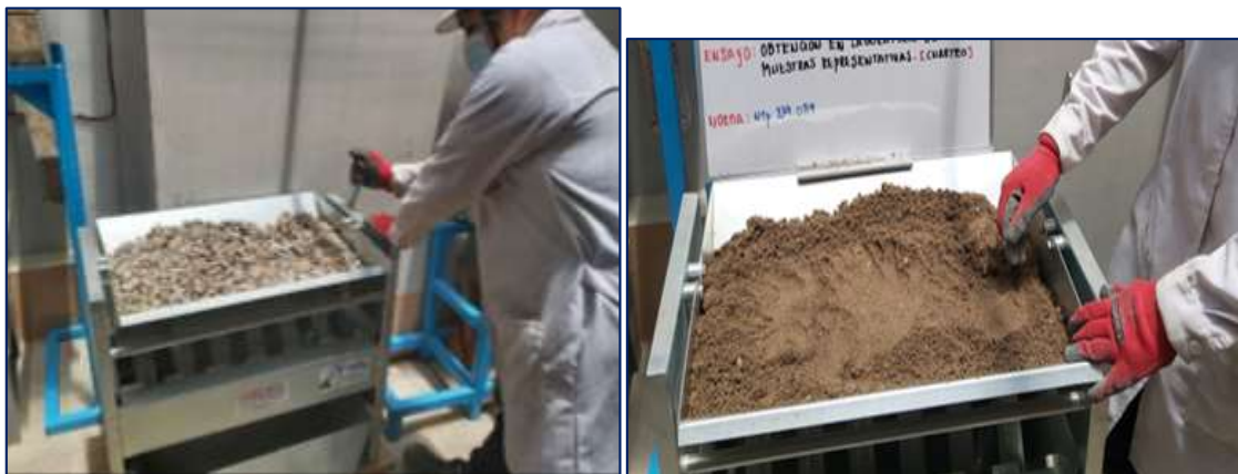
Fotografía 3. Cuarteo del agregado grueso y fino para la ejecución de ensayos.
