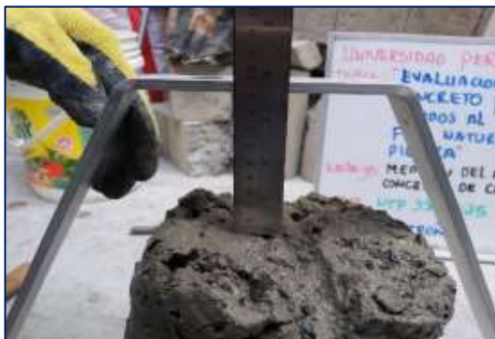
Fotografía 15. Medición del asentamiento del concreto patrón.
