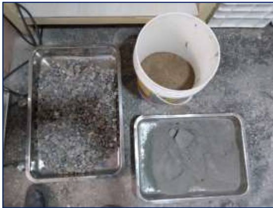
Fotografía 13. Vista de los materiales y la elaboración del concreto patrón sin sustitución del agregado fino por escoria de piedra.
