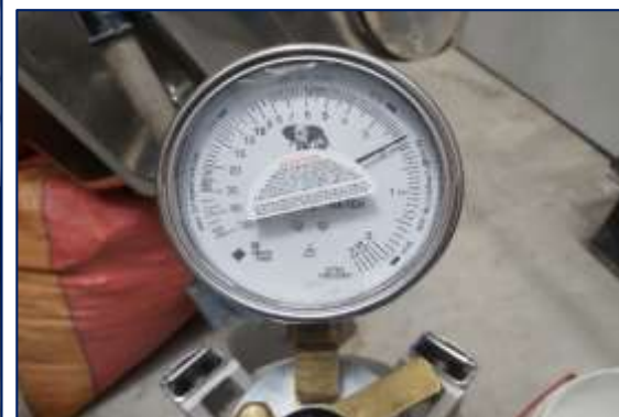
Fotografía 18. Medición del asentamiento y el contenido de aire del concreto con 20 % de escoria de piedra.
