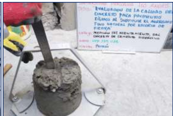
Fotografía 15. Medición del asentamiento del concreto patrón.
