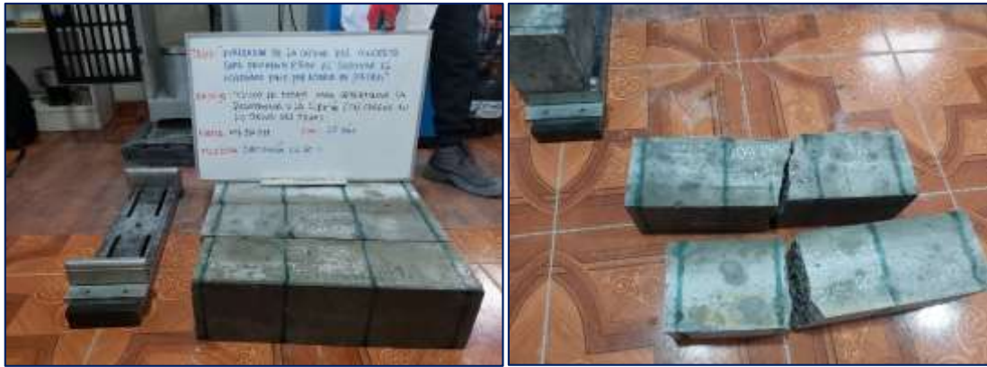
Fotografía 35. Medición de la resistencia a flexión a los 28 días del concreto con 60 % de escoria de piedra.
