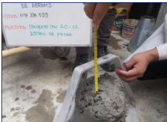
Fotografía 18. Medición del asentamiento y el contenido de aire del concreto con 20 % de escoria de piedra.
