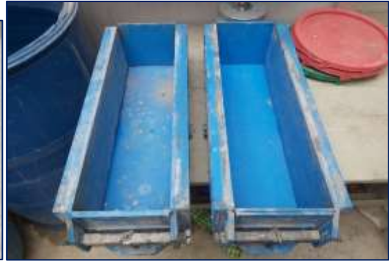
Fotografía 12. Vista de los moldes para la elaboración de las vigas de concreto.
