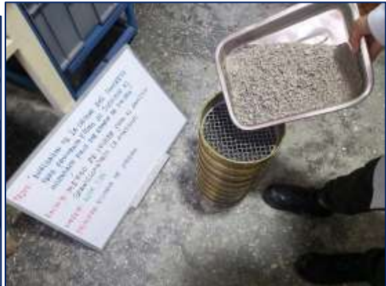
Fotografía 8. Pesado y análisis granulométrico de la escoria de piedra triturada.
