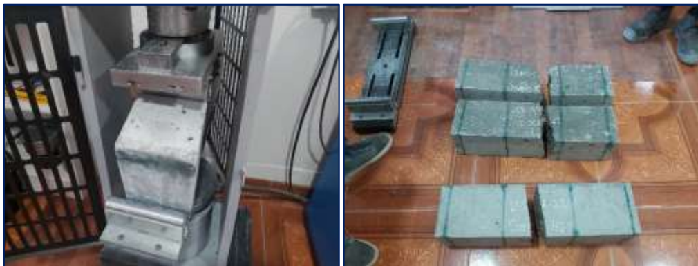
Fotografía 33. Medición de la resistencia a flexión a los 28 días del concreto con 40 % de escoria de piedra.
