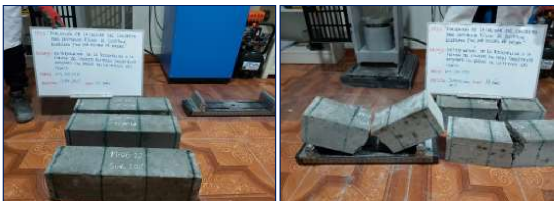
Fotografía 30. Medición de la resistencia a flexión a los 14 días del concreto con 20 % de escoria de piedra.
