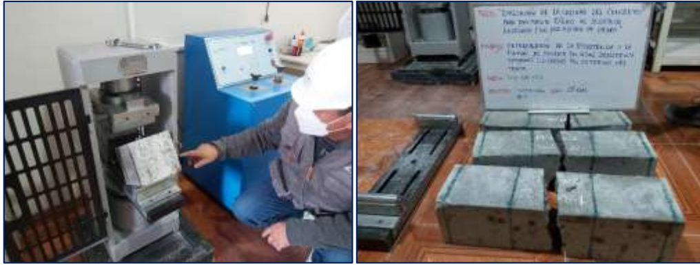
Fotografía 31. Medición de la resistencia a flexión a los 28 días del concreto con 20 % de escoria de piedra.
