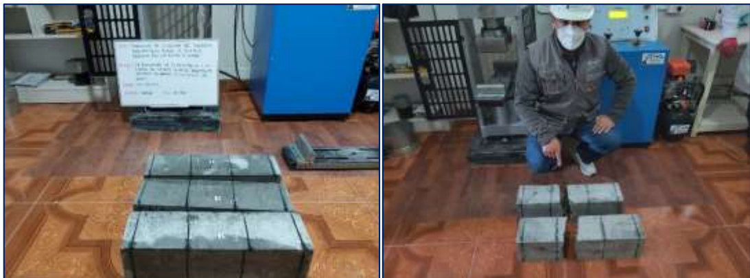
Fotografía 29. Medición de la resistencia a flexión a los 28 días del concreto patrón.
