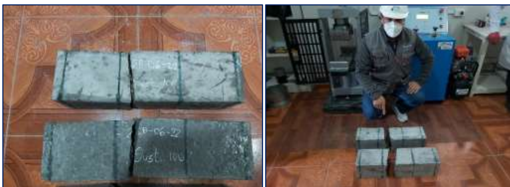
Fotografía 38. Medición de la resistencia a flexión a los 28 días del concreto con 100 % de escoria de piedra.
