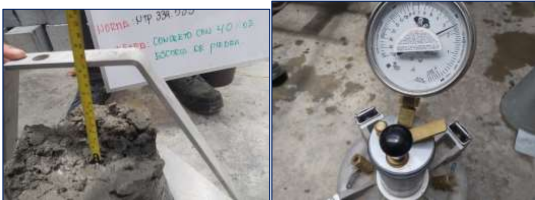
Fotografía 20. Medición del asentamiento y el contenido de aire del concreto con 40 % de escoria de piedra.
