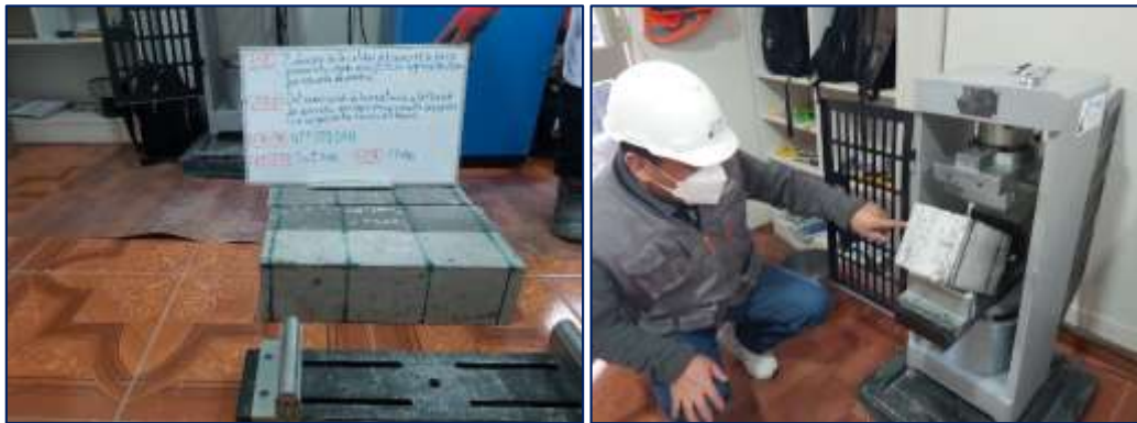
Fotografía 32. Medición de la resistencia a flexión a los 14 días del concreto con 40 % de escoria de piedra.
