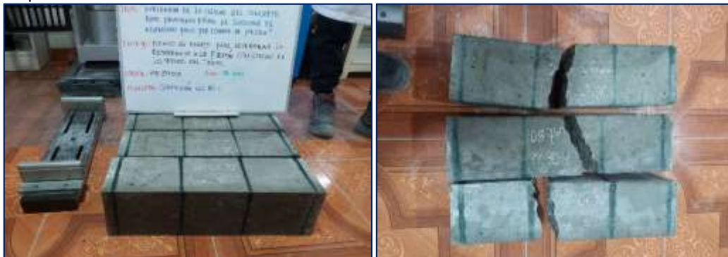
Fotografía 37. Medición de la resistencia a flexión a los 28 días del concreto con 80 % de escoria de piedra.
