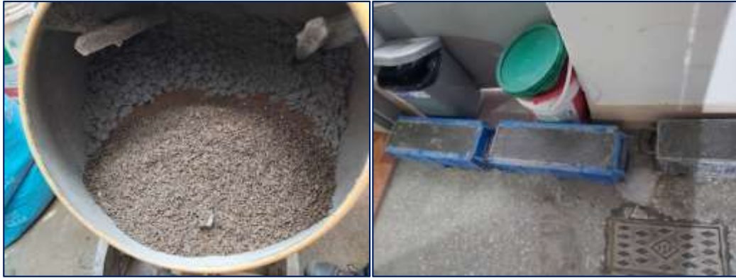
Fotografía 19. Vista de los materiales para el concreto con 40 % de escoria de piedra y vigas elaboradas.
