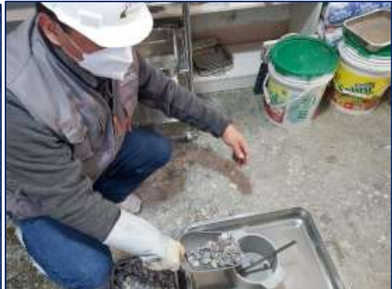
Fotografía 8. Pesado y análisis granulométrico de la escoria de piedra triturada.
