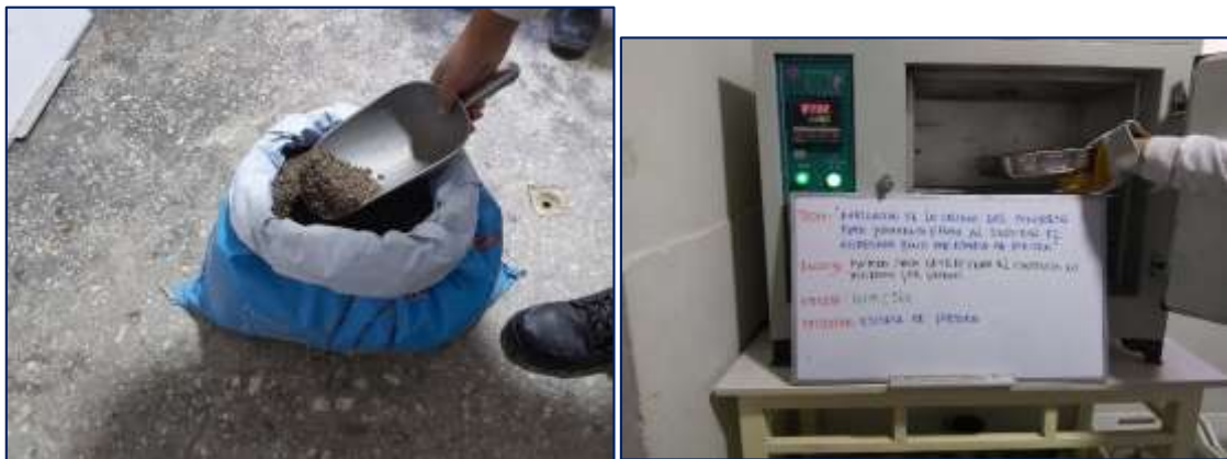
Fotografía 5. Vista de la escoria de piedra chancada y la determinación de su contenido de humedad.
