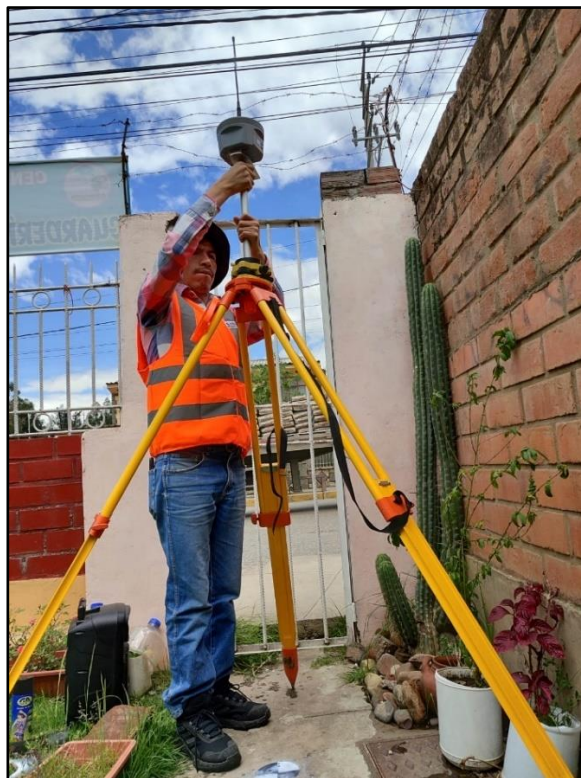
Figura 4.3. Instalación de GPS diferencial South.
