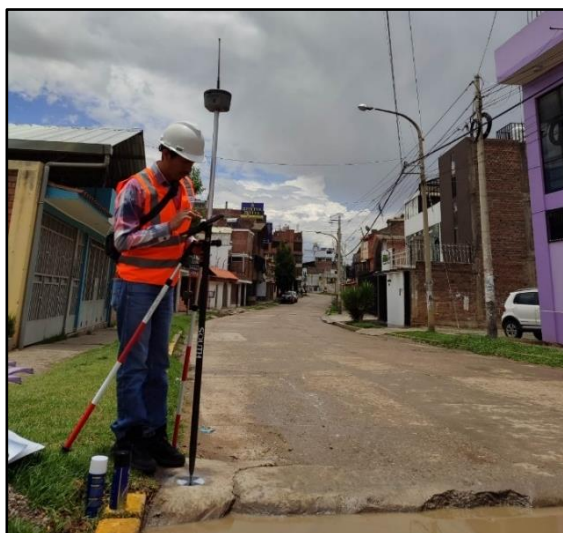
Figura 4.4. Lectura de puntos de control con GPS diferencial.
