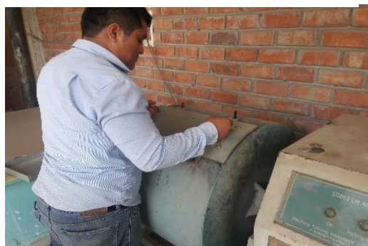
Figura N°24: Máquina de los ángeles.
