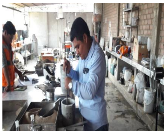
Figura N°21: Material fino compactado.
