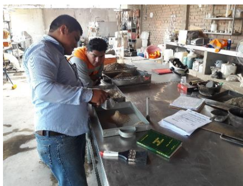
Figura N°16: Absorción del agregado fino
