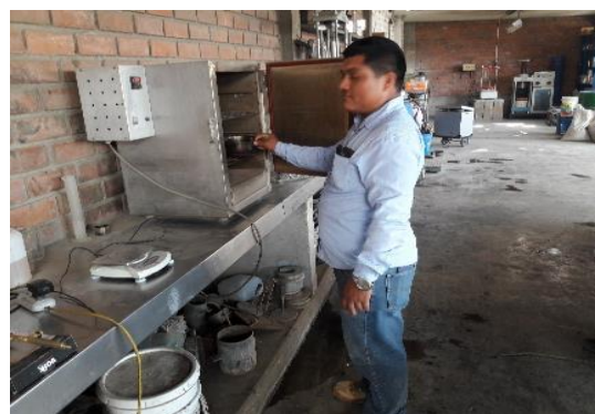
Figura N°17: Ingresando los materiales al horno.
