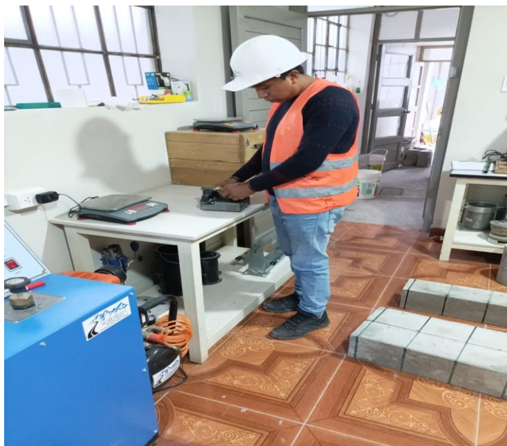
Fotografía N° 06: “Ensayo límite líquido, en la copa de casa grande en el laboratorio”
