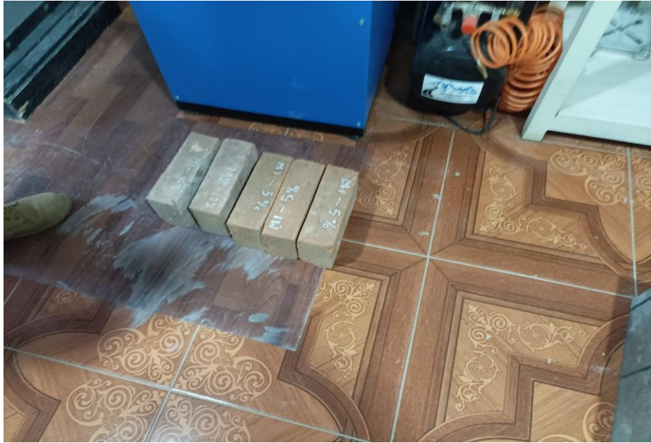
Fotografía N° 21: “Muestras de ladrillos de arcilla, con 5% de polietileno triturado”.
