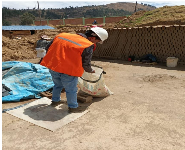
Fotografía N° 8: “Selección de polietileno triturado, para la elaboración del ladrillo de arcilla”.
