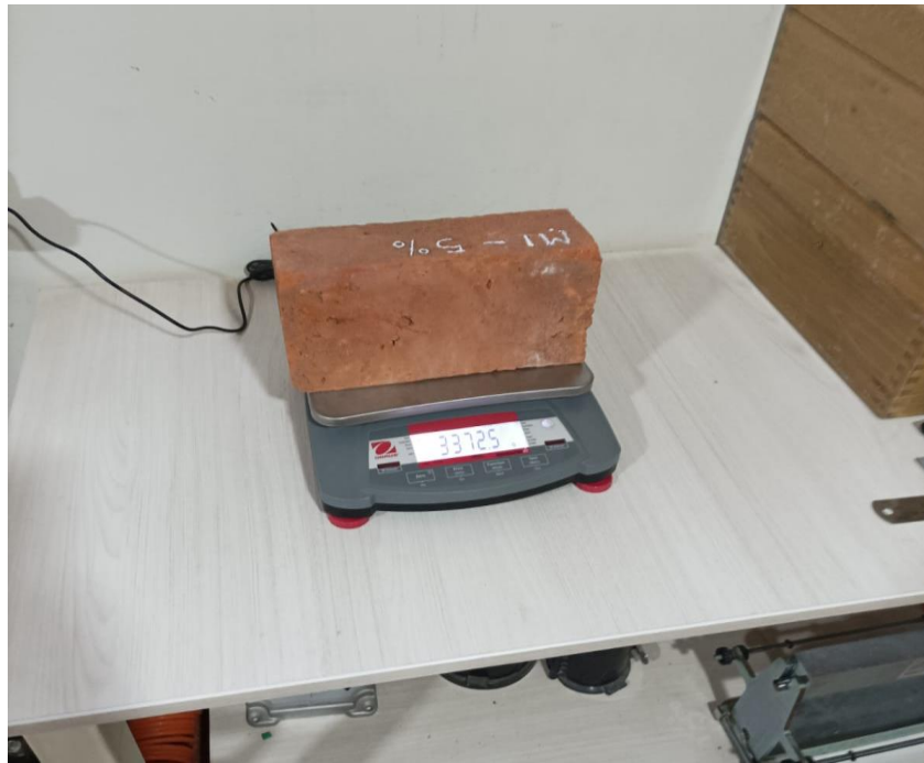
Fotografía N° 23: “Pesado de los ladrillos sometidos al ensayo de absorción, por 24 horas sumergidos en agua”.
