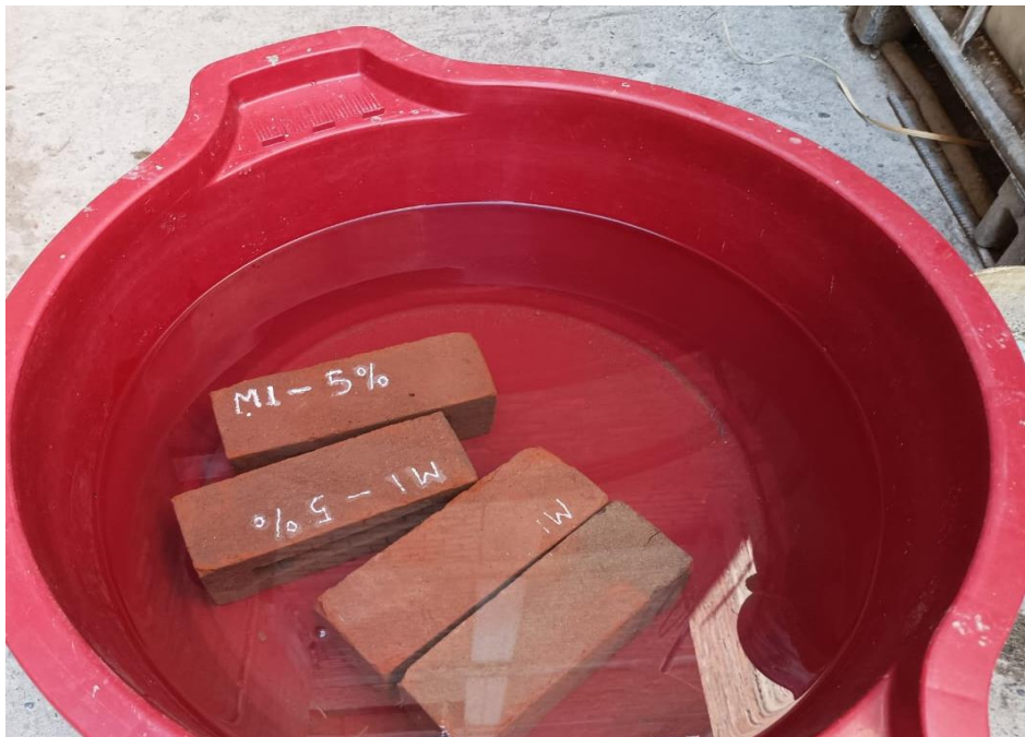
Fotografía N° 22: “Ensayo de Absorción durante, 24 horas”.
