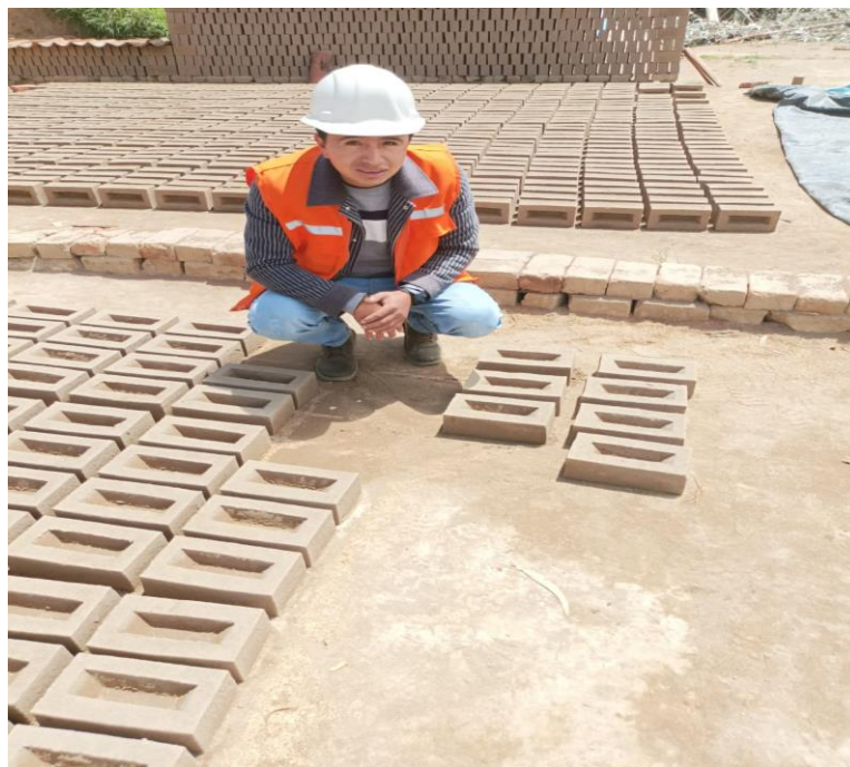
Fotografía N° 16: “Ladrillos de arcilla con 5%,10%,15%, 25%, 50% de polietileno”
