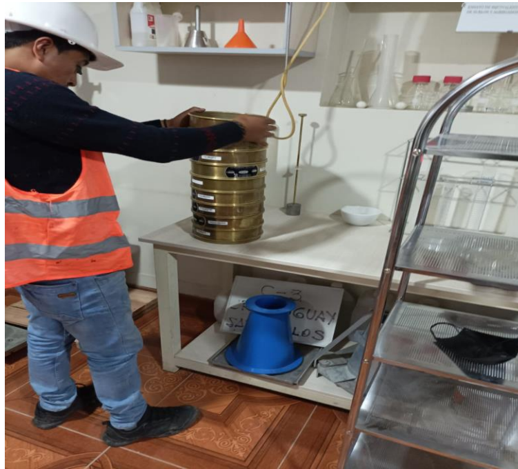
Fotografía N° 07: “Ensayo de tamizado en el laboratorio”
