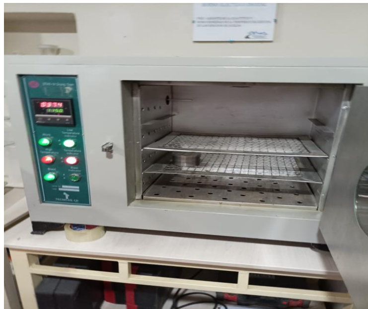
Fotografía N° 04: “Horno para el secado de las muestras en el horno, por 24 horas”.
