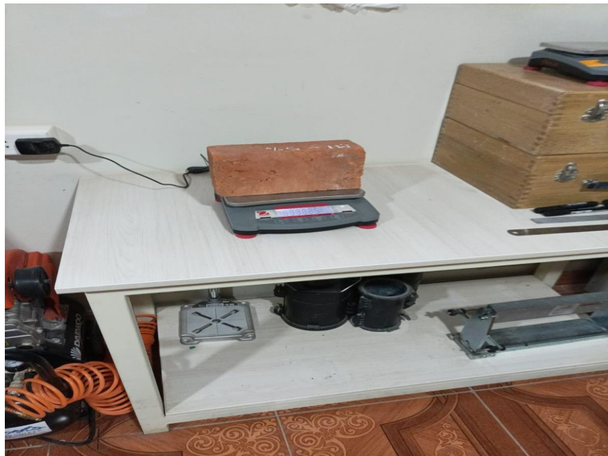
Fotografía N° 20: “Proceso de pesado de las muestras de los ladrillos de arcilla”.
