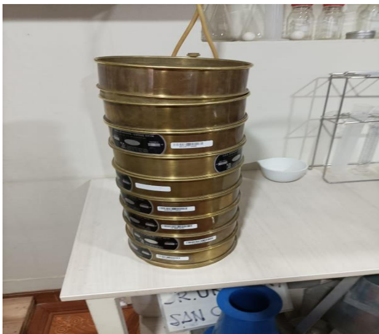
Fotografía N° 05: “Tamices para el ensayo de granulometría al polietileno triturado”.
