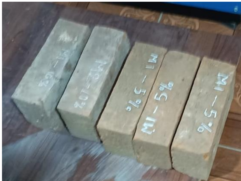
Fotografía N° 24: “Ladrillos sometidos al ensayo de absorción por 24 horas”.
