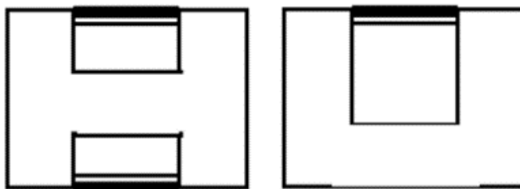
Figura 2.2: Rigidizadores para plantas irregulares
