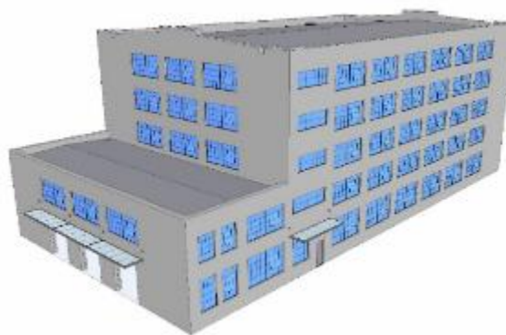
Figura 2.5: Irregularidad Geométrica Vertical
